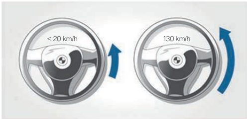
Direction Servotronic à assistance variable en fonction de la vitesse. Elle adapte de manière optimale l'effort au volant en fonction de la vitesse du véhicule et garantit une direction directe et précise à allure soutenue. En outre, le système Servotronic procure un net surcroît de confort en réduisant les interventions sur le volant ainsi qu'un maximum d'agilité lors des manœuvres de stationnement.
