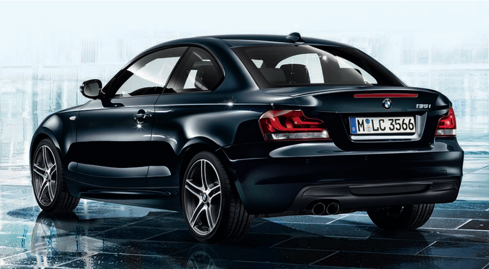
Jantes en alliage léger 18" (46 cm) style 208 M à rayons doubles avec monte pneumatique mixte RSC permettant le roulage à plat. Dimensions : 7,5 J x 18 à l'avant, pneumatiques 215/40 R 18 ; 8,5 J x 18 à l'arrière, pneumatiques 245/35 R 18. Disponibles en option, et exclusivement sur BMW 135i en Édition M Sport.
