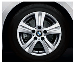
Jantes en alliage léger 16" (41 cm) style 222 à rayons doubles 1 . Dimensions : 7 J x 16, pneumatiques 205/55 R 16. De série sur BMW 118d, 120d et 120i, non disponibles sur BMW 125i, 123d et 135i.
