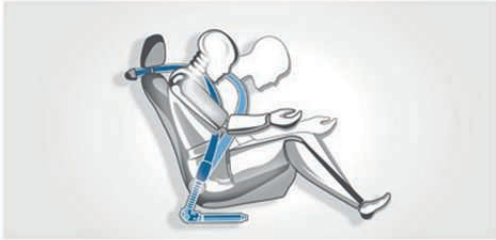
Système de retenue BMW pour le conducteur et le passager avant. Ce dispositif, constitué d'une ceinture de sécurité trois points, d'un pré-tensionneur pyrotechnique et d'un limiteur de tension assure une retenue optimale en cas de collision.
