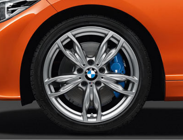
Jantes en alliage léger 18" (46 cm) style 436 M à rayons doubles. À l'avant : 7,5 J x 18, pneumatiques 225/40 R 18 ; à l'arrière : 8 J x 18, pneumatiques 245/35 R 18.
