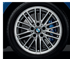
Jantes en alliage léger 17" (43 cm) style 460 M à rayons doubles , avec monte pneumatique mixte. Dimensions : 7,5 J x 17 à l'avant, pneumatiques 225/45 R 17 ; 8 J x 17, pneumatiques 245/40 R 17.
