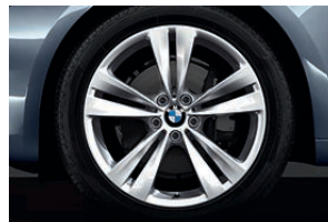
Jantes en alliage léger 20" (51 cm) style 316 à rayons doubles avec monte pneumatique mixte. Dimensions : 8,5 J x 20 à l'avant, pneumatiques 245/40 R 20 Y ; 10 J x 20 à l'arrière, pneumatiques 275/35 R 20 Y.
