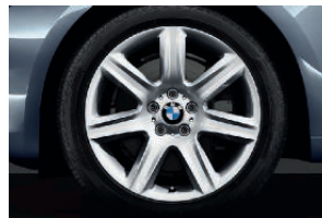
Jantes en alliage léger 19" (48 cm) style 272 à rayons en étoile avec monte pneumatique mixte. Dimensions : 8,5 J x 19 à l'avant, pneumatiques 245/45 R 19 Y ; 9,5 J x 19 à l'arrière, pneumatiques 275/40 R 19 Y. Série sur la BMW 550i xDrive.
