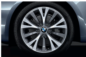
Jantes en alliage léger 19" (48 cm) style 315 à rayons en Y avec monte pneumatique mixte. Dimensions : 8,5 J x 19 à l'avant, pneumatiques 245/45 R 19 Y ; 9,5 J x 19 à l'arrière, pneumatiques 275/40 R 19 Y.
