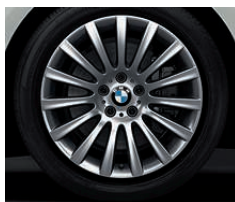
Jantes en alliage léger 19" (48 cm) style 235 à rayons multiples avec monte pneumatique mixte. Dimensions : 8,5 J x 19 à l'avant, pneumatiques 245/45 R 19 ; 9,5 J x 19 à l'arrière, pneumatiques 275/40 R 19.
