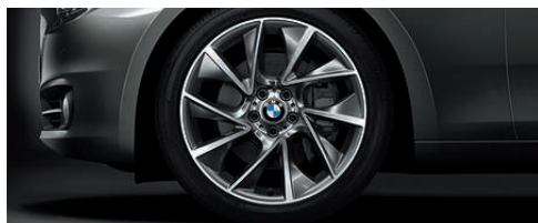
Jantes en alliage léger 20" (51 cm) style 457 turbine avec monte pneumatique mixte. Dimensions : 8,5 J x 20 à l'avant, pneumatiques 245/40 R 20 ; 10 J x 20 à l'arrière ; pneumatiques 275/35 R 20.
