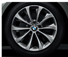
Jantes en alliage léger 19" (48 cm) style 452 turbine avec monte pneumatique mixte. Dimensions : 8,5 J x 19 à l'avant, pneumatiques 245/45 R 19 ; 9,5 J x 19 à l'arrière, pneumatiques 275/40 R 19.
