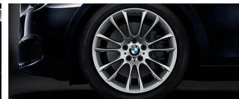
Jantes en alliage léger 19" (48 cm) style 302 M à rayons en V avec monte pneumatique mixte. Dimensions : 8,5 J x 19 à l'avant, pneumatiques 245/45 R 19 ; 9,5 J x 19 à l'arrière, pneumatiques 275/40 R 19. De série sur Finition M Sport.
