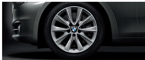
Jantes en alliage léger 18" (46 cm) style 425 à rayons en V. Dimensions : 8 J x 18, pneumatiques 245/50 R 18.
