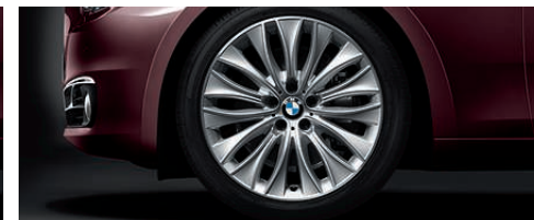
Jantes en alliage léger 20" (51 cm) style 459 à rayons multiples avec monte pneumatique mixte. Dimensions : 8,5 J x 20 à l'avant, pneumatiques 245/40 R 20 ; 10 J x 20 à l'arrière, pneumatiques 275/35 R 20.
