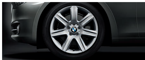
Jantes en alliage léger 19" (48 cm) style 272 à rayons en étoile avec monte pneumatique mixte. Dimensions : 8,5 J x 19 à l'avant, pneumatiques 245/45 R 19 ; 9,5 J x 19 à l'arrière, pneumatiques 275/40 R 19.
