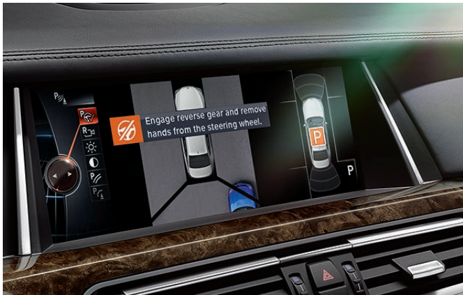
« Surround View » et système d'aide au stationnement intelligent « Park Assist ».
