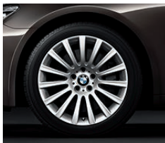
Jantes en alliage léger 19" (48 cm) style 235 à rayons multiples avec monte pneumatique mixte. Dimensions : 8,5 J x 19 à l'avant, pneumatiques 245/45 R 19 Y, 9,5 J x 19 à l'arrière, pneumatiques 275/40 R 19 Y (de série sur BMW 760i/Li). Disponible également sous forme de jeu de roues complètes hiver comme Accessoire d'Origine BMW.
