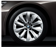
Jantes en alliage léger 19" (48 cm) style 357 Aero avec monte pneumatique mixte. Dimensions : 8,5 J x 19 à l'avant, pneumatiques 245/45 R 19 Y, 9,5 J x 19 à l'arrière, pneumatiques 275/40 R 19 Y.
