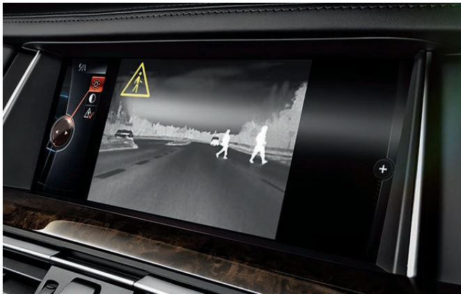
Système de vision nocturne BMW « Night Vision » avec détection des piétons et spots lumineux « Dynamic Light Spots ».
