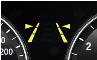
Avertisseur de franchissement de ligne avec avertisseur de risque de collision.
