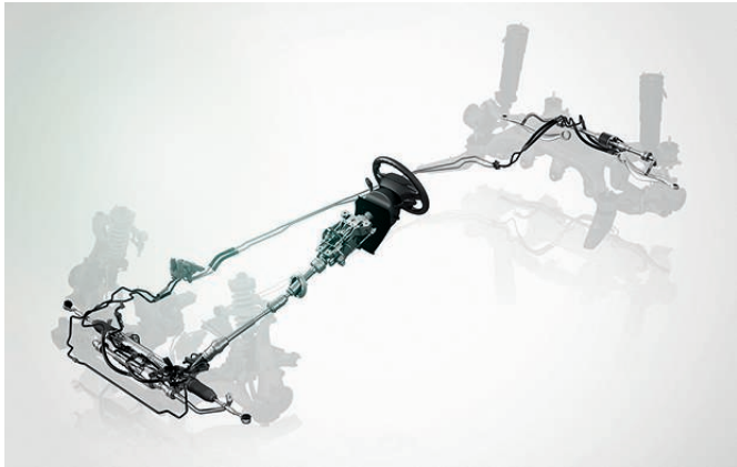
Direction Active Intégrale à 4 roues directrices.
