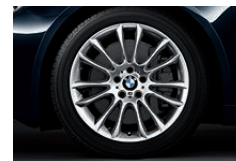
■ Jantes en alliage léger 19" (48 cm) style 302 M à rayons en V avec monte pneumatique mixte. AV/AR 8,5 / 9,5 J x 19, pneumatiques AV/AR 245/45 / 275/40 R 19.
