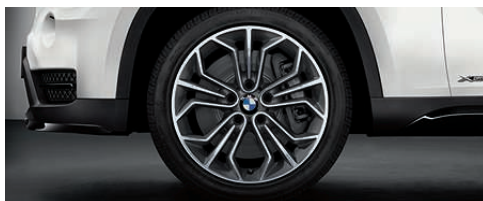
Jantes en alliage léger 18" (46 cm) style 323 à rayons en W , bicolores avec monte pneumatique mixte RSC permettant le roulage à plat. Dimensions : 8 J X 18 à l'avant, pneumatiques 225/45 R 18 ; 9 J X 18 à l'arrière, pneumatiques 255/40 R 18 (indisponible sur la BMW X1 sDrive20d EfficientDynamics Edition).
