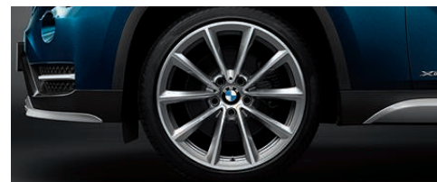
Jantes en alliage léger 19" (48 cm) style 324 à rayons en V , avec monte pneumatique mixte RSC permettant le roulage à plat. Dimensions : 8 J X 19 à l'avant, pneumatiques 225/40 R 19 ; 9 J X 19 à l'arrière, pneumatiques 255/35 R 19 (indisponible sur la BMW X1 sDrive20d EfficientDynamics Edition).
