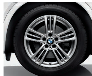
Jantes en alliage léger 18" (46 cm) style 368 M à rayons en étoile. Dimensions : 8 J x 18, pneumatiques RSC permettant le roulage à plat 245/50 R 18.
