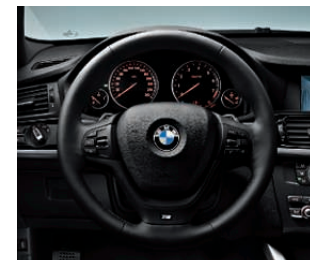
Le volant M gainé cuir avec touches multifonctions et palettes de changement de rapport (disponibles uniquement sur la BMW X3 xDrive35i) offre une excellente prise en main grâce à sa couronne épaisse. En combinaison avec une boîte de vitesses manuelle, le levier de vitesses est raccourci et arbore un emblème M. L'habillage du volant et le soufflet de levier de vitesses sont réalisés en cuir Walknappa.
