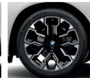
Jantes en alliage léger 20" style 1036M Bicolores Av : 9 J x 20 / pneus 255/45 R 20 Ar : 10,5 J / 20 / pneus 285/40 R 20
