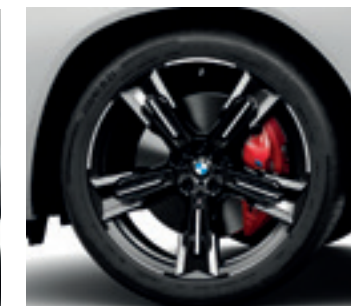
Jantes en alliage léger 21" style 1037M Jetblack Av : 9 J x 21 / pneus 255/40 R 21 Ar : 10,5 J x 21 / pneus 285/35 R 21
