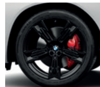
Jantes en alliage léger 21" style 1037M Frozen Jetblack Av : 9 J x 21 / pneus 255/40 R 21 Ar : 10,5 J x 21 / pneus 285/35 R 21
