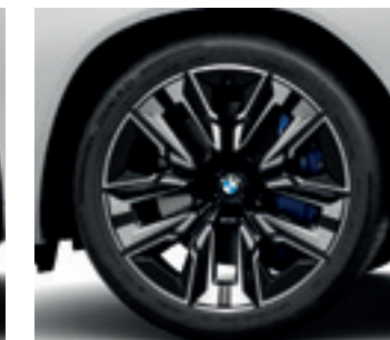
Jantes en alliage léger 21" BMW Individual aérodynamiques style 910i Bicolores Av : 9 J x 21 / pneus 255/40 R 21 Ar : 10,5 J x 21 / pneus 285/35 R 21
