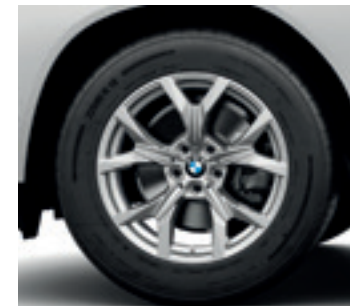
Jantes en alliage léger 18" style 921 à rayons simples 8 J x 18 / pneus 225/60 R 18
