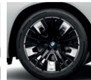
Jantes en alliage léger 20" aérodynamiques style 906M Bicolores Av : 9 J x 20 / pneus 255/45 R 20 Ar : 10,5 J / 20 / pneus 285/40 R 20
