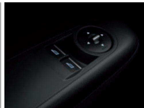
Lève-vitres électriques conducteur et passager avant avec ouverture/fermeture à impulsion (De série)
