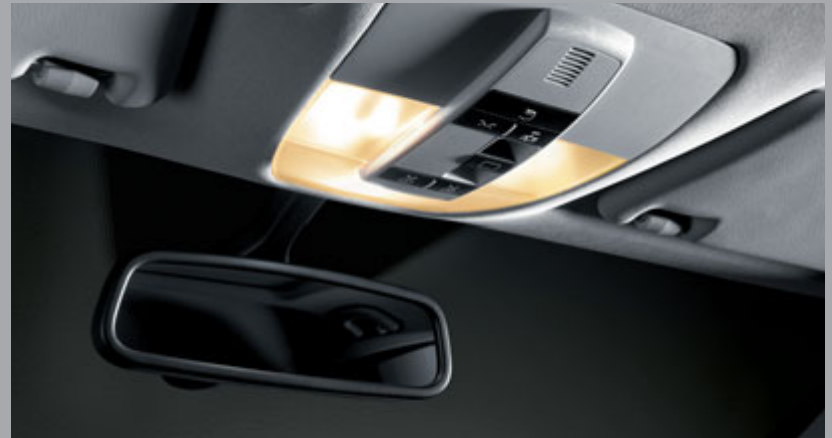
Le rétroviseur à commutation jour / nuit automatique avec détecteur de pluie (série).
