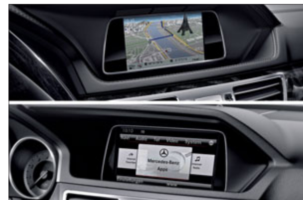
SPLITVIEW affiche simultanément des images différentes pour le conducteur et le passager avant sur le même écran.
