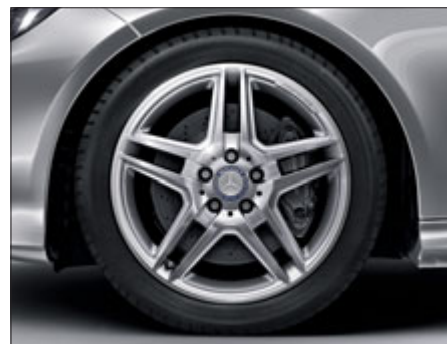
Jante alliage AMG à 5 doubles branches avec pneus 245/40 R 18 à l'avant et 265/35 R 18 à l'arrière, 245/40 R 18 à l'avant et à l'arrière sur 4MATIC (option, code 795/791).
