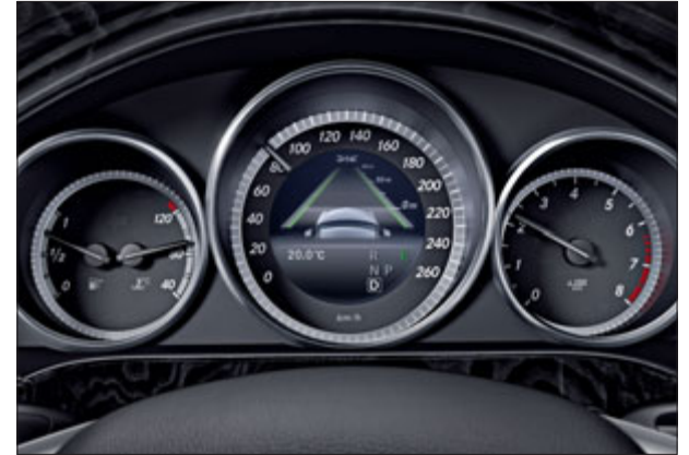
Combiné d'instruments à cadrans tubulaires et instruments ronds.
