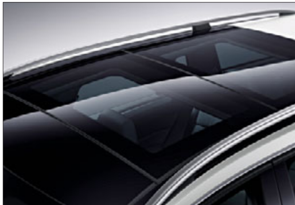
Toit ouvrant panoramique à commande électrique.
