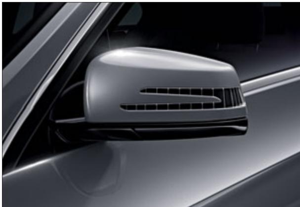
Rétroviseurs extérieurs chauffants à réglage électrique depuis l'intérieur.
