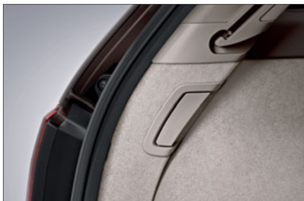
La poignée de déverrouillage permet de rabattre les dossiers arrière en un tournemain.
