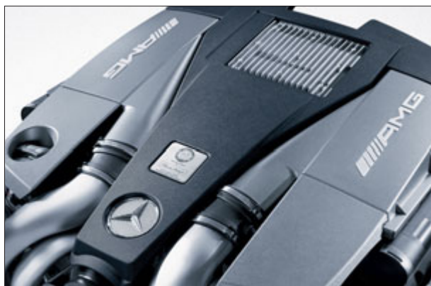
Une technique éprouvée : le V8 AMG de 5,5 l à suralimentation biturbo.
