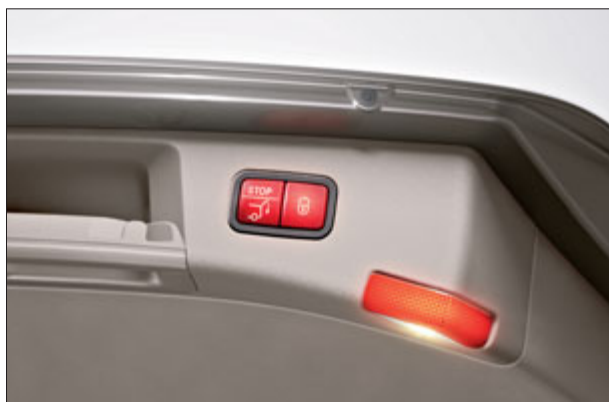
Le hayon EASY-PACK s'ouvre et se ferme par simple pression sur une touche, et peut être maintenu en position basse.
