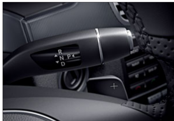
Levier sélecteur DIRECT SELECT (en liaison avec 7G-TRONIC PLUS).
