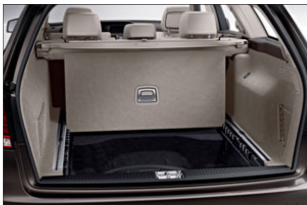
Le plancher de chargement rabattable EASY-PACK s'ouvre par paliers.
