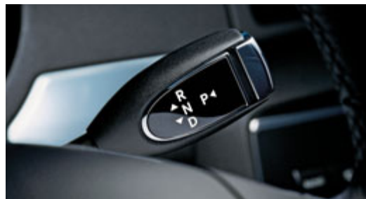
DIRECT SELECT Une pression sur le levier suffit pour sélectionner un mode.
