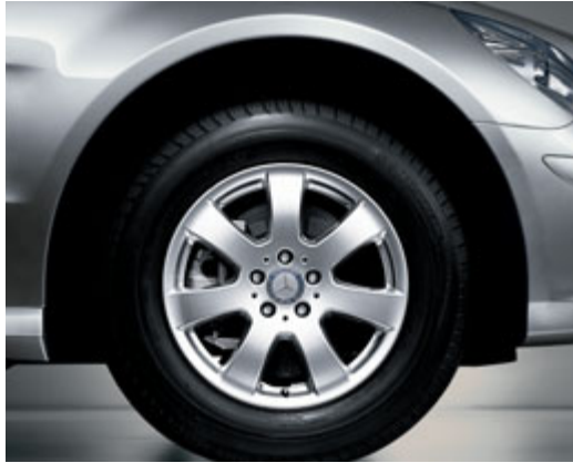
Jante alliage 17 pouces design 7 branches avec pneus 235/65 R 17 (non disponible en France).
