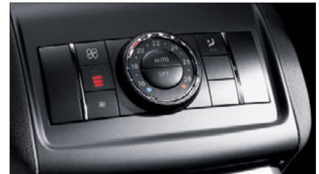
L'unité de commande présente à l'arrière permet de programmer avec précision la température et le débit d'air.
