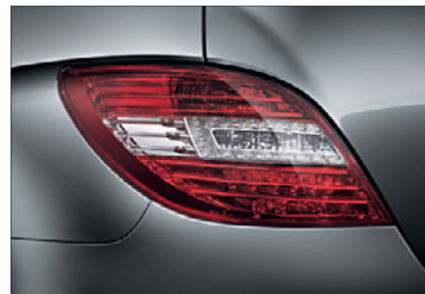
Feux arrière à technologie LED et fibre optique.
