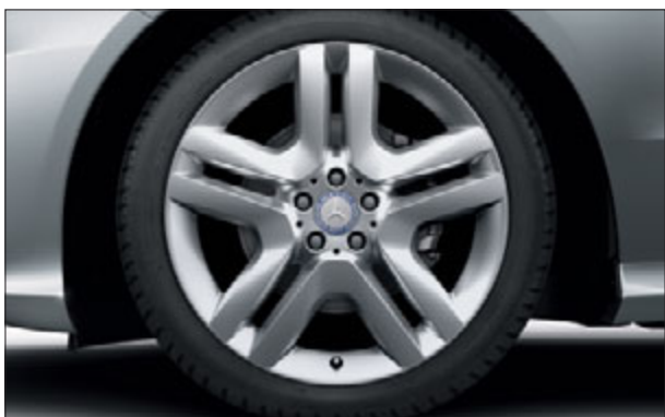
Jante alliage à 5 doubles branches avec pneus 265/45 R 20 (option) (code 41R).
