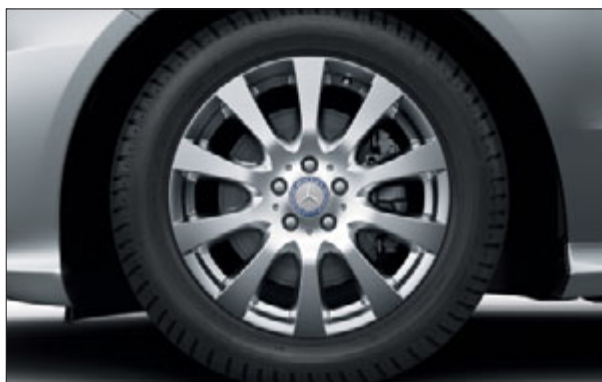
Jante alliage à 10 branches avec pneus 255/55 R 18 (de série sur R 300 CDI BlueEFFICIENCY, R 350 CDI 4MATIC, R 350 BlueTEC 4MATIC et R 350 4MATIC BlueEFFICIENCY) (code R41).
