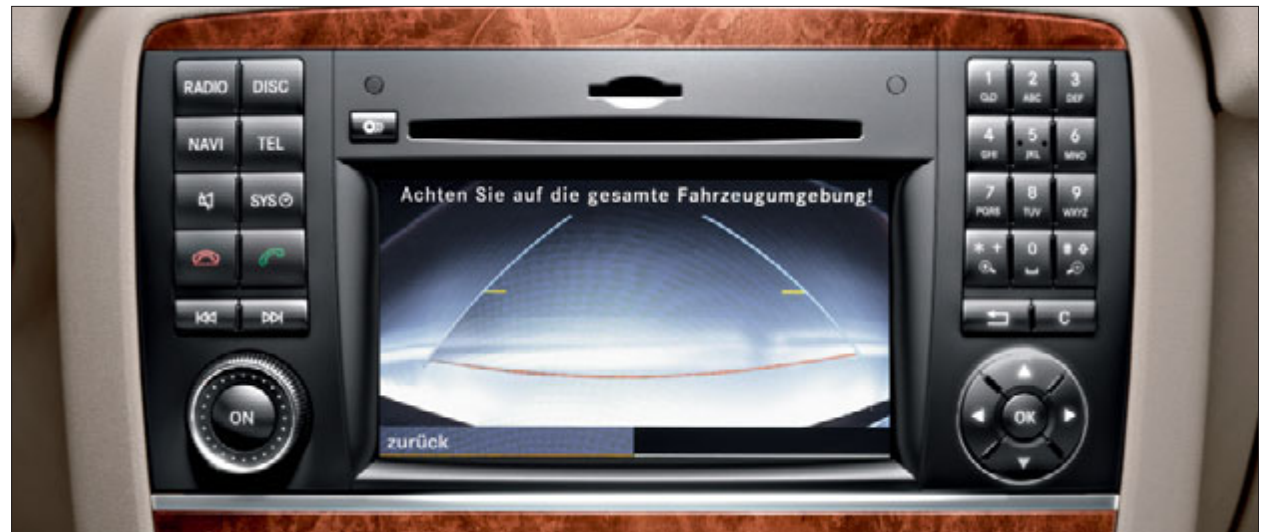
La caméra de recul filme la partie arrière du véhicule.
