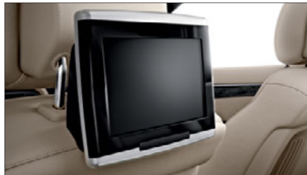
Les deux écrans du système de divertissement arrière sont logés dans les appuie-tête avant.
