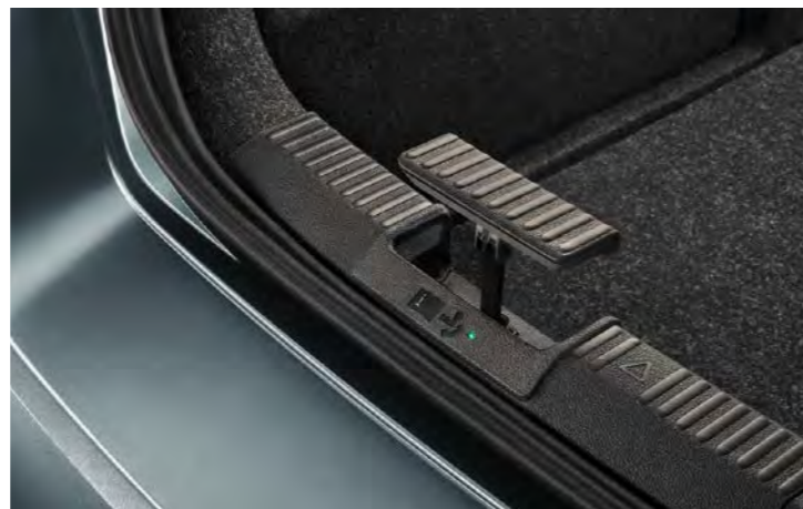
Le levier pour escamoter le bouton du dispositif d'attelage
