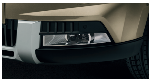
Projecteurs antibrouillard avec fonction "Corner Lights".
