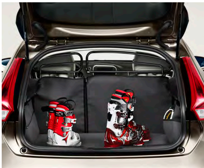
Grille de séparation coffre/habitacle en Acier et protection intégrale de coffre.
