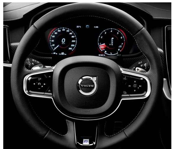
Volant R-Design gainé de Cuir Nappa perforé avec palettes de passage de rapports au volant (en option) et combiné d'instruments digital 12,3" offrant quatre modes d'affichage.
