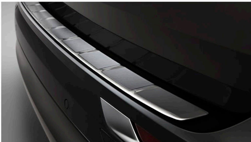
Protection de seuil de coffre.
