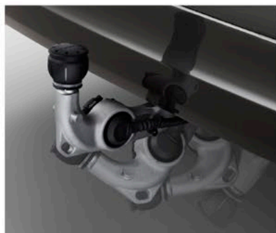
Crochet d'attelage amovible semi-électrique avec faisceau 13 broches.
