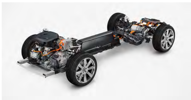
L'emplacement de la batterie permet à votre Volvo d'avoir un centre de gravité bas, de sorte qu'elle reste stable, sûre et confortable sans empiéter sur l'espace de rangement de la voiture.
