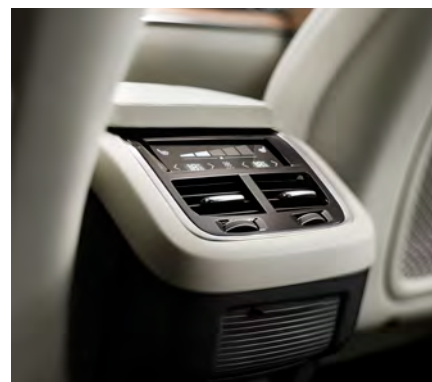
La climatisation quadri-zone se règle depuis l'écran tactile central ou un panneau de commande tactile astucieusement logé à l'extrémité du tunnel central.
