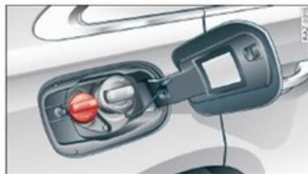
Fig. 166 Côté arrière droit du véhicule : dévissage du bouchon d'obturation du réservoir d'AdBlue
