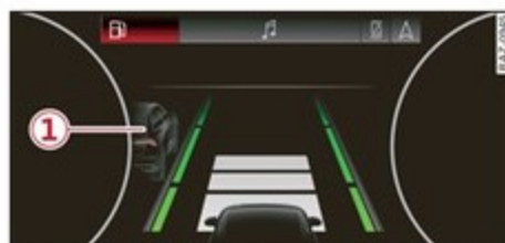
Fig. 124 Combiné d'instruments : dépassement impossible
