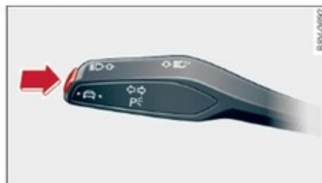
Fig. 118 Levier des clignotants : touche de la fonction de guidage sur la voie
