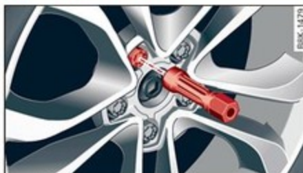
Fig. 190 Roue : six pans creux pour le serrage des boulons de roue
