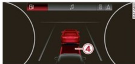
Fig. 126 Combiné d'instruments : avertisseur de distance de sécurité
