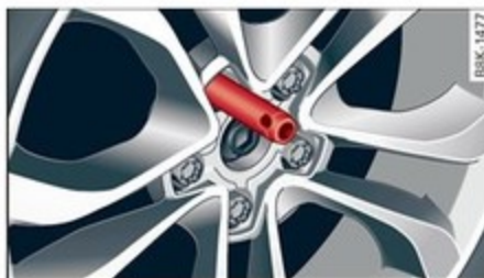
Fig. 191 Roue : axe de montage dans l'orifice supérieur
