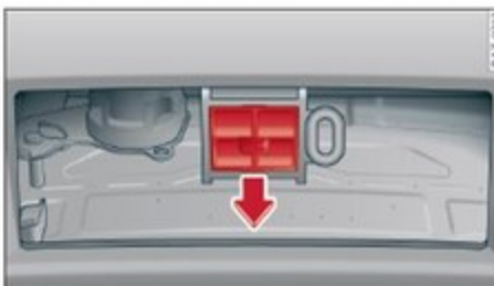
Fig. 98 Zone du pare-chocs arrière : extraction de l'obturateur
