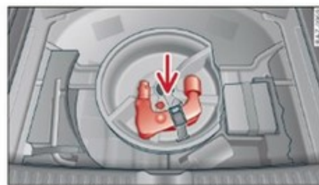
Fig. 95 Coffre à bagages : logement du dispositif d'attelage
