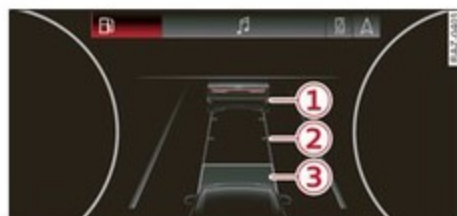
Fig. 125 Combiné d'instruments : affichage de la distance actuelle
