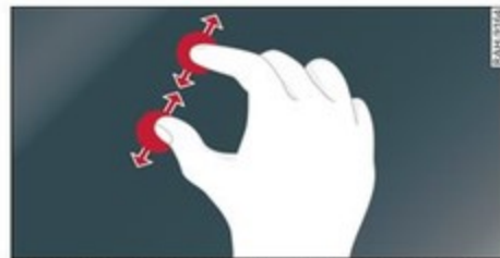
Fig. 11 Écran tactile : écartement/pincement des doigts
