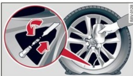
Fig. 184 Pneu : remplissage du pneu
