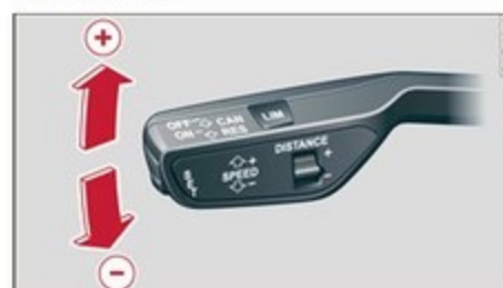
Fig. 117 Levier de commande : modification de la vitesse
