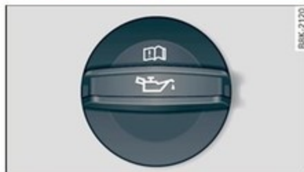
Fig. 172 Compartiment-moteur : couvercle de l'orifice de remplissage d'huile-moteur (exemple)
