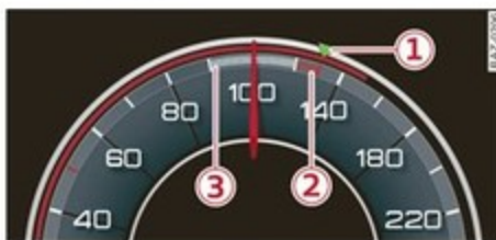
Fig. 119 Audi virtual cockpit plus : affichage de la régulation prédictive dans le tachymètre
