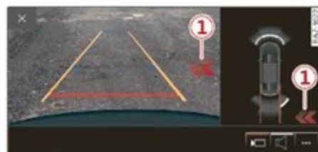
Fig. 138 Écran central : affichage de l'assistant de circulation transversale à l'arrière
