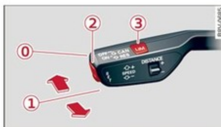
Fig. 121 Levier de commande : réduction de la distance
