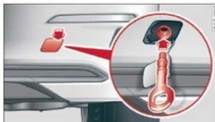
Fig. 195 Pare-chocs arrière : vissage de l'œillet de remorquage (version 1)
