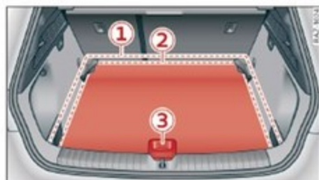
Fig. 73 Coffre à bagages : abaissement* du plancher de chargement
