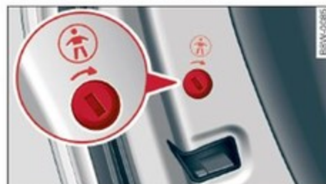
Valable pour les véhicules avec sécurité-enfants manuelle Fig. 33 Porte arrière : sécurité-enfants manuelle
