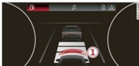
Valable pour les véhicules avec surveillance au démarrage Fig. 122 Combiné d'instruments : surveillance au démarrage
