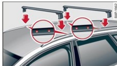
Valable pour les véhicules avec barres de toit Fig. 75 Barres de toit : points de fixation
