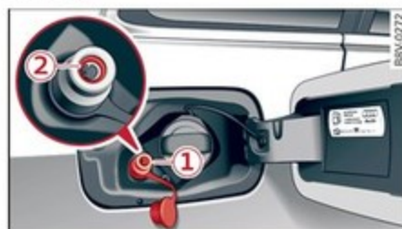
Fig. 164 Volet de réservoir ouvert : ajutage de remplissage de gaz 1, bague-joint de l'ajutage de remplissage de gaz 2
