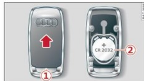
Fig. 79 Remplacement de la pile de la télécommande
