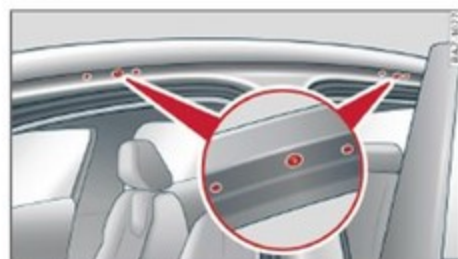
Valable pour les véhicules sans barres de toit Fig. 74 Toit : points de fixation
