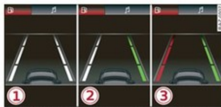
Fig. 128 Combiné d'instruments : affichage Aides au conducteur
