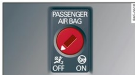
Fig. 60 Boîte à gants : commande à clé permettant de désactiver l'airbag du passager avant
