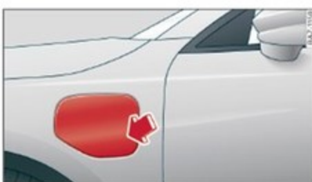
Fig. 86 Côté avant gauche du véhicule : ouverture de la trappe de recharge haute tension
