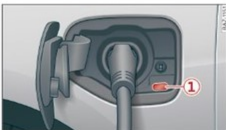
Fig. 87 Unité de recharge : prise de recharge du véhicule et indicateur de recharge
