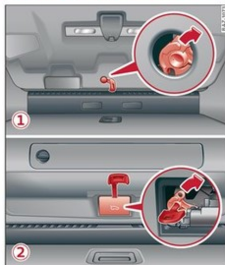
Fig. 31 Côté intérieur du capot arrière : accès au déverrouillage d'urgence
