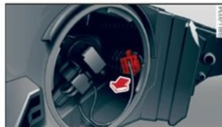
Fig. 204 Phare : douille en plastique du clignotant
