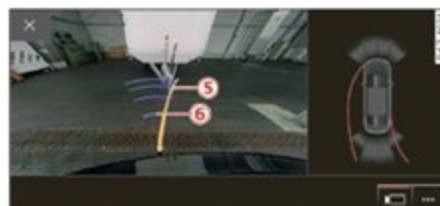
Valable pour les véhicules avec vue de la remorque Fig. 135 Écran central : vue de la remorque
