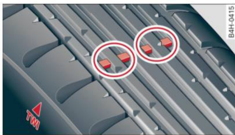
Fig. 186 Semelle : Indicateurs d'usure de la semelle (TWI)
