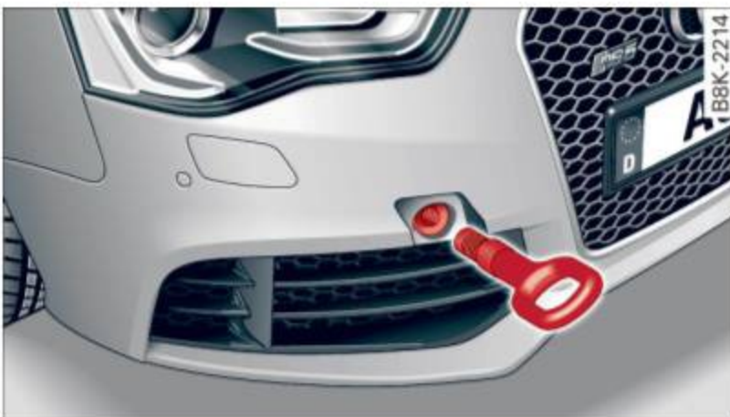
Fig. 206 Par-chocs avant : vissage de l'anneau de remorquage
