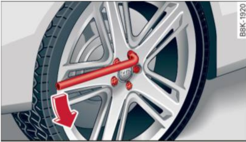
Fig. 194 Changement de roue : desserrer les boulons de la roue
