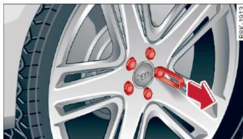
Fig. 193 Changement de roue : enlever les bouchons des boulons de la roue
