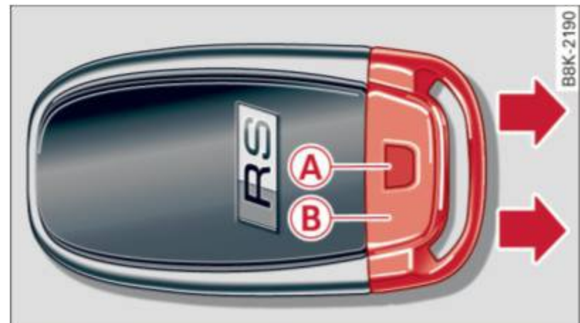
Fig. 19 Clé principale à télécommande : extraire la clé mécanique
