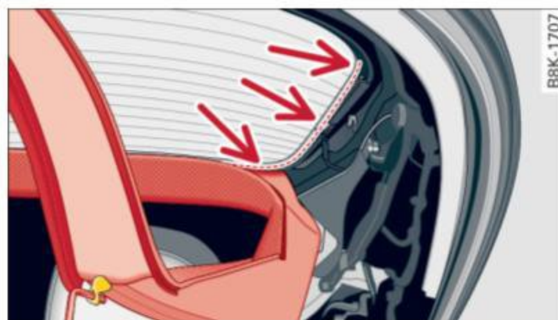
Fig. 53 Zone autour du côté droit de la lunette arrière : garniture de toit partiellement desserrée
