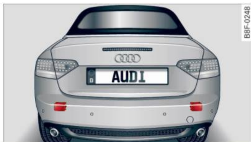
Fig. 117 Arrière du véhicule : position des capteurs
