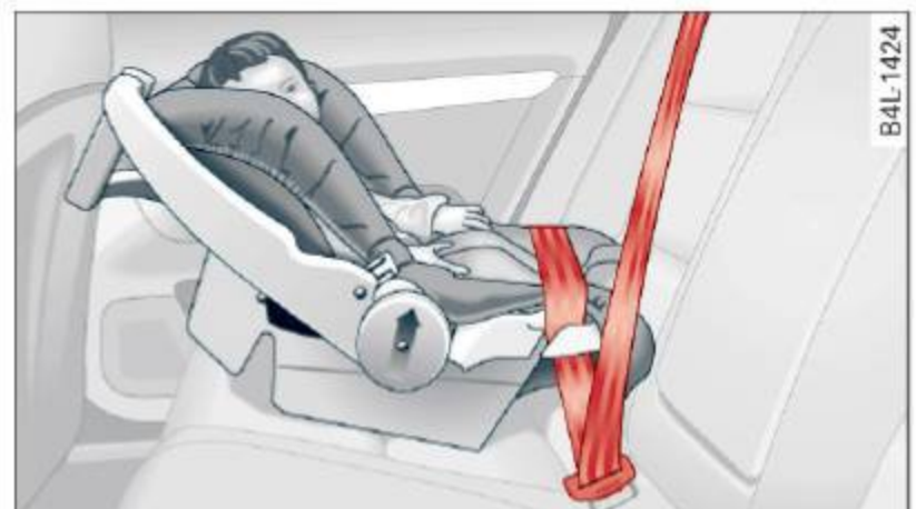
Fig. 160 Schéma de la vue d'ensemble du porte-bébé orienté vers l'arrière installé correctement sur le siège arrière
