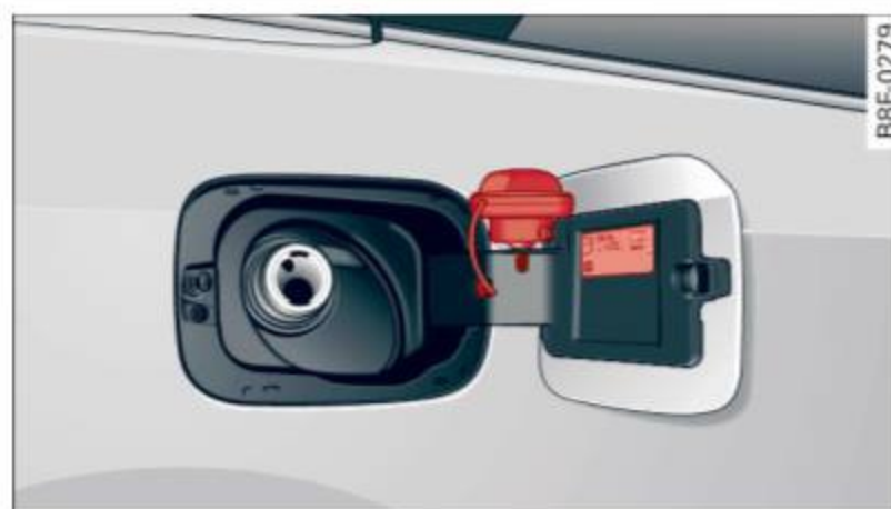
Fig. 171 Volet du goulot de remplissage du réservoir de carburant avec bouchon du réservoir attaché
