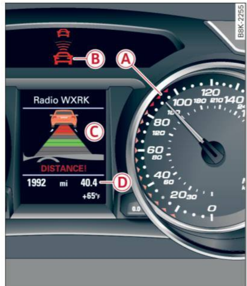
Fig. 112 Bloc-instruments : demande d'intervention du conducteur
