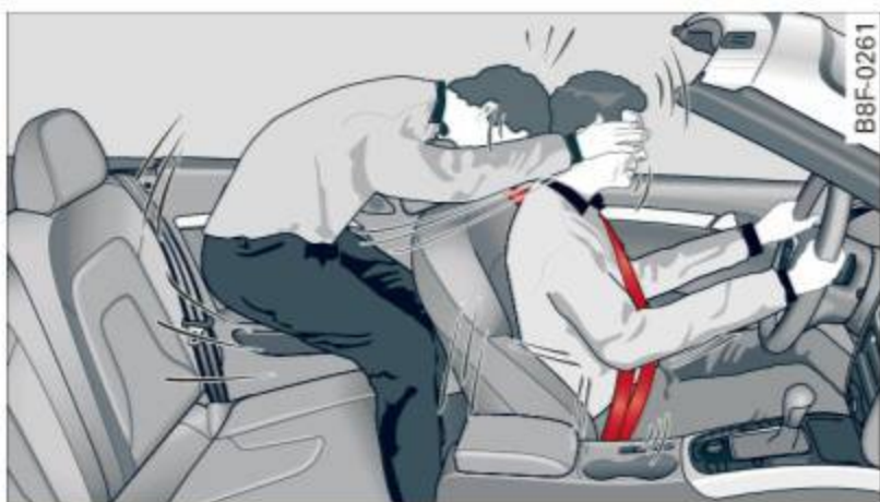
Fig. 145 Passager arrière sans ceinture de sécurité projeté vers l'avant et heurtant le conducteur
