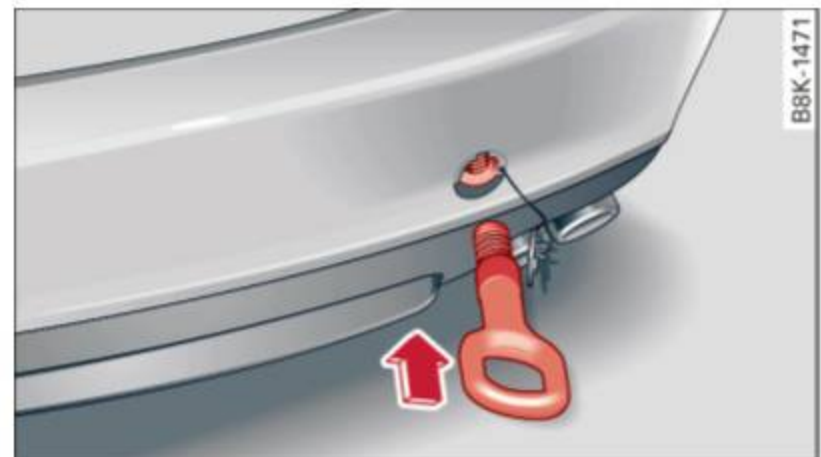
Fig. 207 Pare-chocs arrière : Vissage de l'anneau de remorquage
