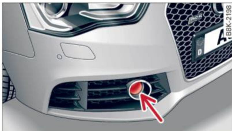
Fig. 103 L'avant du véhicule : position du capteur de radar
