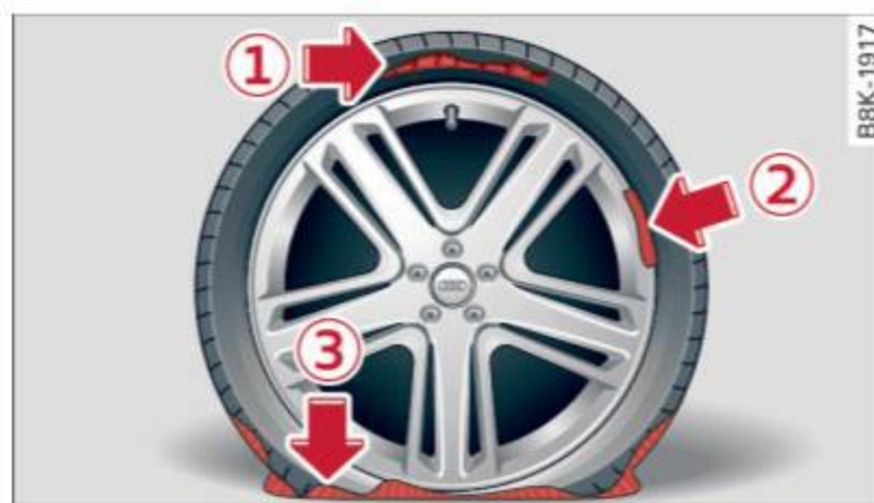
Fig. 191 Damage à un pneu pour lequel le Tire Mobility System n'est pas adapté
