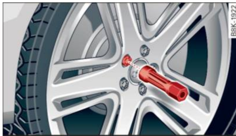
Fig. 197 Changement de roue : utilisation de la poignée du tournevis (lame retirée) pour tourner les boulons
