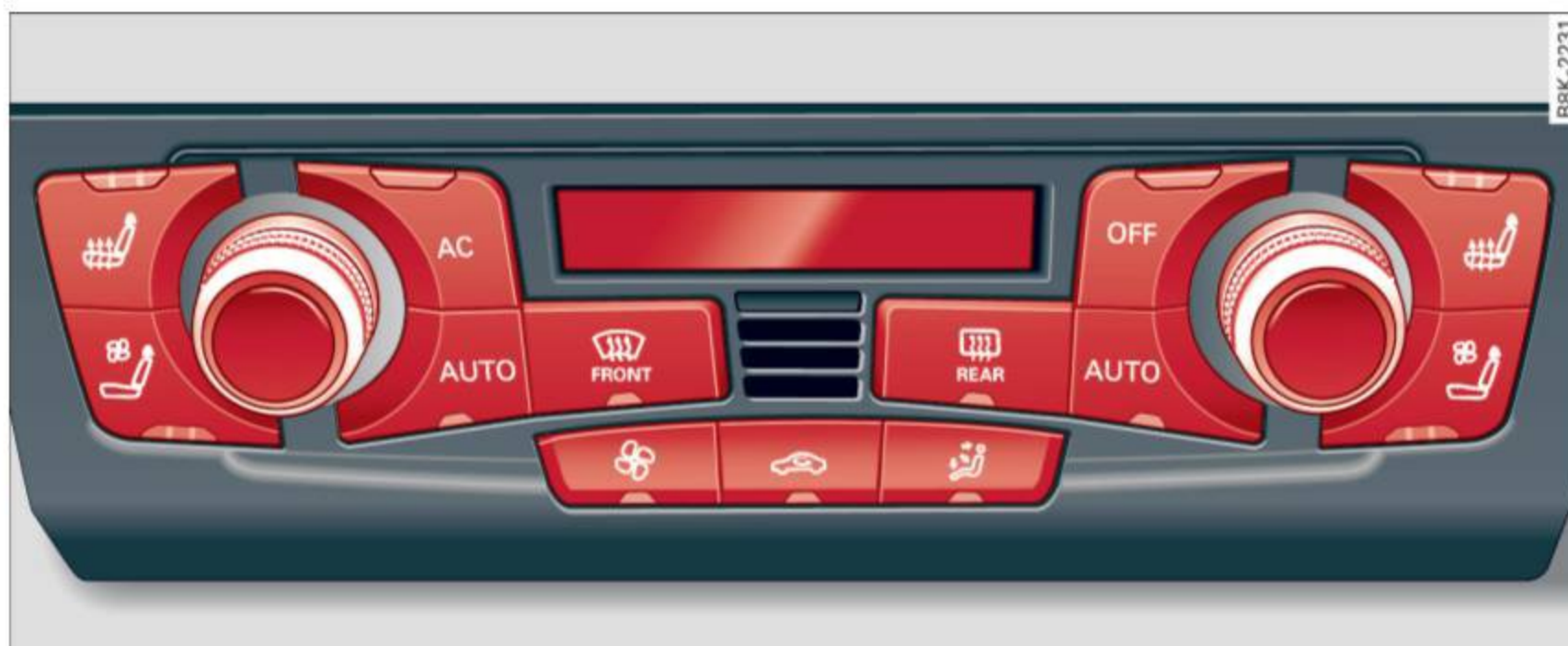
Fig. 84 Climatisation automatique à 3 zones de luxe* : commandes
