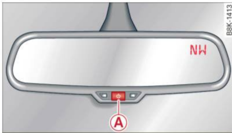
Fig. 66 Rétroviseur intérieur : boussole numérique activée
