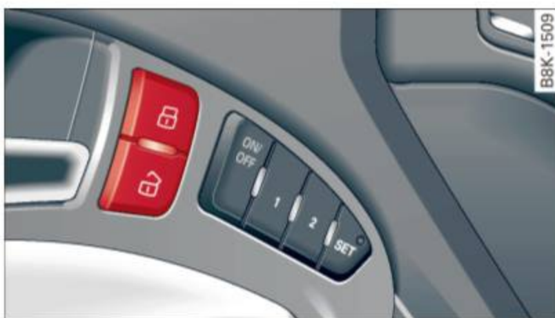
Fig. 23 Porte du conducteur : Commande de verrouillage électrique
