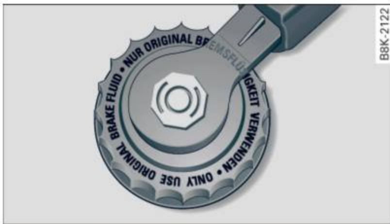
Fig. 181 Compartiment-moteur : couvercle sur le réservoir de liquide de frein
