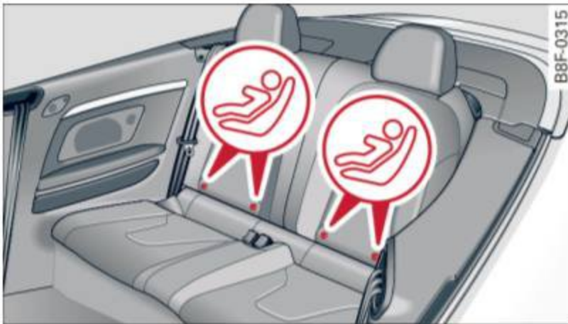
Fig. 165 Dossiers arrière : boutons d'identification pour les ancrages inférieurs universels
