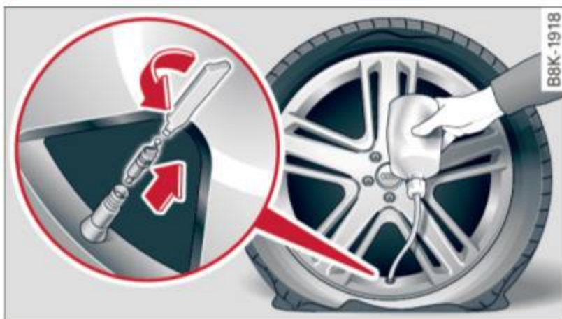
Fig. 192 Exécution d'une réparation de pneu
