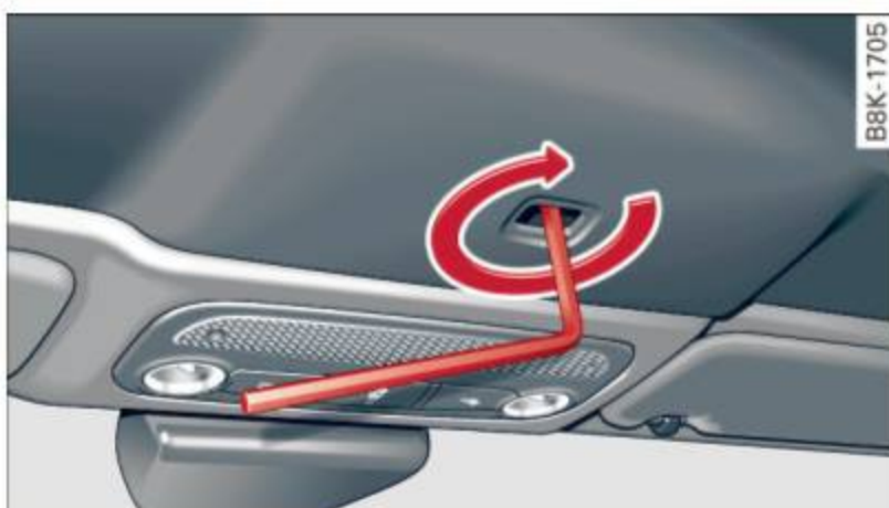
Fig. 51 À l'intérieur de la capote électrique : clé hexagonale pour fonctionnement d'urgence
