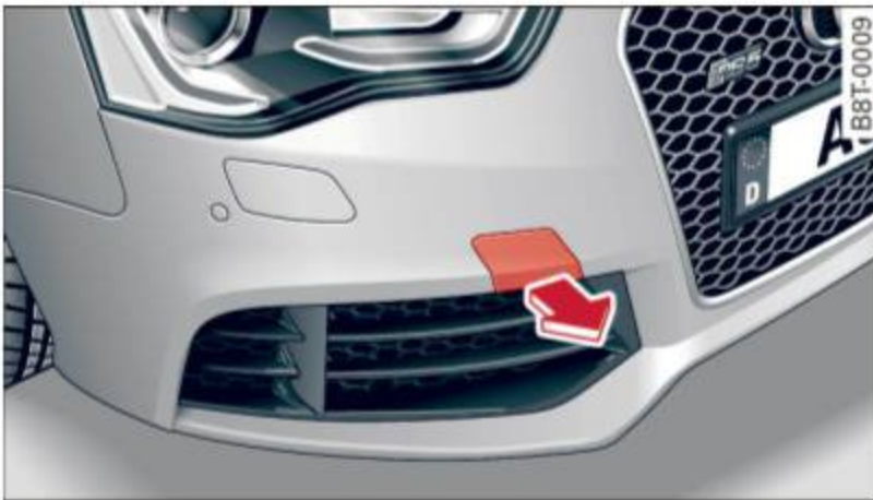
Fig. 205 Par-chocs avant : retrait du couvercle protecteur
