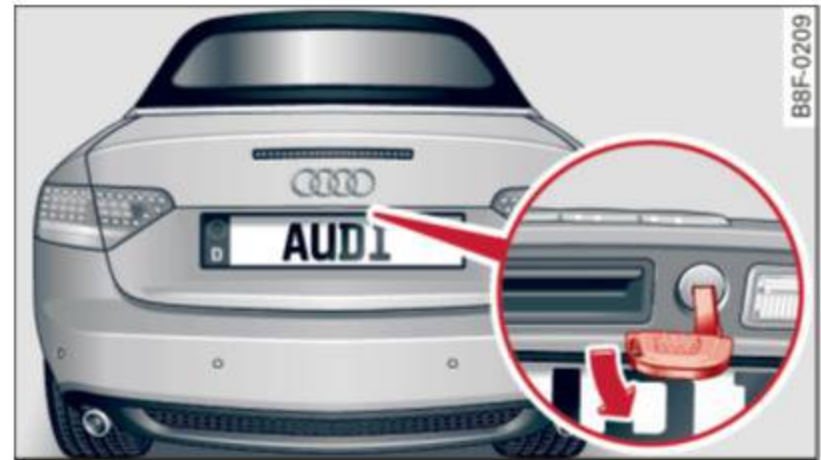
Fig. 27 Couvercle du coffre : barillet de serrure
