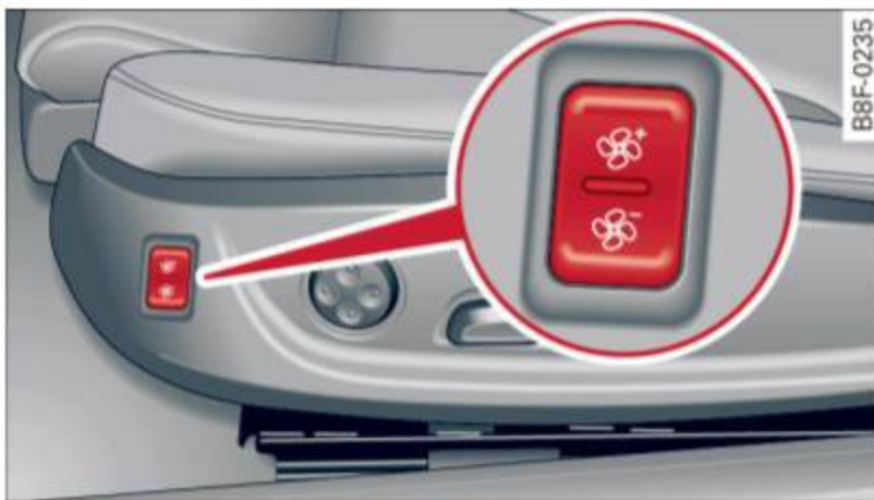
Fig. 86 Sièges du conducteur : bouton pour le chauffage de l'habitacle supérieur
