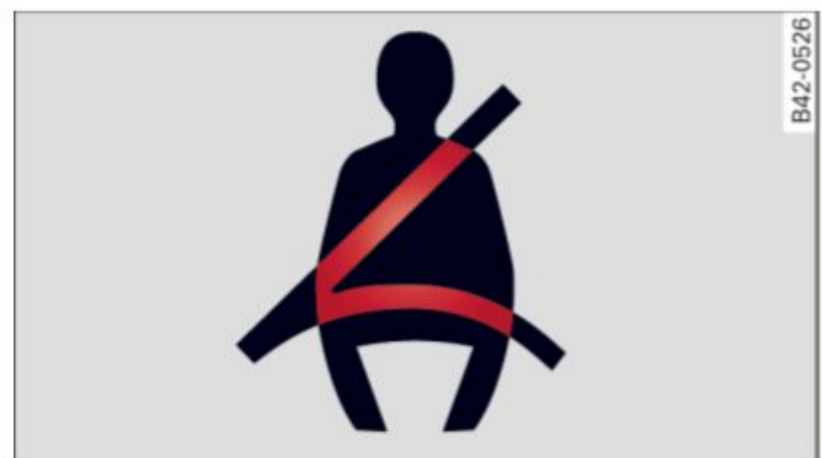
Fig. 141 Le témoin d'alerte des ceintures de sécurité dans le bloc-instruments - vue agrandie
