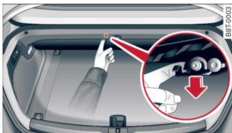
Fig. 40 Compartiment à bagages : levier de dégagement
