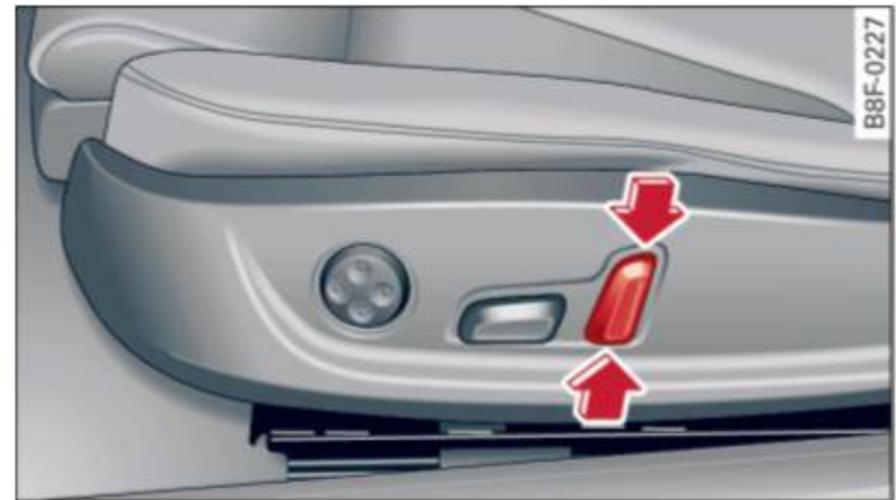
Fig. 72 Siège avant : réglage de l'appui-têtes électrique
