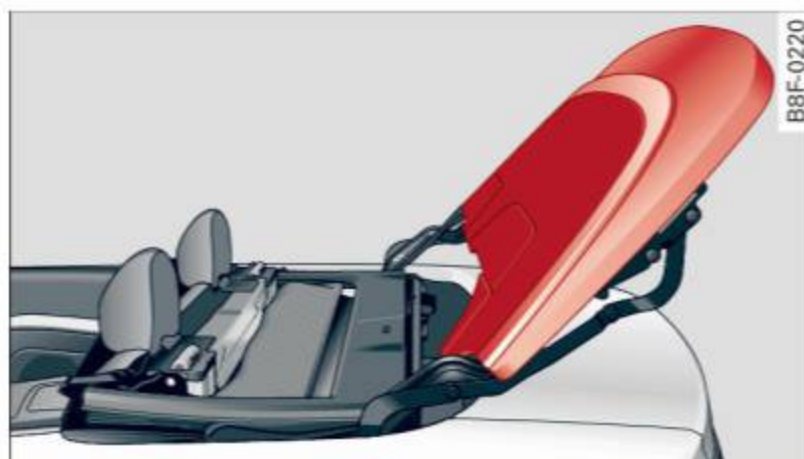
Fig. 45 Couvercle de la boîte de rangement de la capote électrique complètement ouvert
