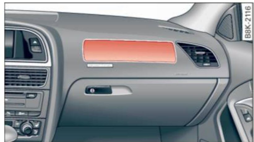
Fig. 153 Emplacement du coussin gonflable du passager avant : dans le tableau de bord
