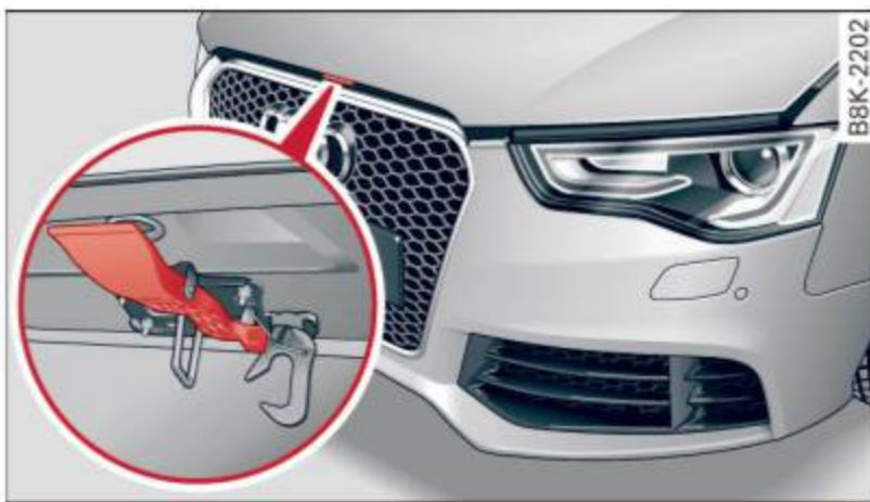
Fig. 175 Levier de dégagement sous le capot-moteur
