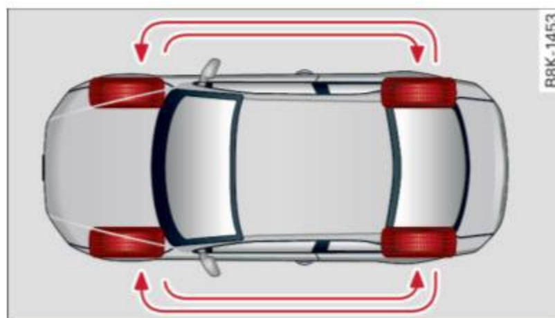
Fig. 187 Rotation des pneus pour une usure plus égale
