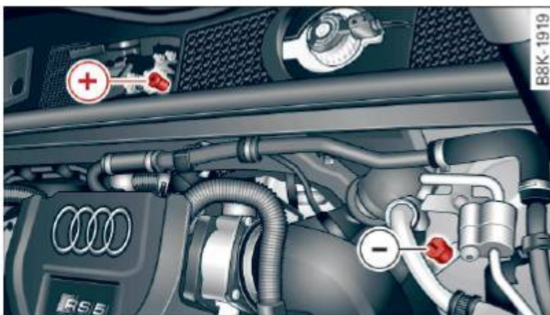
Fig. 203 Compartiment-moteur : connecteurs pour un chargeur ou des câbles volants
