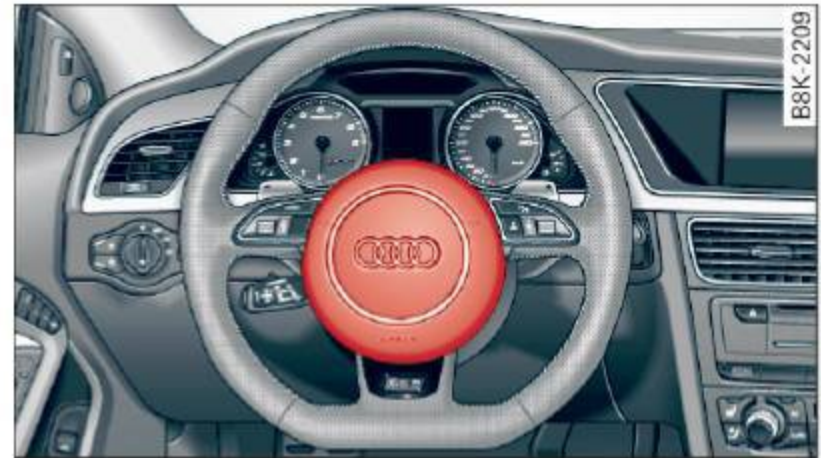
Fig. 152 Emplacement du coussin gonflable du conducteur : dans le volant
