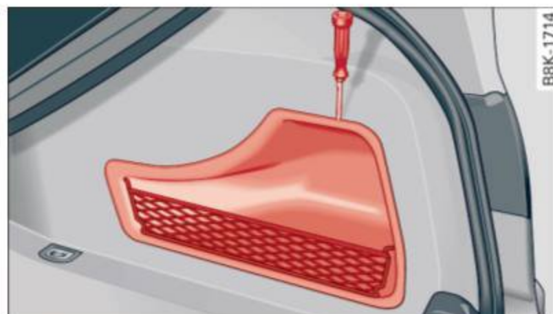
Fig. 172 Compartiment à bagages : ouverture de la garniture latérale
