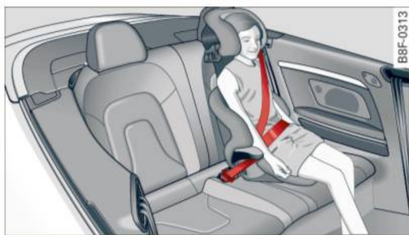
Fig. 163 Siège arrière : enfant bien attaché dans un siège d'appoint
