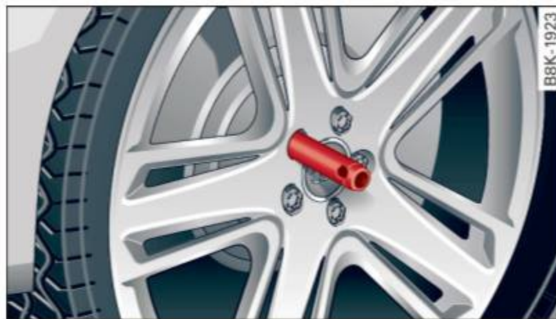
Fig. 198 Changement de roue : tige d'alignement à l'intérieur du trou supérieur
