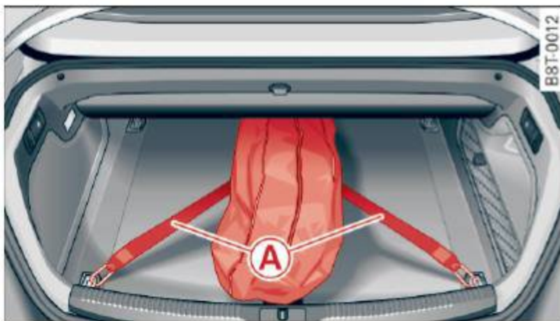
Fig. 81 Compartiment à bagages : Fixer le fourreau à skis
