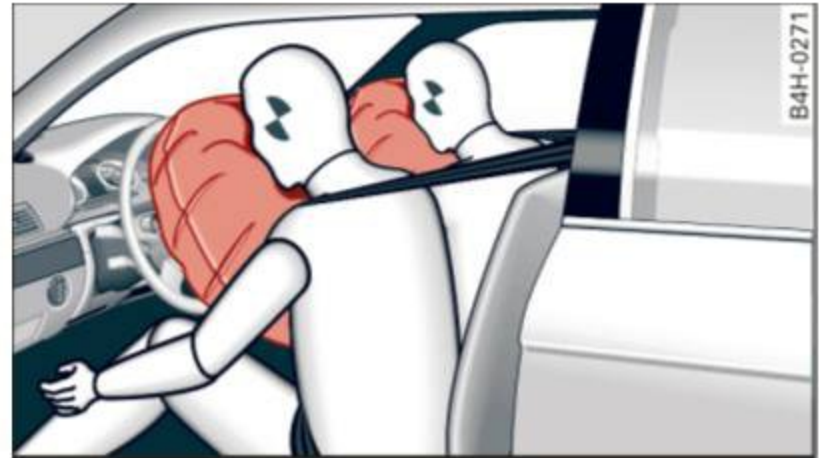
Fig. 154 Protection contre collision frontale : coussins gonflables avant déployés
