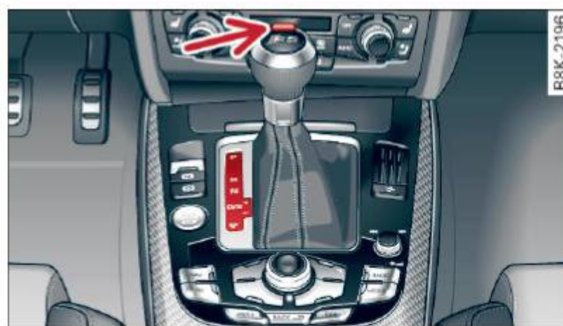
Fig. 98 Panneau de rapports dans la console centrale : levier sélecteur avec de déverrouillage
