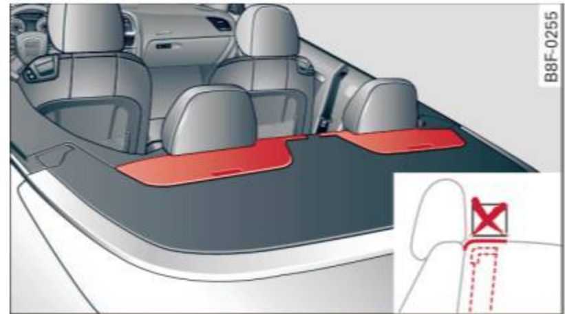
Fig. 137 Sièges arrière : portée du déploiement des arceaux de sécurité
