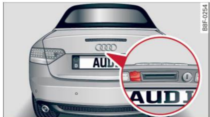
Fig. 126 Couvercle du coffre : emplacement de caméra de recul
