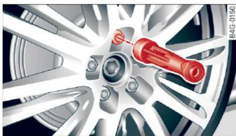
Fig. 211 Changement de roue : utilisation de la poignée du tournevis (lame retirée) pour tourner les boulons
