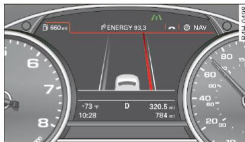
Fig. 96 Affichage : Active lane assist (assistance en voie active) est mise en marche et fournit des avertissements
