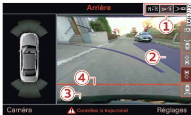
Fig. 139 Infodivertissement : les surfaces bleues alignées dans l'espace de stationnement
