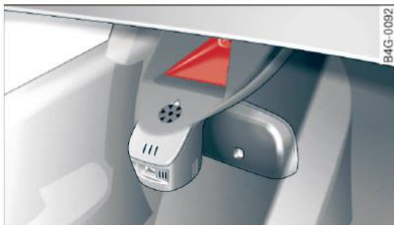
Fig. 95 Pare-brise : hublot de la caméra Active lane assist (d'assistance en voie active)
