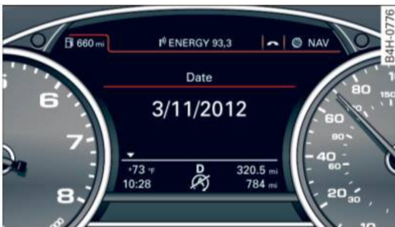
Fig. 79 Bloc d'instruments : engine-Stop temporarily unavailable (engine-Stop temporairement non disponible)
