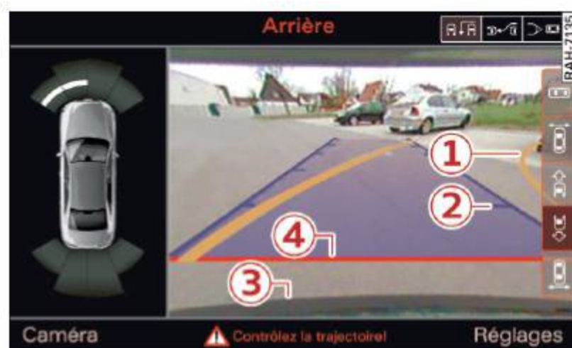
Fig. 137 Infodivertissement : ciblage d'un espace de stationnement
