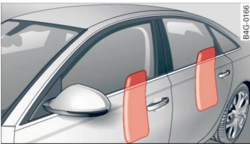
Fig. 163 Protection contre impact latéral : coussins gonflables latéraux déployés
