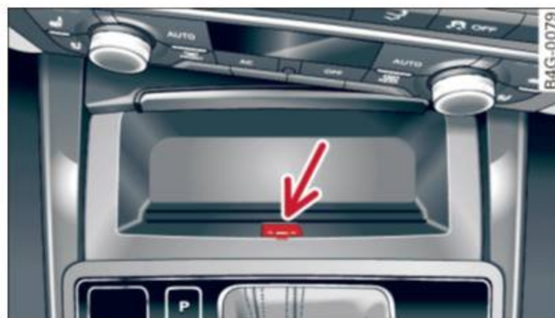
Fig. 117 Console centrale avant: dégagement d'urgence du levier sélecteur
