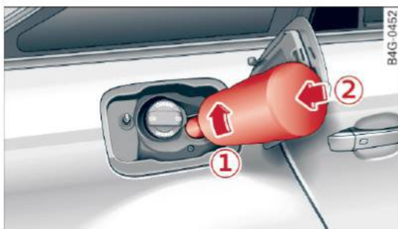
Fig. 184 Le tube de remplissage d'AdBlue : insertion de la bouteille de remplissage
