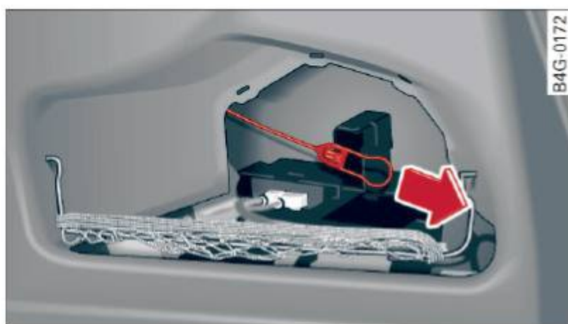
Fig. 181 Panneau de garniture du côté droit du compartiment à bagages : mécanisme d'ouverture d'urgence
