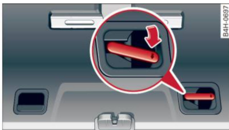
Fig. 201 Poignée de sortie d'urgence du coffre : Vue de l'intérieur du coffre fermé
