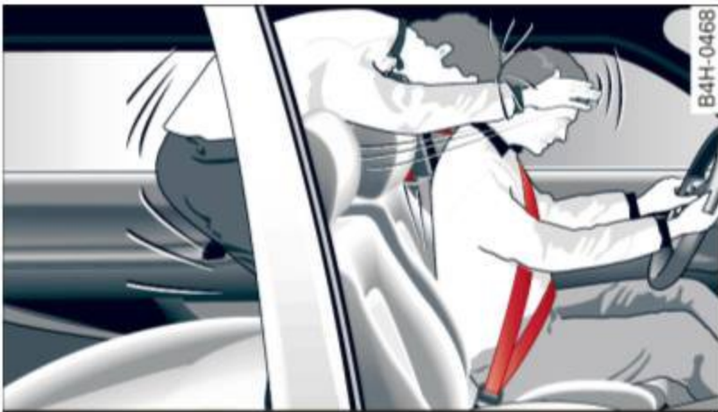
Fig. 150 Passager arrière sans ceinture de sécurité projeté vers l'avant et heurtant le conducteur
