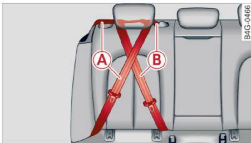
Fig. 166 Schéma de la vue d'ensemble : mettez les ceintures de sécurité inutilisées loin des enfants dans les sièges pour enfant. (A) - ceinture de sécurité arrière latérale, (B) - ceinture de sécurité centrale latérale*
