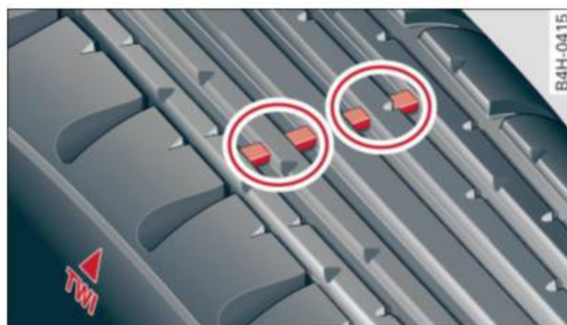
Fig. 196 Semelle : Indicateurs d'usure de la semelle (TWI)
