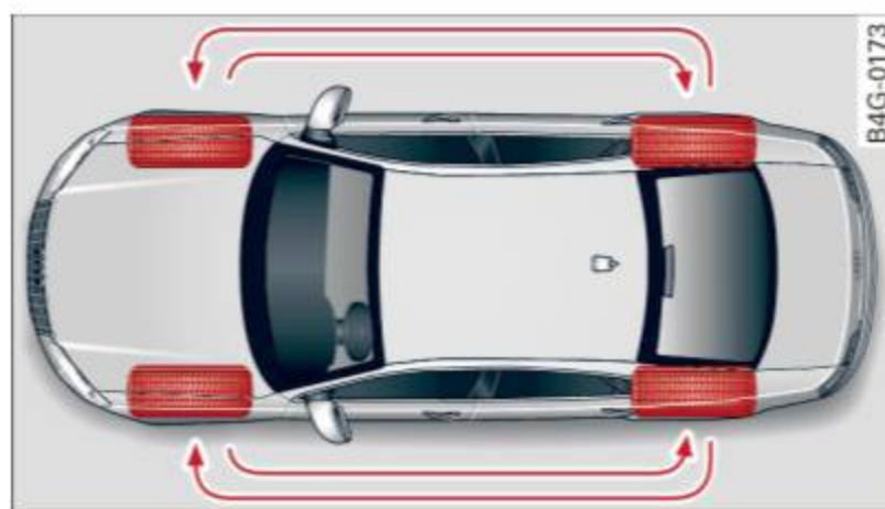
Fig. 197 Rotation des pneus pour une usure plus égale
