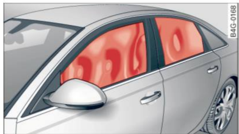
Fig. 165 Illustration du principe : coussins gonflables latéraux déployés du côté gauche
