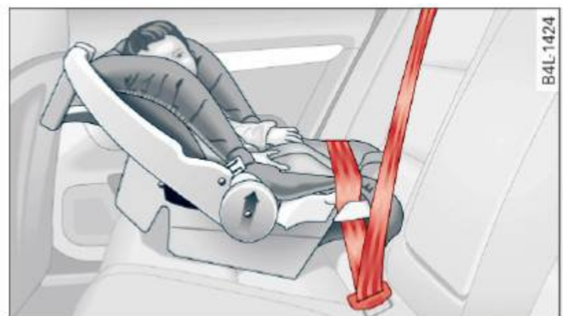
Fig. 167 Schéma de la vue d'ensemble du porte-bébé orienté vers l'arrière installé correctement sur le siège arrière
