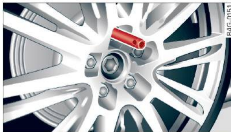
Fig. 212 Changement de roue : tige d'alignement à l'intérieur du trou supérieur
