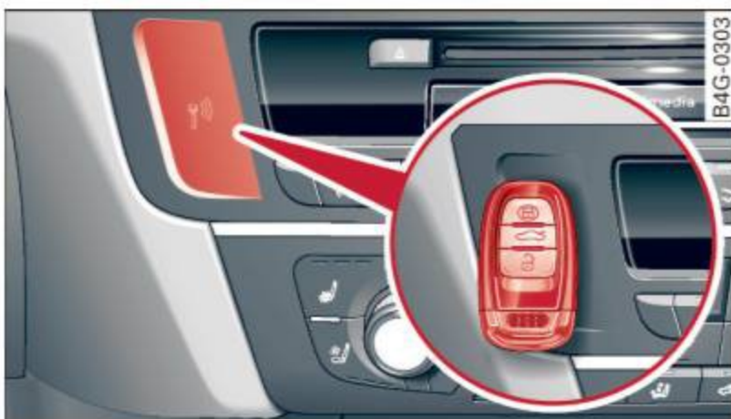
Fig. 76 Console centrale/clé principale : démarrage du moteur s'il y a une défaillance
