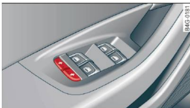
Fig. 30 Section de la porte du conducteur : boutons des verrous de sécurité pour les enfants
