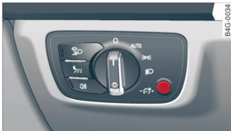
Fig. 39 Éclairage des instruments
