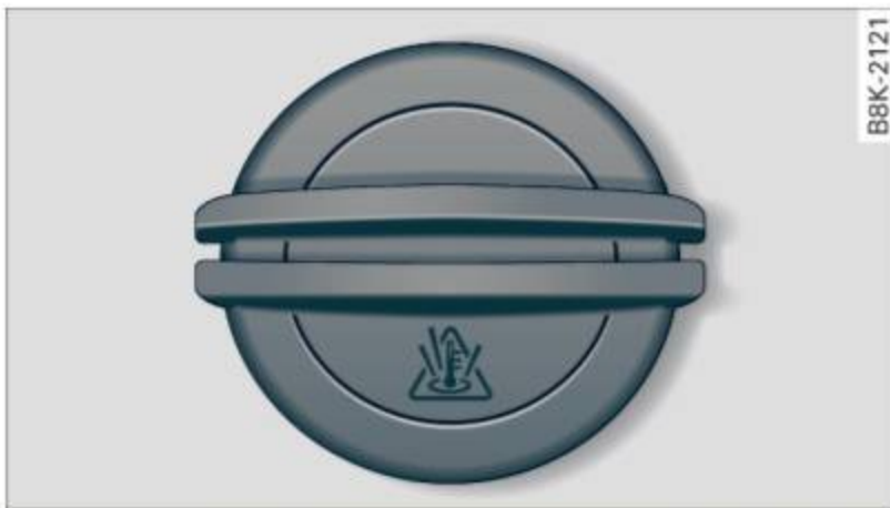
Fig. 190 Compartiment-moteur : couvercle sur le réservoir d'expansion du liquide de refroidissement
