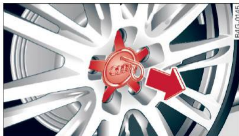
Fig. 205 Changement d'une roue : Enlever l'enjoliveur
