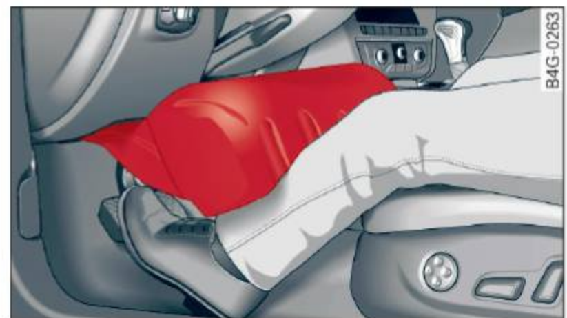
Fig. 161 Coussins gonflables offrant une protection en cas de collision frontale
