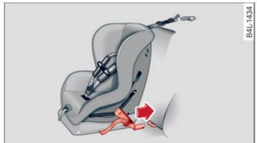
Fig. 174 Ancrages inférieurs : montage approprié
