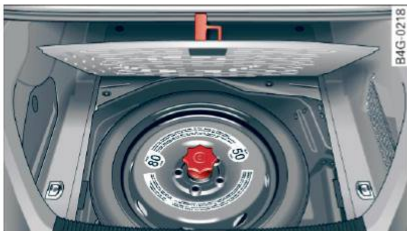
Fig. 203 Compartiment à bagages : couvercle du plancher replié vers l'avant/roue de secours
