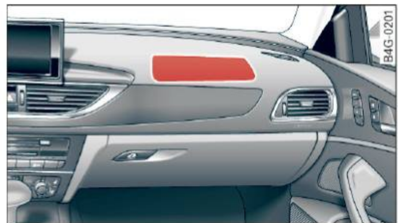
Fig. 158 Emplacement du coussin gonflable du passager avant : dans le tableau de bord
