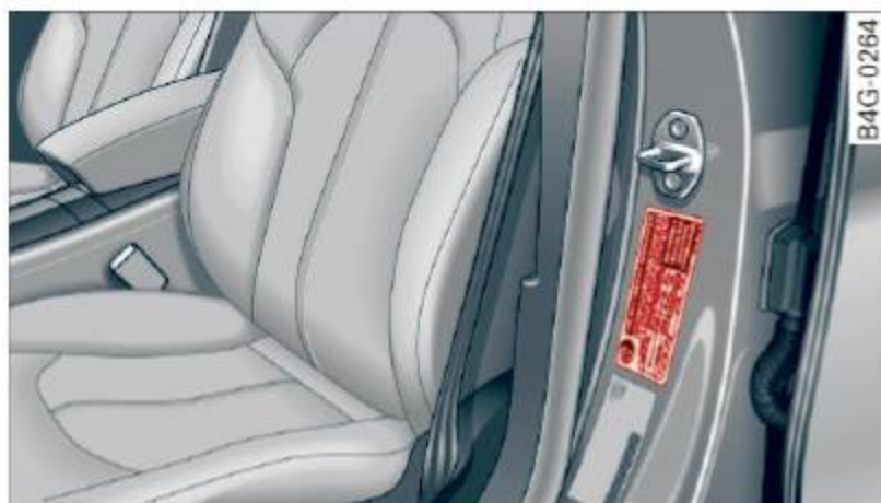
Fig. 194 Étiquette de pression de gonflage des pneus : située sur le montant B de la porte du conducteur.
