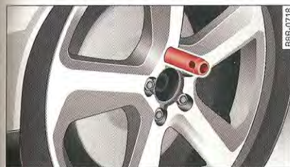
Fig. 230 Changement de roue : axe de montage dans l'orifice supérieur
