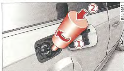
Fig. 201 Ajustage de remplissage d'AdBlue : mise en place du bidon de remplissage
