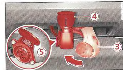
Fig. 193 Pare-chocs arrière : encliquetage du dispositif d'attelage et ouverture de la prise de courant
