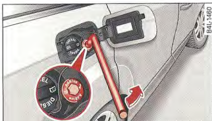
Fig. 200 Côté arrière droit du véhicule : dévissage du bouchon d'obturation du réservoir d'AdBlue
