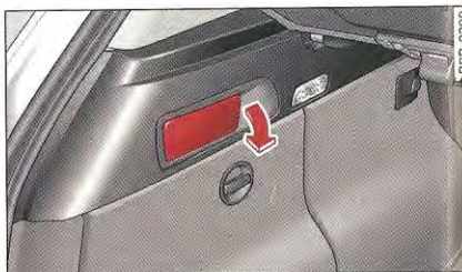
Fig. 84 Coffre à bagages : levier de déverrouillage
