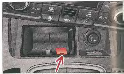
Fig. 122 Déverrouillage d'urgence du levier sélecteur
