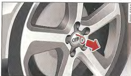
Fig. 224 Changement de roue : retrait du capuchon de roue
