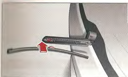
Fig. 52 Essuie-glace arrière : démontage du balai d'essuie-glace
