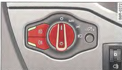
Fig. 36 Tableau de bord : commande d'éclairage
