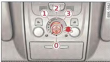
Fig. 35 Vue partielle du ciel de pavillon : commande rotative du toit en verre panoramique
