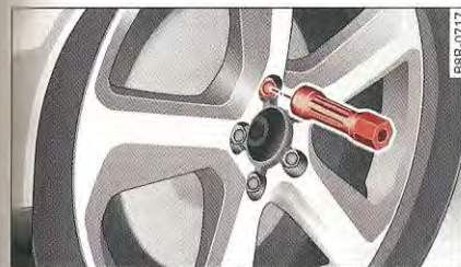
Fig. 229 Changement de roue : six pans creux pour le serrage des boulons
