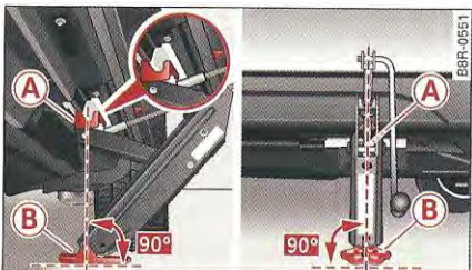
Fig. 228 Bas de caisse : mise en place du cric
