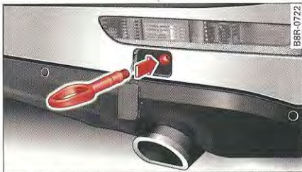
Fig. 237 Pare-chocs arrière : vissage de l'œillet de remorquage
