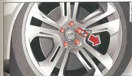
Fig. 225 Changement de roue : retrait des capuchons de protection
