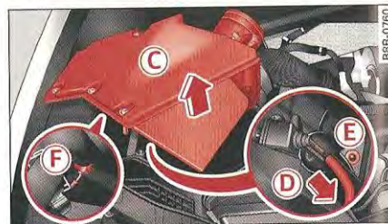
Fig. 250 Dépose du corps de filtre à air
