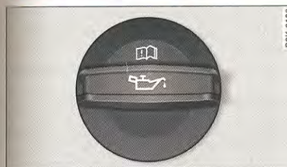
Fig. 206 Compartiment-moteur : bouchon de l'orifice de remplissage d'huile-moteur
