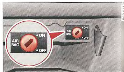
Fig. 184 Boîte à gants : commande à clé permettant de désactiver l'airbag du passager avant
