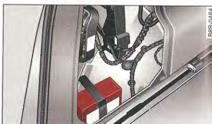
Fig. 221 Coffre à bagages, côté gauche : compresseur
