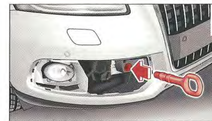
Fig. 235 Partie avant droite sans cache : vissage de l'œillet de remorquage
