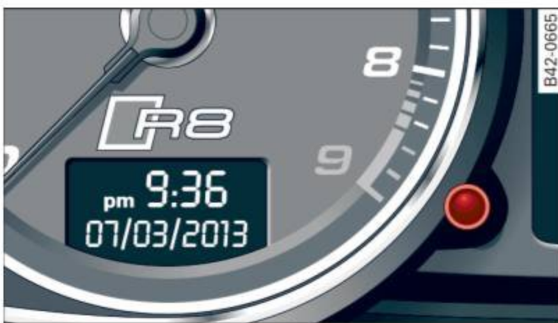
Fig. 77 Section du bloc-instruments : Bouton Programmer/Vérifier
