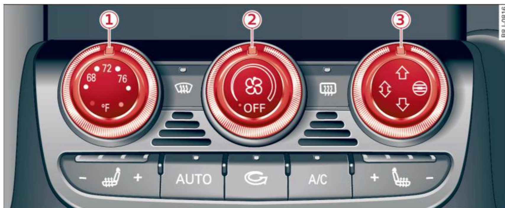
Fig. 71 Commandes de climatisation
