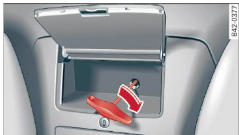
Fig. 38 Compartiment de rangement supérieur : utiliser une clé hexagonale comme une manivelle pour baisser la glace arrière
