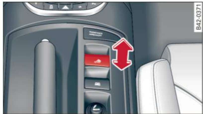
Fig. 32 Console centrale : commutateur du toit décapotable
