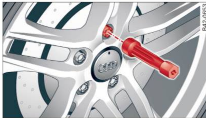
Fig. 161 Changement de roue : utilisation de la poignée du tournevis (lame retirée) pour tourner les boulons
