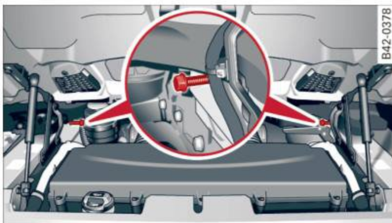
Fig. 39 Compartiment moteur : installer les boulons de fonctionnement d'urgence
