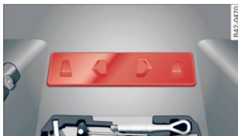
Fig. 146 Compartiment à bagages : couvercle de la batterie
