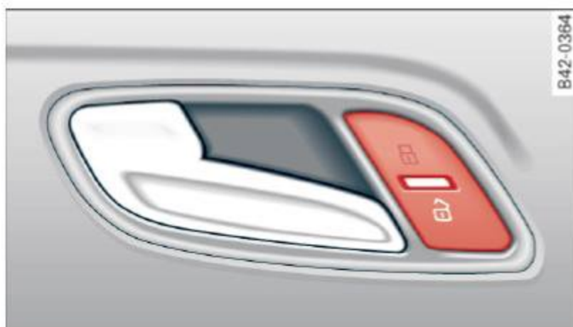
Fig. 25 Section de la porte du conducteur : Commutateur de verrouillage électrique
