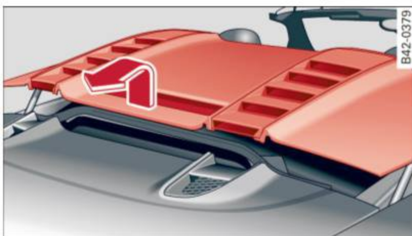
Fig. 40 Levez le couvercle du logement et le retirer
