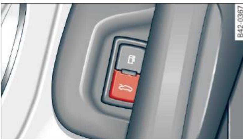
Fig. 27 Porte de conducteur : déverrouillage du couvercle avant par télécommande
