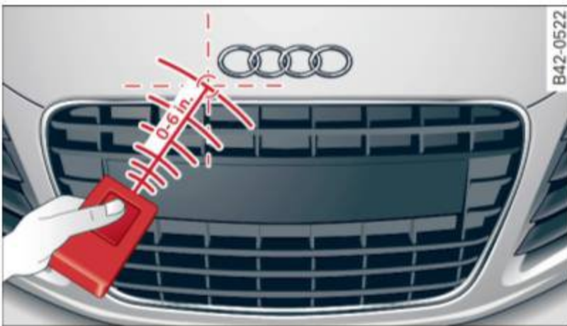
Fig. 100 Pare-chocs avant: emplacement de l'émetteur
