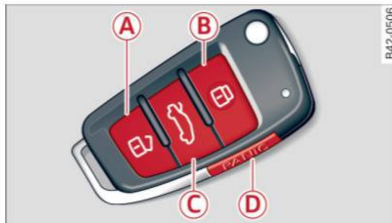
Fig. 23 Télécommande : boutons de fonction
