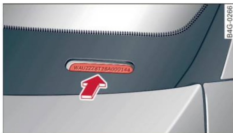
Fig. 168 Plaque du numéro d'identification du véhicule (NIV) : emplacement sur le tableau de bord, côté conducteur
