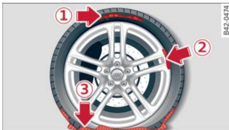
Fig. 154 Dommage à un pneu pour lequel le Tire Mobility System n'est pas adapté
