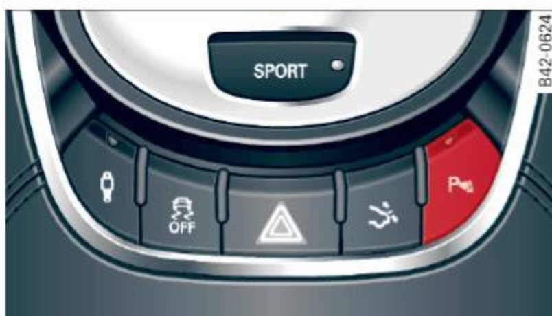
Fig. 92 Partie du console centrale : Commutateur d'aide au stationnement
