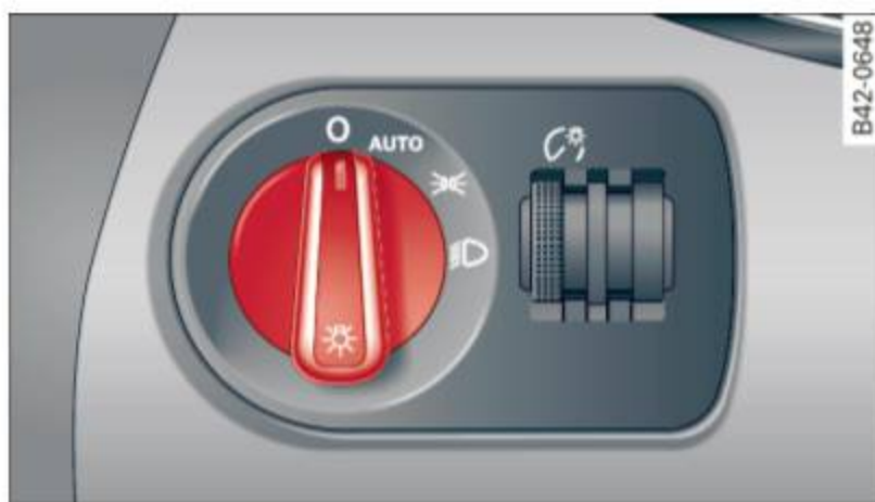
Fig. 52 Tableau de bord : commutateur d'éclairage (la commande automatique des phares et feux arrière)
