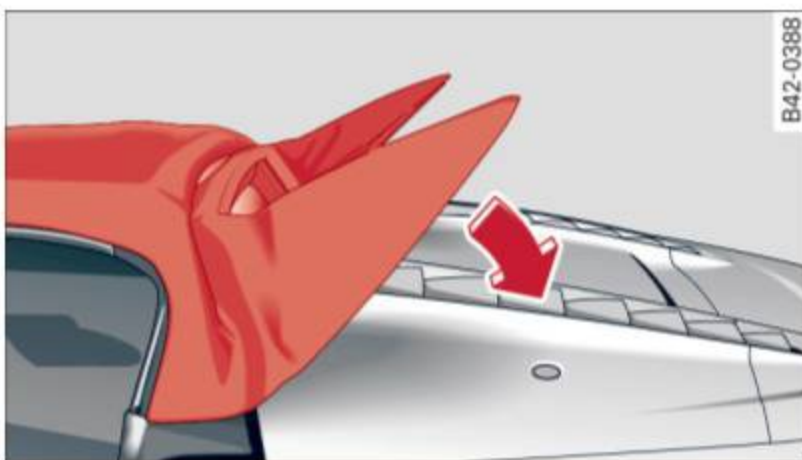
Fig. 49 Toit décapotable : pousser vers le bas les ailettes
