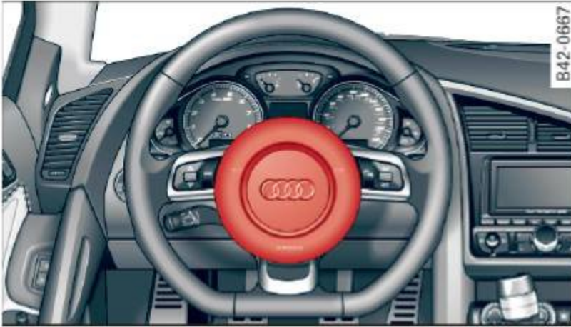
Fig. 117 Emplacement du coussin gonflable du conducteur : dans le volant
