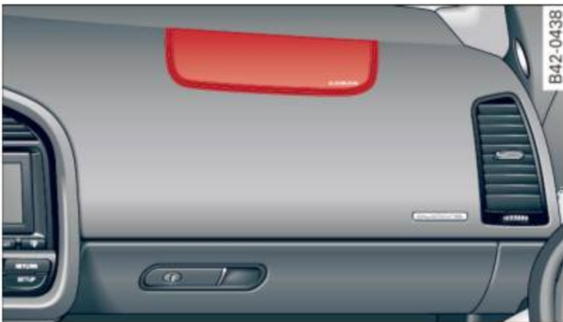
Fig. 118 Emplacement du coussin gonflable du passager avant : dans le tableau de bord
