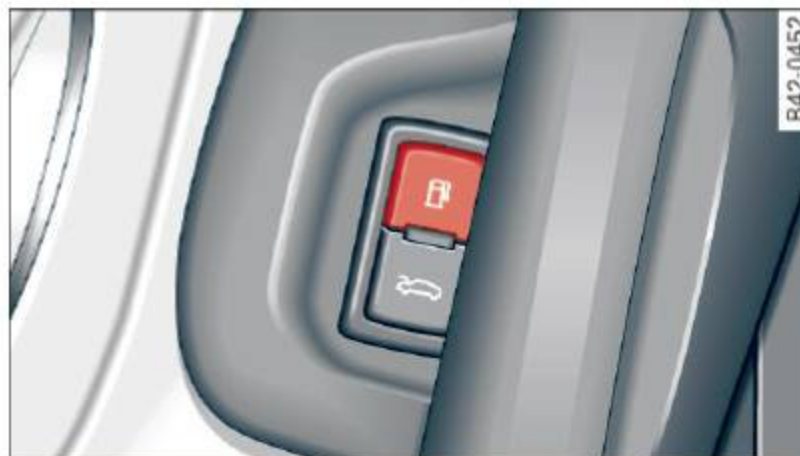
Fig. 130 Porte du conducteur : déverrouiller le volet du goulot de remplissage
