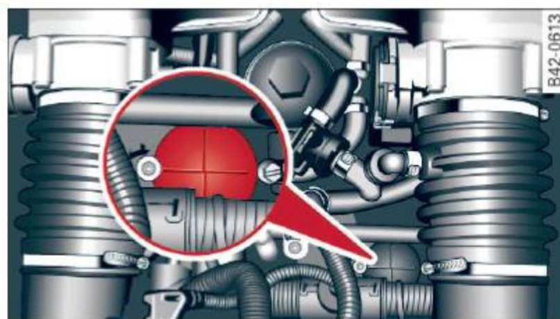
Fig. 86 Compartiment-moteur: Levier de dégagement d'urgence
