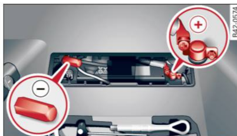
Fig. 147 Compartiment à bagages : connecteurs du chargeur et câbles volants
