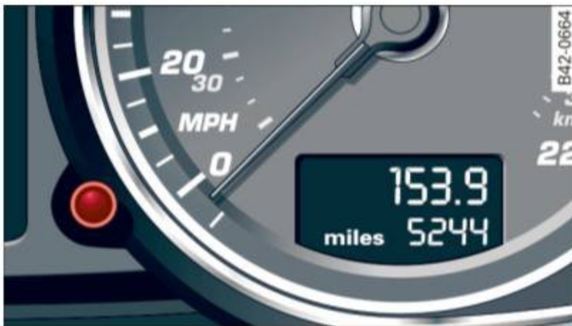
Fig. 5 Vue agrandie de l'indicateur de vitesse : Affichage du compteur kilométrique
