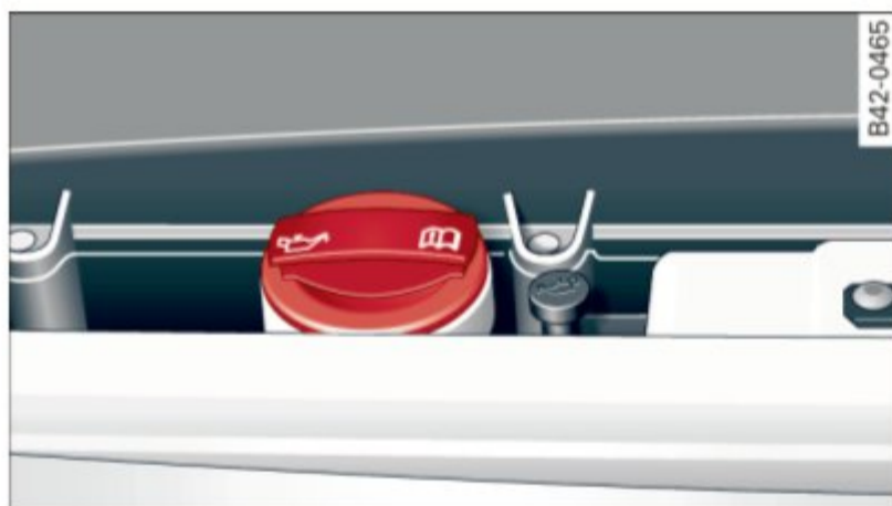
Fig. 142 Compartiment du moteur : Emplacement du bouchon de remplissage d'huile
