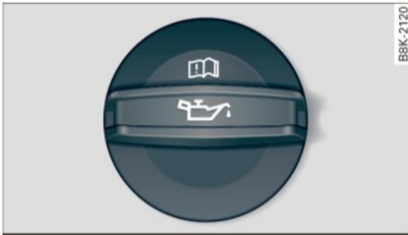
Fig. 143 Compartiment-moteur : couvercle sur le goulot de remplissage d'huile-moteur
