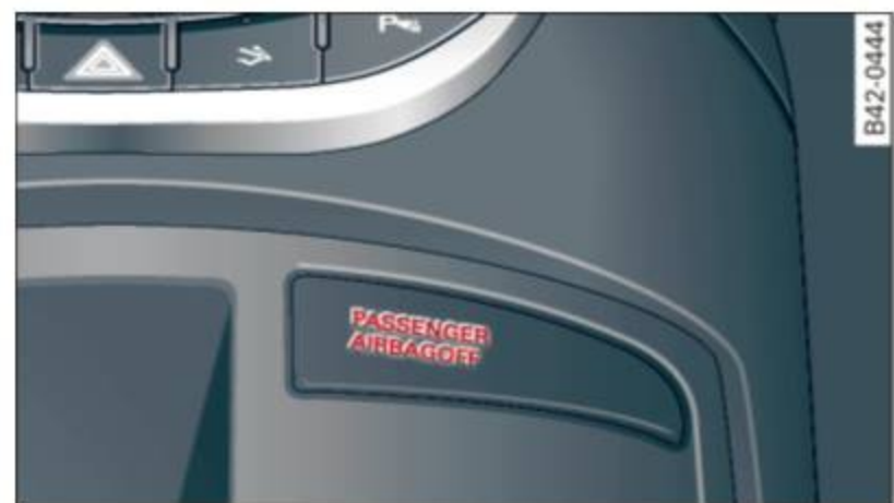
Fig. 120 Section du tableau de bord : lumière PASSENGER AIR BAG OFF
