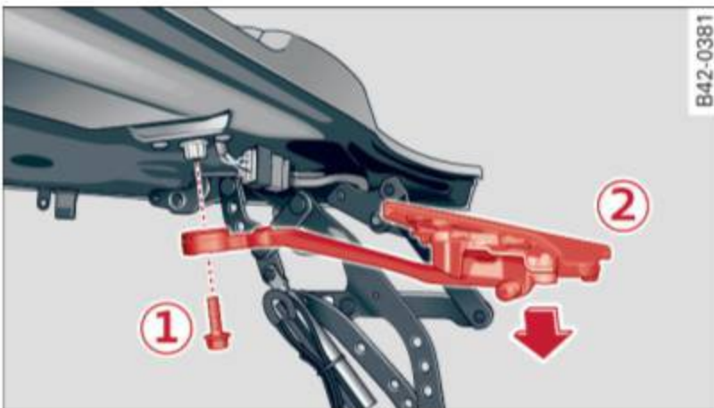
Fig. 42 Couvercle du logement du toit décapotable : déposez le couvercle
