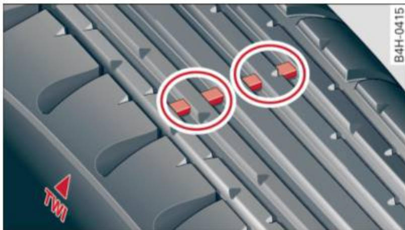
Fig. 151 Semelle : Indicateurs d'usure de la semelle (TWI)
