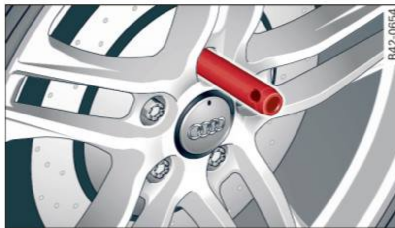
Fig. 162 Changement de roue : tige d'alignement à l'intérieur du trou supérieur
