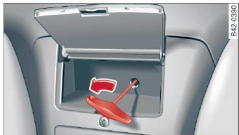
Fig. 51 Compartiment de rangement entre les dossiers de siège : déployer la glace arrière
