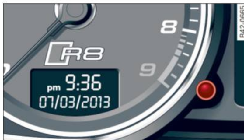
Fig. 4 Bloc-instruments avec montre numérique
