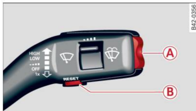
Fig. 10 Levier d'essuie-glace : commandes de l'ordinateur de bord
