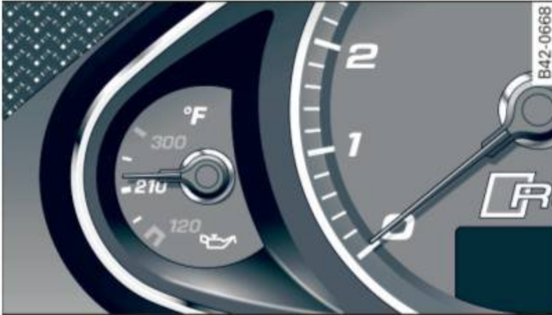
Fig. 138 Bloc-instruments : Affichage de température d'huile-moteur
