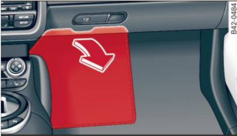
Fig. 166 Logement de roue du côté passager : Reposé-pied avec disposition des fusibles
