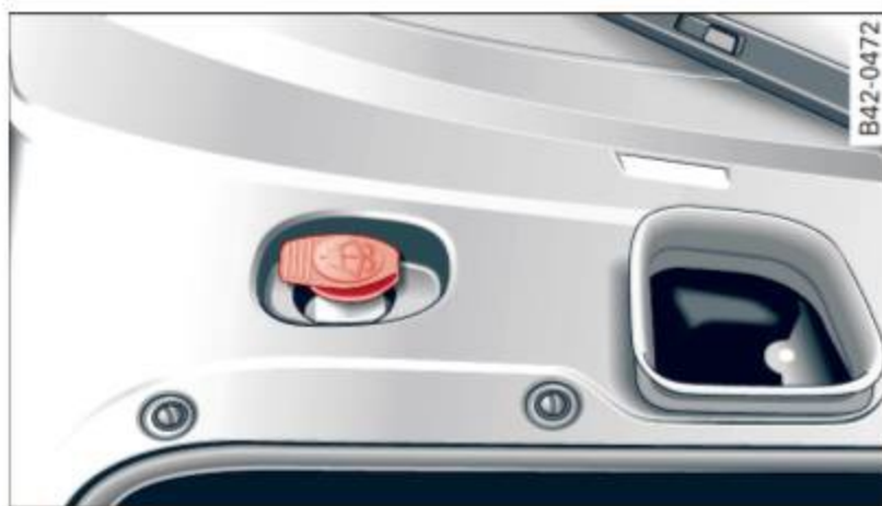
Fig. 148 Compartiment à bagages : Réservoir de liquide de lave-glace
