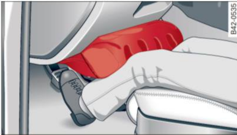
Fig. 122 Coussins gonflables offrant une protection en cas de collision frontale
