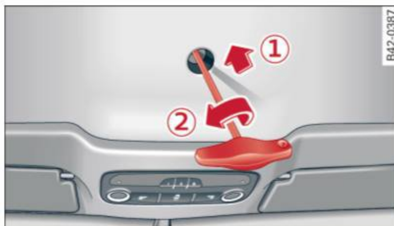
Fig. 48 Côté intérieure du toit décapotable : placez la clé hexagonale
