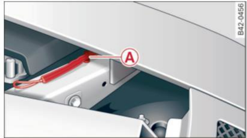
Fig. 132 Compartiment moteur : desserrez le câble de volet de réservoir de carburant
