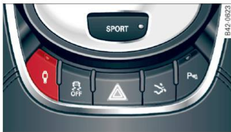
Fig. 81 Console centrale : Commande pour Audi magnetic ride (la conduite magnétique Audi)
