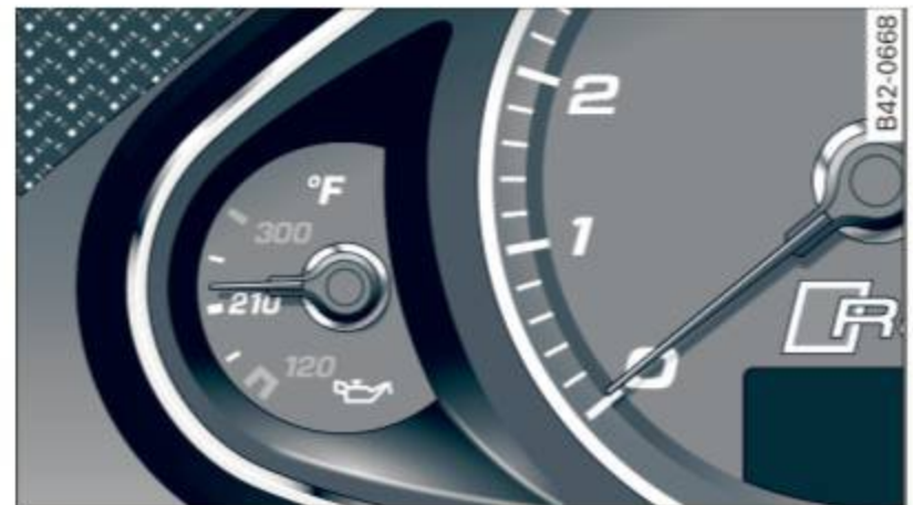
Fig. 140 Bloc-instruments : Affichage de température d'huile-moteur
