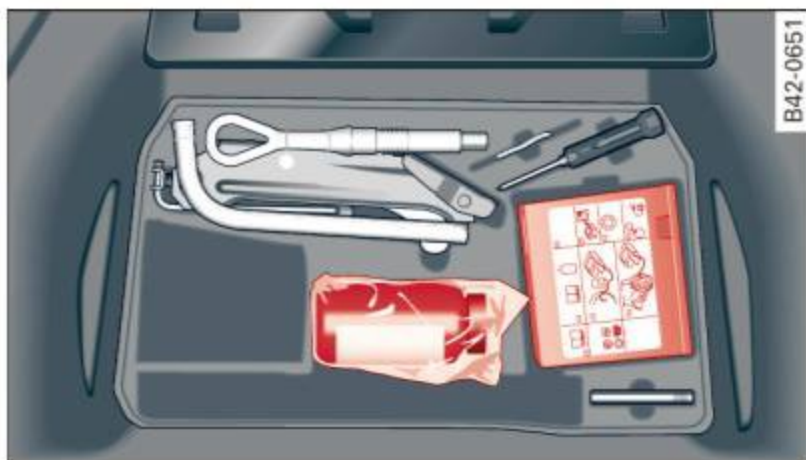
Fig. 155 Le Tire Mobility System sous le plancher du compartiment à bagages
