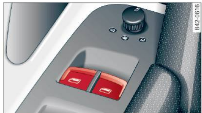
Fig. 31 Porte du conducteur : commandes de vitres électriques
