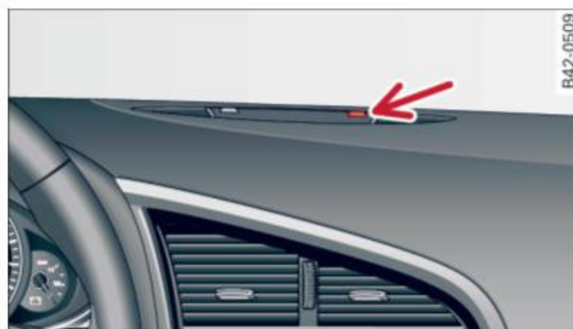
Fig. 30 Position de la diode dans le tableau de bord
