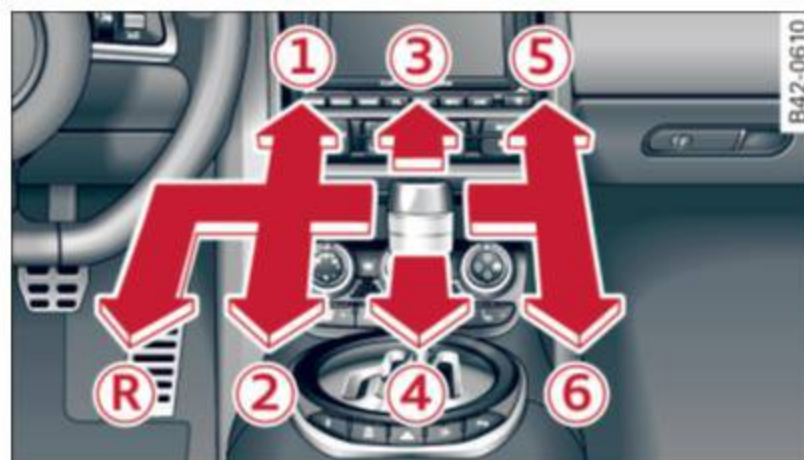
Fig. 82 Grille des changements de vitesses (boîte de vitesses manuelle 6 vitesses)
