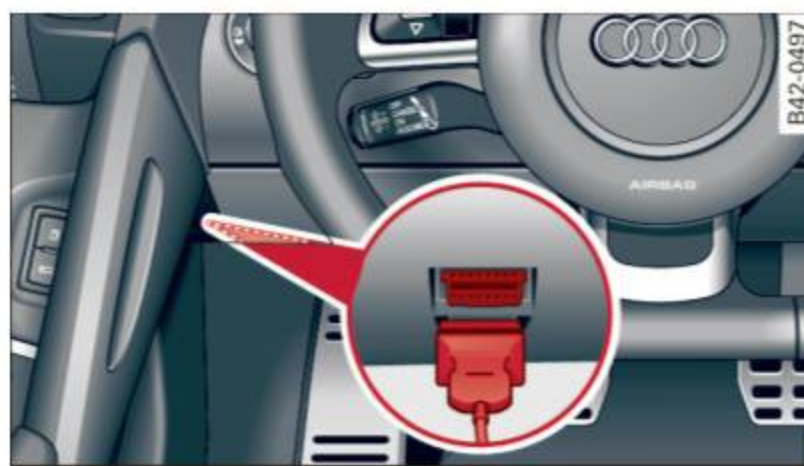
Fig. 19 Position du connecteur de liaison de données (DLC)
