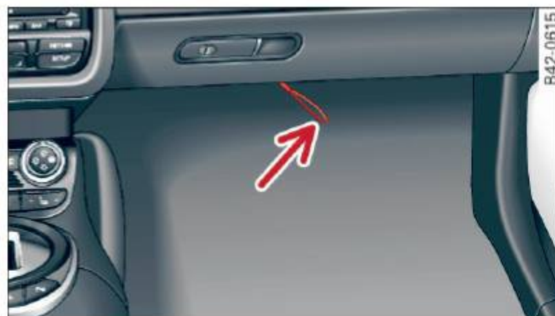
Fig. 29 Section : Dégagement d'urgence
