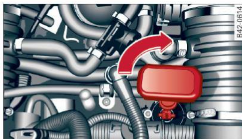
Fig. 87 Compartiment-moteur: Dégagement d'urgence du verrouillage en position de stationnement
