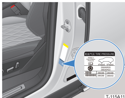
Étiquette de pression des pneus
