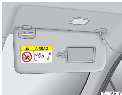
Étiquette d'avertissement d'airbag frontal
