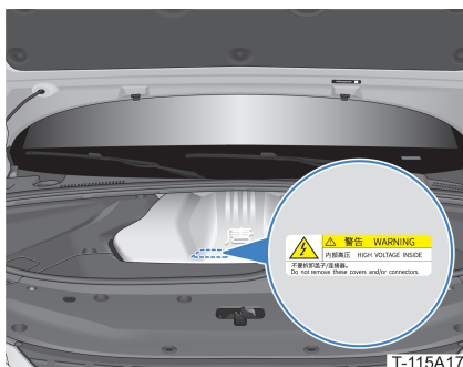
Étiquettes d'avertissement des composants haute tension
