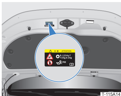
Étiquettes d'avertissement de remplissage de liquide de refroidissement et de ventilateur de refroidissement
