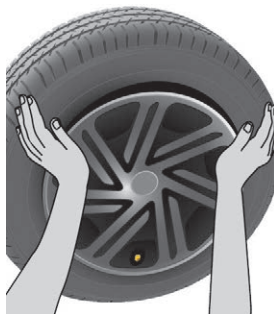
Position du bord enjoliveur non conforme .
