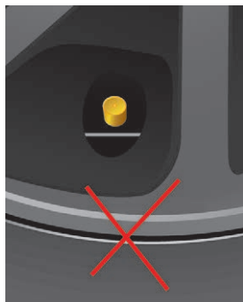
Position du bord enjoliveur non conforme .
