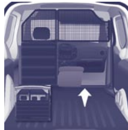
Cloison avec trappe
