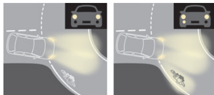
Sans / avec éclairage statique d'intersection
