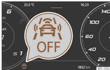
Fig. 152 Sur l'écran du combiné d'instruments : indication de Front Assist désactivé.
