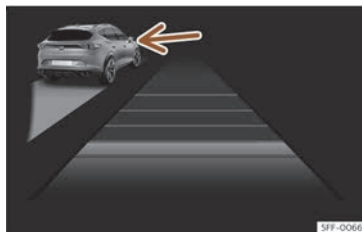
Fig. 156 Sur l'écran du combiné d'instruments : ACC activé, véhicule circulant à gauche détecté
