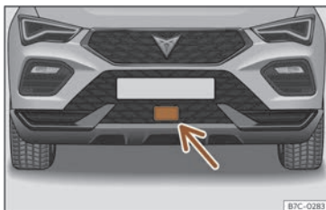
Fig. 143 Au niveau du pare-chocs avant : capteur radar.
