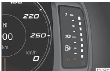
Fig. 54 Indicateur du niveau de carburant.
