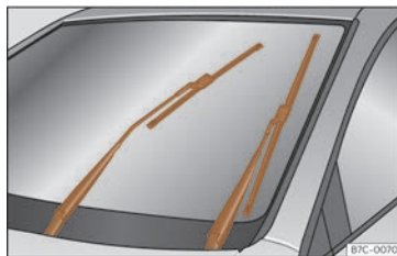
Fig. 37 Essuie-glace en position d'entretien.
