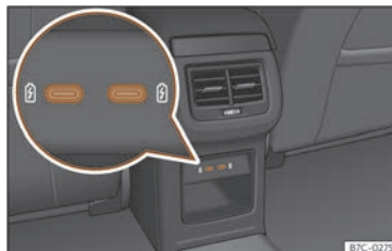
Fig. 133 Partie arrière de la console centrale : connecteurs USB avec fonction de prise de courant.
