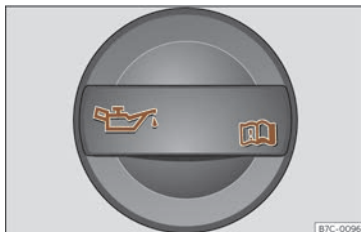
Fig. 198 Dans le compartiment-moteur : bouchon de l'orifice de remplissage d'huile moteur.
