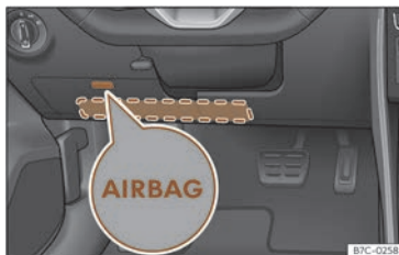
Fig. 17 Côté conducteur : emplacement de l'airbag de genoux.
