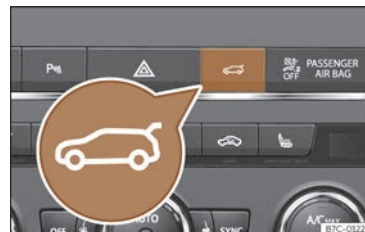
Fig. 79 Console centrale : touche d'ouverture et de fermeture du hayon arrière.
