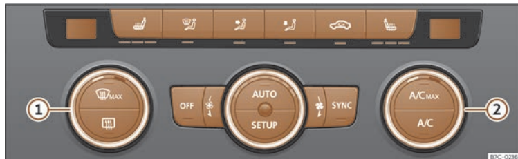
Fig. 124 Sur la console centrale : commandes du Climatronic.
