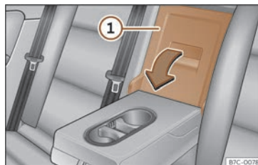
Fig. 115 Dans le dossier de la banquette arrière : ouverture de la trappe.
