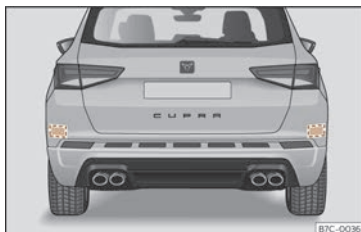
Fig. 146 Vue arrière du véhicule : zones des capteurs radars.
