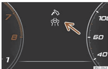
Fig. 53 Indication de l'assistance pour une conduite écologique (représentation schématique).
