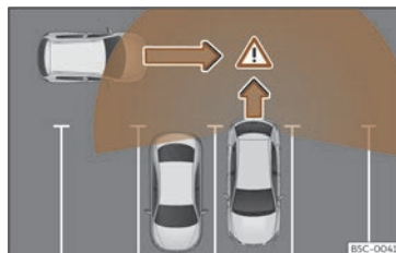
Fig. 167 Représentation schématique de l'assistant de sortie de stationnement : zone surveillée autour du véhicule sortant de stationnement.
