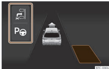
Fig. 171 Sur l'écran du combiné d'instruments : affichage du système de stationnement assisté avec affichage réduit.
