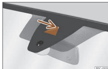
Fig. 145 Sur le pare-brise : fenêtre de l'assistant de maintien de voie.
