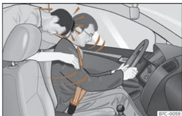
Fig. 8 L'occupant de la banquette arrière non attaché est projeté en avant et vient heurter le conducteur attaché.
