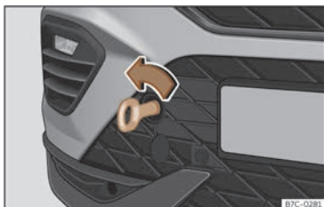
Fig. 42 Du côté droit du pare-chocs avant : œillet de remorquage vissé
