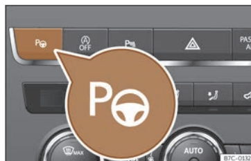
Fig. 170 Sur la console centrale supérieure : touche permettant de connecter le système de stationnement assisté.
