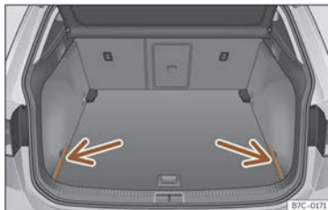
Fig. 107 Dans le coffre à bagages : caches de rangement de la plage arrière.
