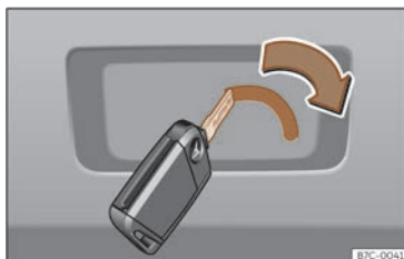
Fig. 82 Détail du coffre à bagages : déverrouillage d'urgence.
