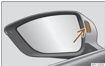
Fig. 163 Voyant de contrôle de l'assistant de changement de voie.
