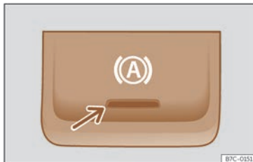
Fig. 169 Sur la partie inférieure de la console centrale : touche de fonction Auto Hold.
