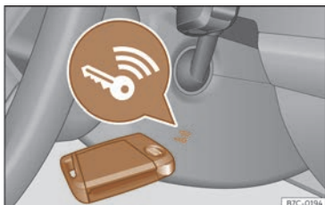
Fig. 135 À droite de la colonne de direction : démarrage d'urgence.
