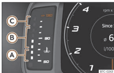
Fig. 55 Indicateur de température du liquide de refroidissement du moteur.
