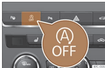
Fig. 136 Console centrale : touche du système Start-Stop.
