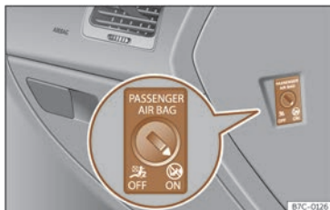
Fig. 15 Commande à clé permettant d'activer et de désactiver les airbags du passager avant.
