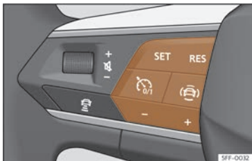
Fig. 149 Sur le volant multifonction : boutons permettant d'actionner le régulateur de vitesse
