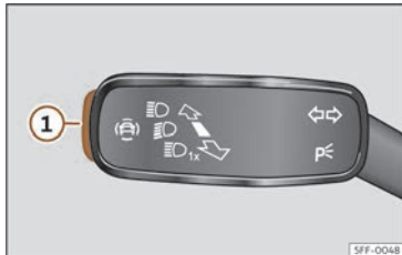
Fig. 57 Sur le levier des clignotants et des feux de route : touche pour les systèmes d'assistance à la conduite (en fonction des versions).
