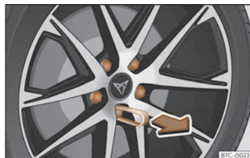
Fig. 32 Roue : boulons de roue avec capuchons.
