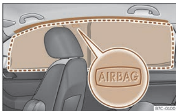
Fig. 21 Emplacement des airbags rideaux.
