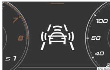
Fig. 151 Sur l'écran du combiné d'instruments : indications d'alerte préventive.
