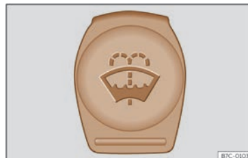
Fig. 202 Dans le compartiment-moteur : bouchon du réservoir de liquide lave-glace.
