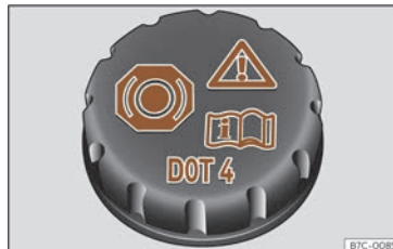
Fig. 201 Compartiment-moteur : bouchon du réservoir du liquide de frein.
