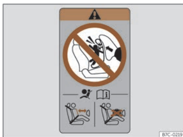
Fig. 24 Autocollant de l'airbag : sur le cadre arrière de la porte du passager avant
