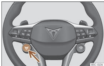
Fig. 142 Volant multifonction : bouton servant à changer le profil de conduite.
