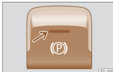
Fig. 168 Sur la partie inférieure de la console centrale : touche du frein de stationnement électronique.
