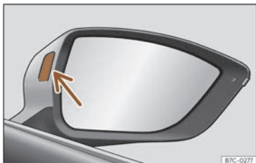
Fig. 164 Voyant de contrôle de l'assistant de changement de voie.
