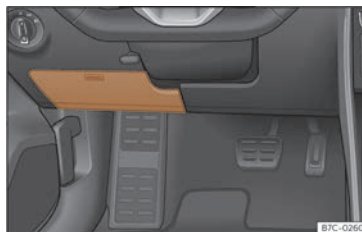
Fig. 45 Véhicules avec volant à gauche : couvercle de boîte à fusibles sous le combiné d'instruments, côté conducteur
