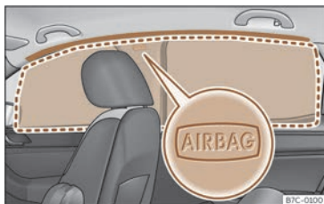
Fig. 21 Emplacement des airbags rideaux.
