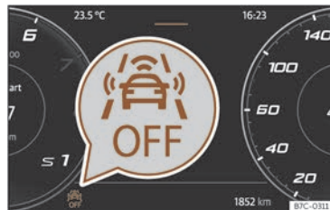
Fig. 154 Sur l'écran du combiné d'instruments : indication de Front Assist désactivé.
