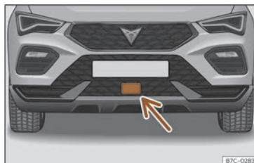
Fig. 145 Au niveau du pare-chocs avant : : capteur radar.
