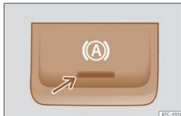
Fig. 171 Sur la partie inférieure de la console centrale : touche de fonction Auto Hold.
