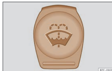
Fig. 205 Dans le compartiment moteur : bouchon bleu du réservoir de liquide lave-glace.
