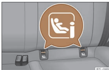
Fig. 25 Banquette arrière : anneaux de fixation ISOFIX/i-Size.
