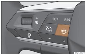
Fig. 58 Partie gauche du volant multifonction : touche pour les systèmes d'assistance à la conduite (en fonction des versions).
