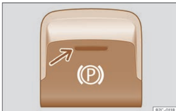
Fig. 170 Sur la partie inférieure de la console centrale : touche du frein de stationnement électronique.
