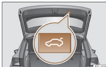
Fig. 78 Hayon : touche de fermeture du hayon
