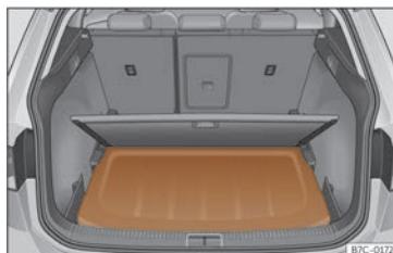
Fig. 109 Dans le coffre à bagages : placement de la plage arrière.
