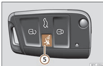
Fig. 66 Clé du véhicule avec bouton d'alarme.
