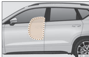
Fig. 20 Airbags latéraux complètement gonflés du côté gauche du véhicule.
