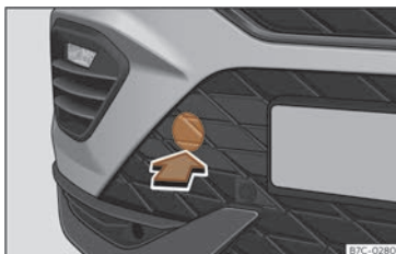
Fig. 41 Du côté droit du pare-chocs avant : retirer le cache.
