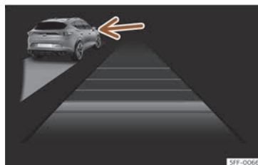
Fig. 158 Sur l'écran du combiné d'instruments : ACC activé, véhicule circulant à gauche détecté
