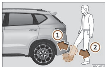
Fig. 80 Hayon du coffre à bagages à ouverture contrôlée par capteur (Easy Open).
