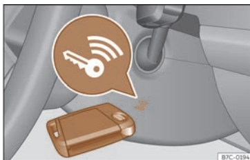
Fig. 137 À droite de la colonne de direction : démarrage d'urgence.
