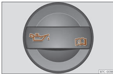
Fig. 201 Dans le compartiment-moteur : bouchon de l'orifice de remplissage d'huile moteur.
