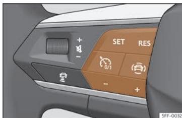
Fig. 151 Sur le volant multifonction : boutons permettant d'actionner le régulateur de vitesse.
