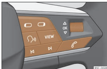
Fig. 56 Partie droite du volant multifonction : touches permettant d'utiliser les menus et les messages d'information du combiné d'instruments (selon les versions).
