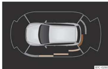
Fig. 181 Affichage du système d'aide au stationnement sur l'écran du système d'infodivertissement.
