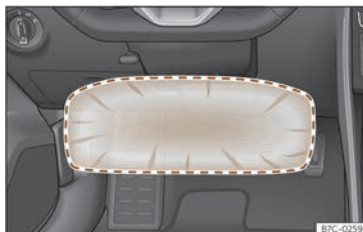
Fig. 18 Côté conducteur : rayon d'action de l'airbag de genoux.
