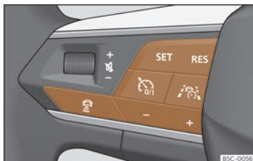
Fig. 164 Partie gauche du volant multifonction : touches de commande de Travel Assist.
