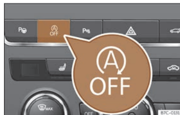
Fig. 138 Console centrale : touche du système Start-Stop.
