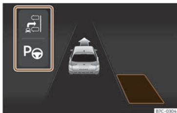
Fig. 174 Sur l'écran du combiné d'instruments : affichage du système de stationnement assisté avec affichage réduit.
