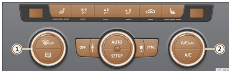
Fig. 125 Sur la console centrale : commandes du Climatronic.
