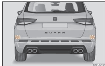
Fig. 148 Vue arrière du véhicule : zones des capteurs radars.
