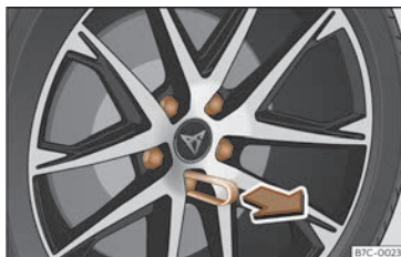
Fig. 32 Roue : boulons de roue avec capuchons.
