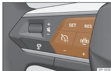
Fig. 107 Sur le volant multifonction : boutons permettant d'actionner le régulateur de vitesse.
