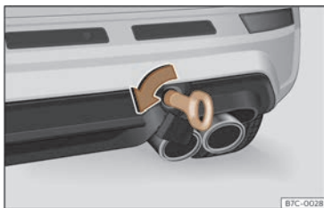
Fig. 186 Du côté droit du pare-chocs arrière : œillet de remorquage vissé.
