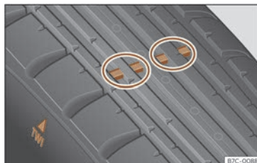
Fig. 203 Sculpture du pneu : indicateurs d'usure.
