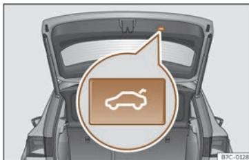
Fig. 55 Hayon arrière : touche de fermeture du hayon.
