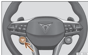
Fig. 97 Volant multifonction : bouton servant à changer le profil de conduite.
