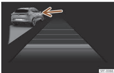
Fig. 111 Sur l'écran du combiné d'instruments : ACC activé, véhicule circulant à gauche détecté.
