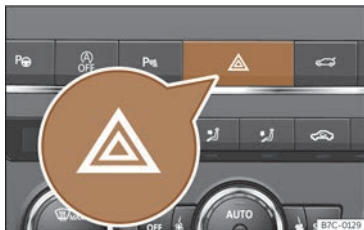
Fig. 40 Combiné d'instruments : interrupteur des feux de détresse.
