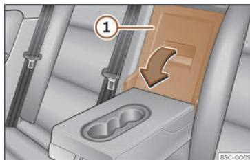
Fig. 168 Dans le dossier de la banquette arrière : ouverture de la trappe de chargement.
