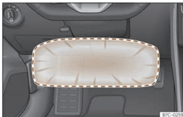
Fig. 31 Du côté conducteur : rayon d'action de l'airbag de genoux.
