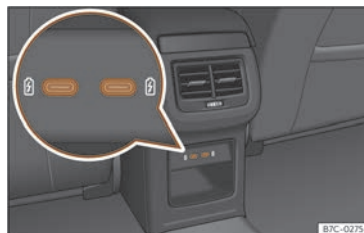
Fig. 150 Partie arrière de la console centrale : connecteurs USB avec fonction de prise de courant.
