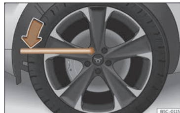
Fig. 209 Changement de roue : desserrer les boulons de la roue.
