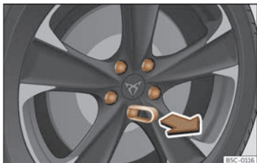
Fig. 207 Roue : boulons de la roue avec capuchons.
