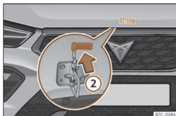
Fig. 192 Levier sous le capot.
