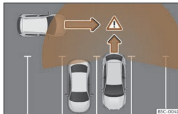
Fig. 143 Représentation schématique de l'assistant de sortie de stationnement : zone surveillée autour du véhicule qui sort du stationnement.
