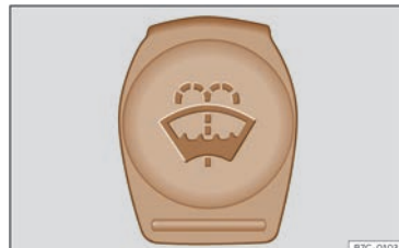
Fig. 196 Dans le compartiment moteur : bouchon bleu du réservoir du liquide lave-glace.
