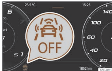
Fig. 116 Sur l'écran du combiné d'instruments : indication du Front Assist désactivé.
