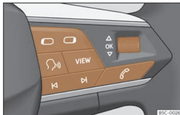
Fig. 8 Côté droit du volant multifonction : touches permettant d'utiliser les menus et les messages d'information du combiné d'instruments (selon les versions).
