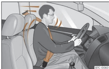
Fig. 15 Les conducteurs qui ont correctement bouclé leur ceinture de sécurité ne seront pas projetés en cas de freinage soudain.
