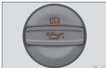
Fig. 200 Dans le compartiment-moteur : couvercle de l'orifice de remplissage d'huile moteur.
