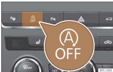
Fig. 91 Console centrale : touche du système Start-Stop.
