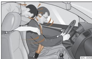
Fig. 18 L'occupant de la banquette arrière non attaché est projeté en avant et vient heurter le conducteur attaché.
