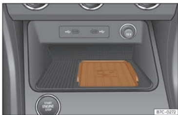
Fig. 156 Sur la console centrale : logement de connexion du téléphone mobile.
