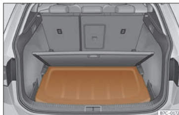
Fig. 160 Dans le coffre à bagages : pose de la plage arrière.
