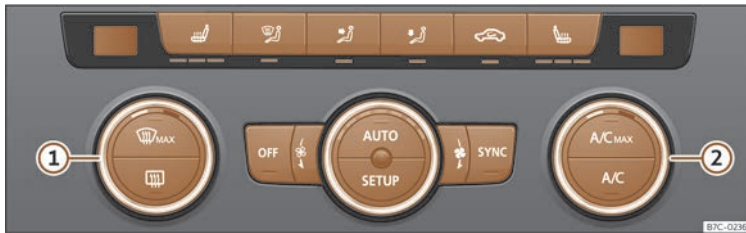
Fig. 86 Sur la console centrale : commandes du Climatronic.
