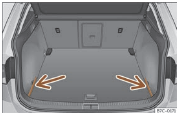
Fig. 159 Dans le coffre à bagages : caches de rangement de la plage arrière.
