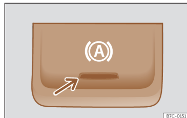
Fig. 125 Dans la partie inférieure de la console centrale : touche de fonction Auto Hold.
