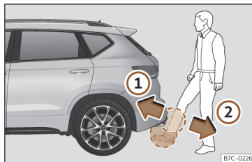
Fig. 57 Hayon du coffre à bagages à ouverture contrôlée par capteur (Easy Open).
