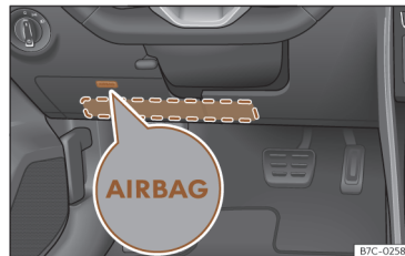
Fig. 30 Du côté conducteur : emplacement de l'airbag de genoux.
