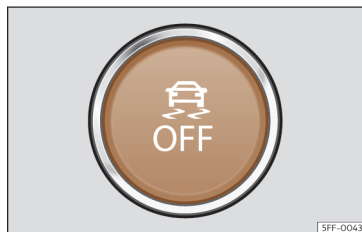
Fig. 98 Dans la partie inférieure de la console centrale : touche d'activation/désactivation de l'ESC.
