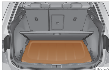
Fig. 161 Dans le coffre à bagages : pose de la plage arrière.
