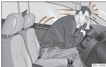
Fig. 17 Le conducteur n'ayant pas bouclé sa ceinture sera projeté en avant.
