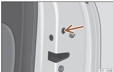
Fig. 52 Verrouillage d'urgence de la porte.
