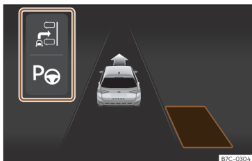
Fig. 132 Sur l'écran du combiné d'instruments : affichage du système de stationnement assisté avec affichage réduit.
