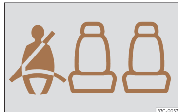
Fig. 16 Combiné d'instruments : indication de l'état des ceintures de sécurité des sièges arrière.
