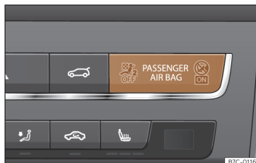
Fig. 26 Combiné d'instruments : témoin de contrôle de désactivation de l'airbag passager avant.
