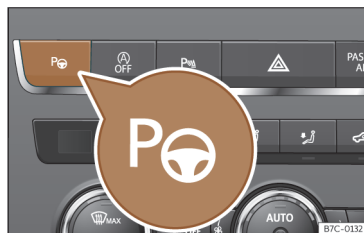
Fig. 131 Sur la partie supérieure de la console centrale : touche pour activer le système de stationnement assisté.
