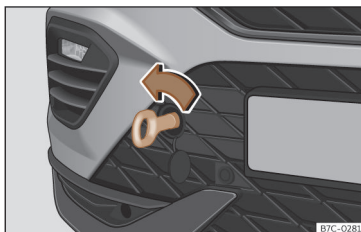
Fig. 185 Partie droite du pare-chocs avant : œillet de remorquage vissé.
