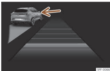
Fig. 112 Sur l'écran du combiné d'instruments : ACC activé, véhicule circulant à gauche détecté.
