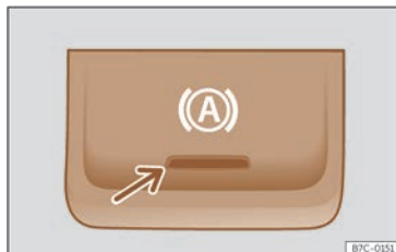
Fig. 128 Dans la partie inférieure de la console centrale : touche de fonction Auto Hold.
