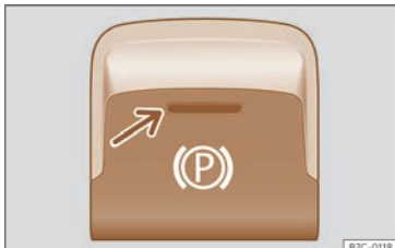
Fig. 127 Dans la partie inférieure de la console centrale : touche du frein de stationnement électronique.
