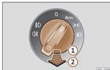
Fig. 79 Tableau de bord : commande des feux.
