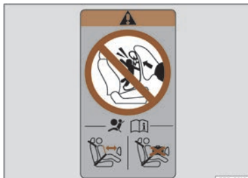
Fig. 34 Autocollant de l'airbag : sur le cadre arrière de la porte du passager avant.
