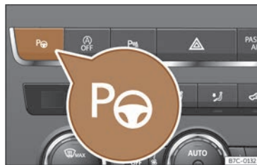
Fig. 134 Sur la partie supérieure de la console centrale : touche pour activer le système de stationnement assisté.
