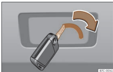
Fig. 59 Détail du coffre à bagages : déverrouillage d'urgence.
