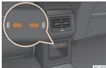
Fig. 154 Partie arrière de la console centrale : connecteurs USB avec fonction de prise de courant.
