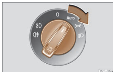
Fig. 78 Tableau de bord : commande des feux.
