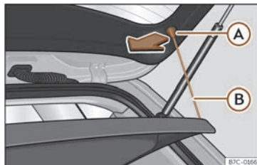
Fig. 161 Dans le coffre à bagages : démonter et remonter la plage arrière.
