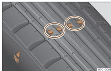
Fig. 207 Sculpture du pneu : indicateurs d'usure.
