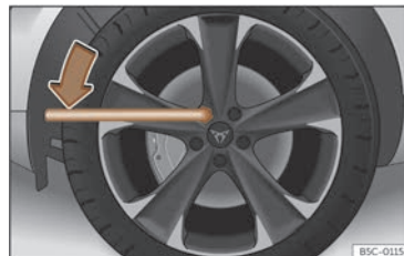
Fig. 213 Changement de roue : desserrer les boulons de la roue.
