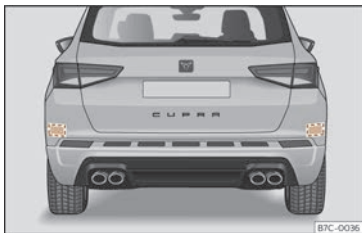
Fig. 104 Vue arrière du véhicule : zones des capteurs radar.
