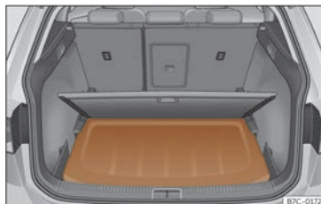
Fig. 164 Dans le coffre à bagages : pose de la plage arrière.
