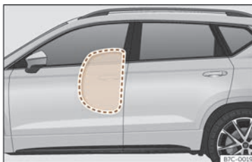
Fig. 28 Airbag latéral complètement gonflé du côté gauche du véhicule.
