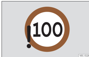
Fig. 7 Sur l'écran du combiné d'instruments : détection d'un dépassement de la vitesse maximale autorisée (illustration).
