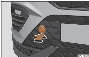
Fig. 187 Du côté droit du pare-chocs avant : retirer le cache.
