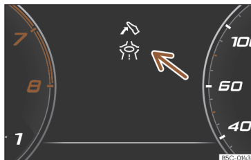
Fig. 108 Indication de l'aide à l'éco-conduite (représentation schématique).
