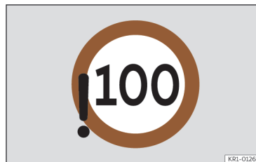
Fig. 6 Sur l'écran du combiné d'instruments : détection d'un dépassement de la vitesse maximale autorisée (illustration).
