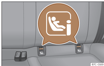
Fig. 34 Siège arrière : emplacement des anneaux de fixation ISOFIX ou i-Size.
