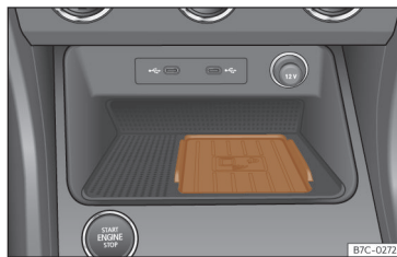
Fig. 160 Sur la console centrale : logement de connexion du téléphone mobile.
