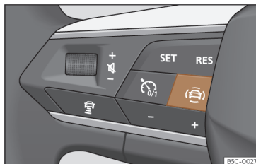
Fig. 99 Côté gauche du volant multifonction : touche pour les systèmes d'aide à la conduite (selon les versions).
