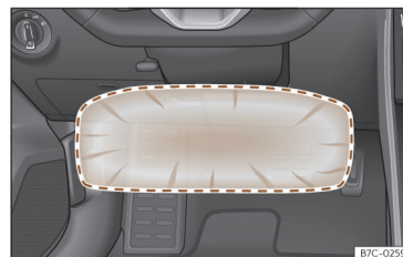
Fig. 30 Du côté conducteur : rayon d'action de l'airbag de genoux.
