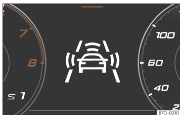
Fig. 116 Sur l'écran du combiné d'instruments : indications d'alerte préventive.
