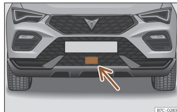
Fig. 100 Dans le pare-chocs avant : capteur radar.
