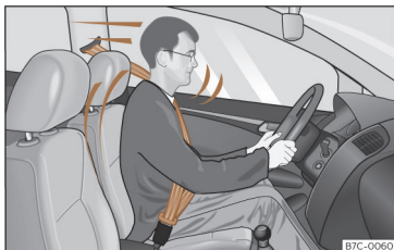
Fig. 14 Les conducteurs qui ont correctement bouclé leur ceinture de sécurité ne seront pas projetés en cas de freinage soudain.
