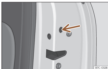
Fig. 51 Verrouillage d'urgence de la porte.
