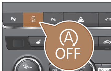
Fig. 90 Console centrale : touche du système Start-Stop.
