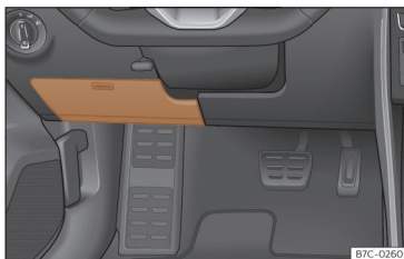
Fig. 191 Sous le combiné d'instruments côté conducteur : couvercle de la boîte à fusibles.
