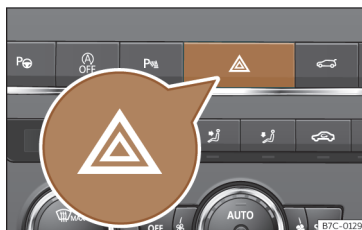
Fig. 39 Combiné d'instruments : interrupteur des feux de détresse.
