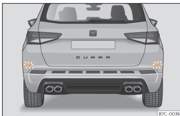
Fig. 103 Vue arrière du véhicule : zones des capteurs radar.
