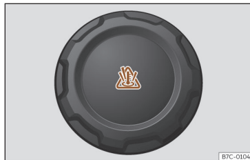
Fig. 198 Compartiment avant : bouchon du vase d'expansion du liquide de refroidissement.
