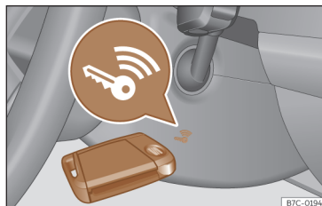
Fig. 89 À droite de la colonne de direction >>> fig. 89, le plus proche possible du démarrage d'urgence.
