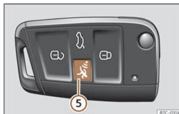
Fig. 42 Clé du véhicule avec bouton d'alarme.
