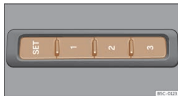
Fig. 73 Sur le côté extérieur du siège conducteur : touches de mémoire.
