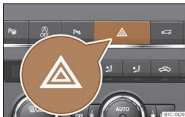
Fig. 39 Combiné d'instruments : interrupteur des feux de détresse.
