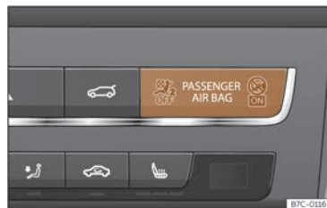
Fig. 25 Combiné d'instruments : témoin de contrôle de désactivation de l'airbag passager avant.
