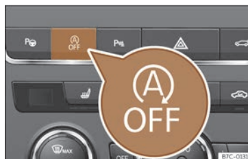
Fig. 90 Console centrale : touche du système Start-Stop.
