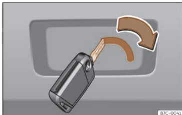
Fig. 58 Détail du coffre à bagages : déverrouillage d'urgence.
