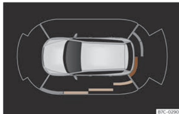
Fig. 131 Affichage du système d'aide au stationnement à l'écran du système d'infodivertissement.
