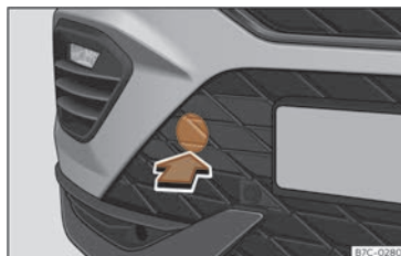
Fig. 189 Du côté droit du pare-chocs avant : retirer le cache.
