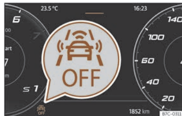
Fig. 118 Sur l'écran du combiné d'instruments : indication du Front Assist désactivé.
