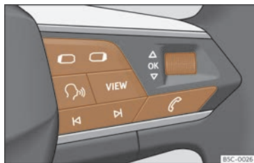
Fig. 7 Côté droit du volant multifonction : touches permettant d'utiliser les menus et les messages d'information du combiné d'instruments (selon les versions).
