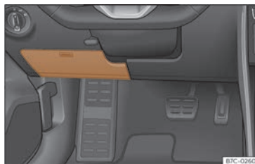
Fig. 193 Sous le combiné d'instruments côté conducteur : couvercle de la boîte à fusibles.
