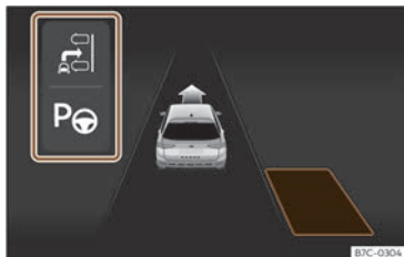
Fig. 134 Sur l'écran du combiné d'instruments : affichage du système de stationnement assisté avec affichage réduit.
