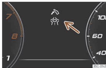
Fig. 108 Indication de l'aide à l'éco-conduite (représentation schématique).
