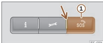
Fig. 40 Sur la console de pavillon : commandes pour les services vocaux
