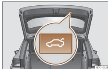
Fig. 54 Hayon arrière : touche de fermeture du hayon.
