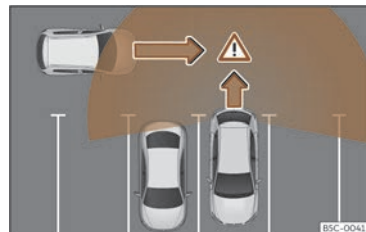
Fig. 146 Représentation schématique de l'assistant de sortie de stationnement : zone surveillée autour du véhicule qui sort du stationnement.
