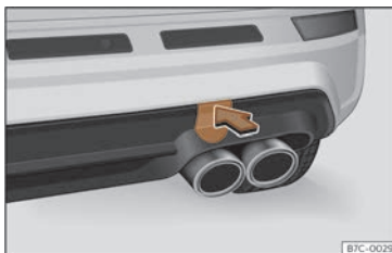
Fig. 191 Du côté droit du pare-chocs arrière : retirer le cache.
