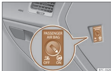
Fig. 24 Commande à clé permettant d'activer et de désactiver l'airbag passager avant.
