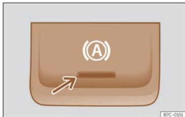
Fig. 127 Dans la partie inférieure de la console centrale : touche de fonction Auto Hold.
