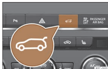
Fig. 55 Console centrale : touche d'ouverture et de fermeture du hayon arrière.
