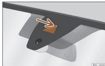
Fig. 102 Sur le pare-brise : aire de champ visuel de l'assistant de maintien de voie.
