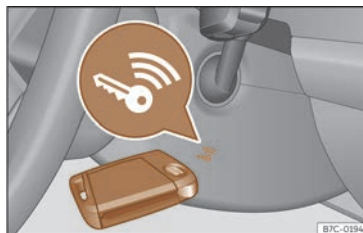
Fig. 89 À droite de la colonne de direction : démarrage d'urgence.
