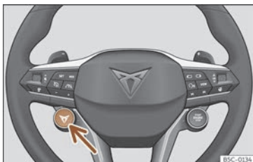
Fig. 96 Volant multifonction : bouton servant à changer le profil de conduite.
