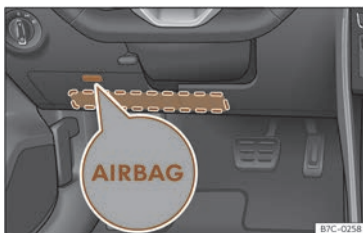
Fig. 29 Du côté conducteur : emplacement de l'airbag de genoux.
