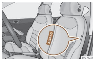
Fig. 26 Airbag latéral dans le siège du conducteur.
