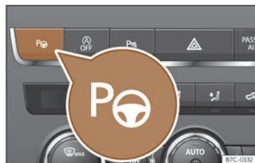
Fig. 133 Sur la partie supérieure de la console centrale : touche pour activer le système de stationnement assisté.
