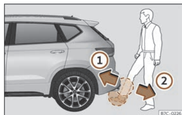
Fig. 56 Hayon du coffre à bagages à ouverture contrôlée par capteur (Easy Open).
