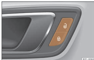
Fig. 48 Sur la portière du conducteur : bouton du verrouillage centralisé.
