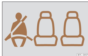
Fig. 15 Combiné d'instruments : indication de l'état des ceintures de sécurité des sièges arrière.
