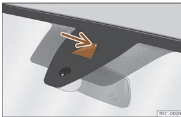
Fig. 111 Sur le pare-brise : aire de champ visuel de l'assistant de maintien de voie.
