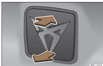
Fig. 78 Hayon arrière : ouverture de l'extérieur.
