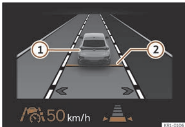
Fig. 117 Sur l'écran du tableau de bord : ACC actif.
