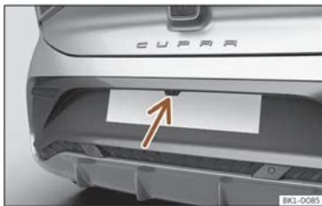
Fig. 114 Sur le pare-chocs arrière : emplacement de la caméra de l'assistant de marche arrière.
