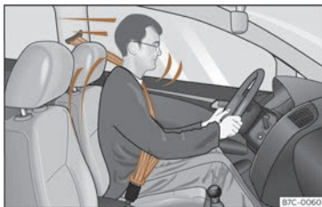
Fig. 16 Les conducteurs qui ont correctement bouclé leur ceinture de sécurité ne seront pas projetés en cas de freinage soudain.
