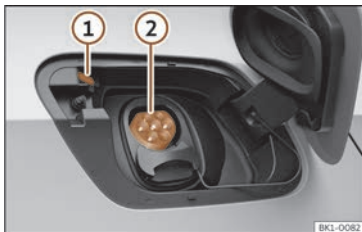
Fig. 56 Derrière le cache de chargement de la batterie sur la partie arrière droite : Prise de charge.
