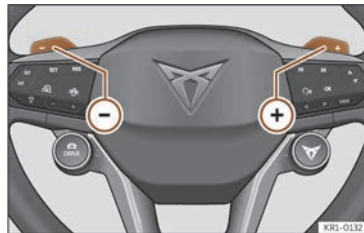
Fig. 107 Volant multifonction : leviers pour la récupération d'énergie.
