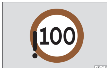
Fig. 8 Sur l'écran du combiné d'instruments : détection d'un dépassement de la vitesse maximale autorisée (illustration).
