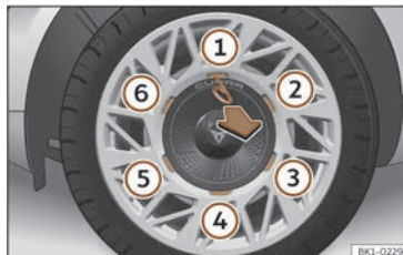
Fig. 192 Changement de roue : démonter l'enjoliveur central.
