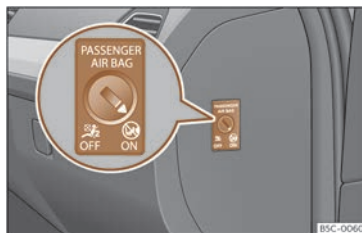
Fig. 26 Commande à clé permettant d'activer et de désactiver l'airbag du passager avant.
