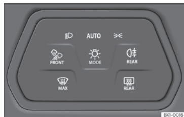
Fig. 93 Tableau de bord : commande des feux.
