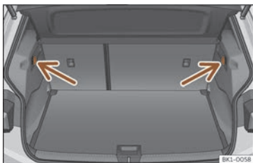
Fig. 167 Dans le coffre à bagages : crochets pour sacs.
