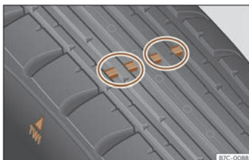
Fig. 190 Sculpture du pneu : indicateurs d'usure.
