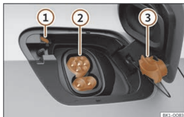
Fig. 58 Derrière la trappe de la prise de charge de la batterie, à l'arrière droit : prise de charge.
