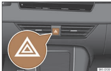
Fig. 45 Combiné d'instruments : interrupteur des feux de détresse.
