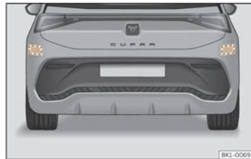
Fig. 112 Vue arrière du véhicule : zones des capteurs radar.
