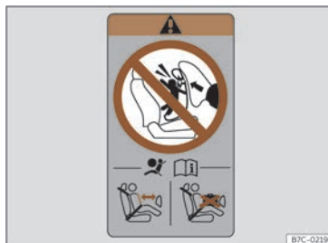
Fig. 35 Autocollant de l'airbag : sur le cadre arrière de la porte passager avant.
