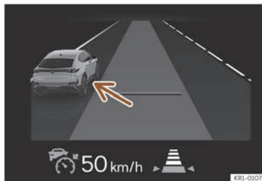
Fig. 119 Sur l'écran du combiné d'instruments : ACC activé, véhicule circulant à gauche détecté.
