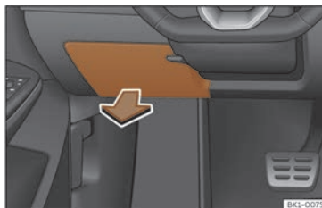
Fig. 179 Sous le combiné d'instruments côté conducteur : couvercle de la boîte à fusibles.
