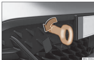
Fig. 178 Partie droite du pare-chocs avant : œillet de remorquage vissé.
