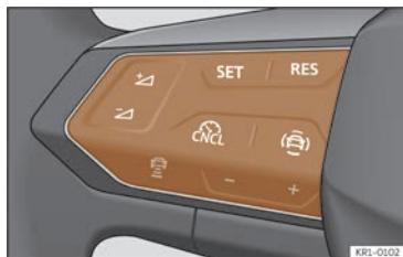
Fig. 118 Sur le volant multifonction : bouton de commande de l'ACC.
