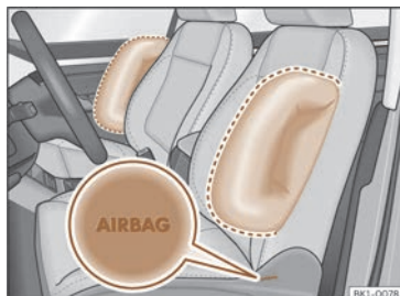
Fig. 30 Airbag latéral sur le siège du conducteur et du passager avant.
