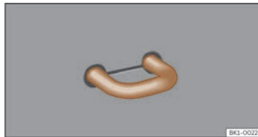
Fig. 166 Dans le coffre à bagages : œillet d'arrimage.
