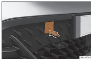
Fig. 177 Du côté droit du pare-chocs avant : retirer le cache.
