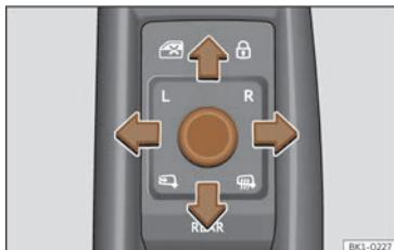
Fig. 99 Détail de la portière du conducteur : commande du rétroviseur extérieur.
