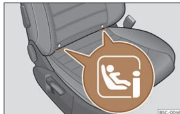
Fig. 37 Siège passager avant : emplacement des anneaux de fixation i-Size.
