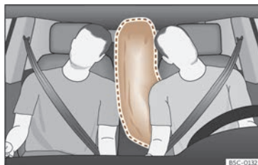
Fig. 29 Airbag central complètement gonflé (zone de déploiement).
