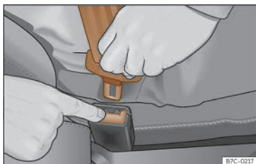
Fig. 21 Relâcher le pêne du boîtier de verrouillage de la ceinture.
