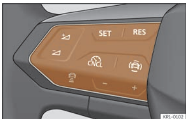
Fig. 115 Sur le volant multifonction : boutons permettant d'actionner le limiteur de vitesse.
