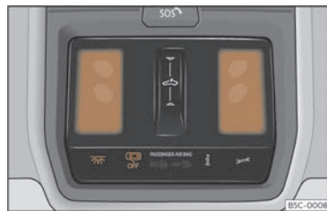
Fig. 95 Détail du revêtement du toit : éclairage avant de l'habitacle.
