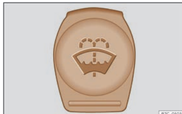
Fig. 188 Dans le compartiment avant : bouchon bleu du réservoir de liquide lave-glace.
