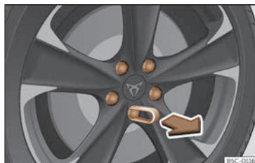
Fig. 193 Roue : boulons de la roue avec capuchons.
