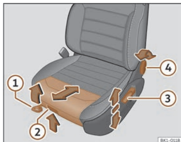
Fig. 84 Sièges avant : réglage manuel du siège.
