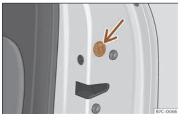
Fig. 76 Verrouillage d'urgence de la porte.
