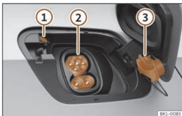
Fig. 59 Derrière la trappe de la prise de charge de la batterie, à l'arrière droit : prise de charge.
