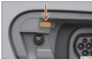
Fig. 60 Sous la trappe de la prise de charge de la batterie : indicateur de l'opération de charge.
