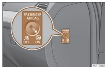
Fig. 28 Commande à clé permettant d'activer et de désactiver l'airbag du passager avant.
