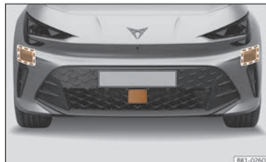
Fig. 112 Dans le pare-chocs avant : capteurs radar avant et latéraux.
