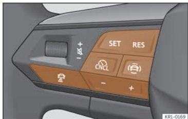
Fig. 122 Sur le volant multifonction : bouton de commande de l'ACC.
