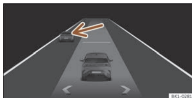
Fig. 123 Sur l'écran du tableau de bord : ACC activé, véhicule circulant à gauche détecté.
