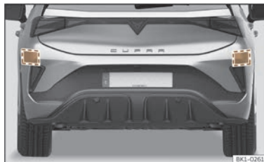
Fig. 115 Vue arrière du véhicule : zones des capteurs radar.
