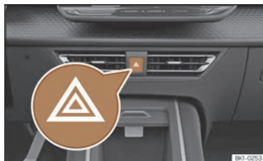
Fig. 47 Combiné d'instruments : interrupteur des feux de détresse.
