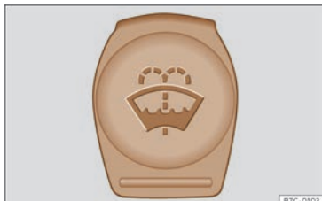
Fig. 204 Dans le compartiment avant : bouchon bleu du réservoir de liquide lave-glace.
