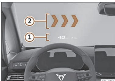
Fig. 4 Dans le champ de vision du conducteur : Affichage tête haute de proximité ① et Affichage tête haute RA ②.
