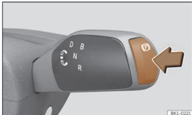
Fig. 138 Sur le sélecteur de vitesses : la touche de frein de stationnement électronique.
