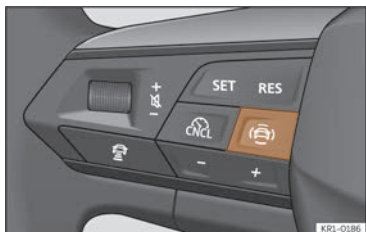
Fig. 111 Côté gauche du volant multifonction : touche pour les systèmes d'aide à la conduite (selon les versions).
