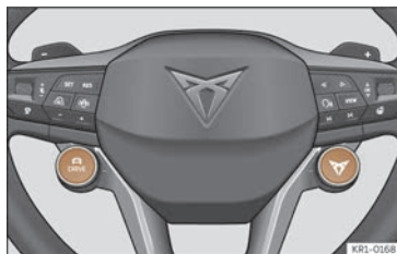
Fig. 110 Volant multifonction : Boutons DRIVE et CUPRA pour sélectionner et changer le profil de conduite.
