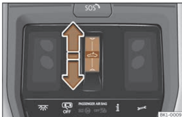
Fig. 103 Sur le revêtement intérieur du toit : bouton de fonction du store pare-soleil.
