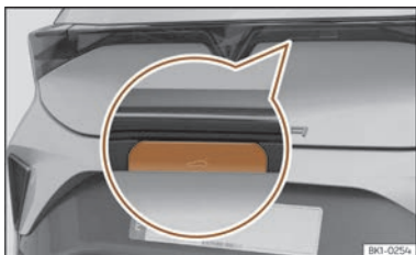
Fig. 80 Hayon arrière : ouverture de l'extérieur.
