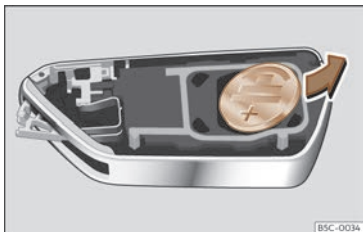
Fig. 71 Clé du véhicule : retirer la pile.
