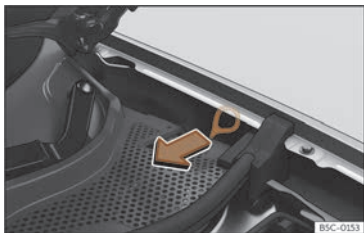
Fig. 201 Entre l'aile gauche et la charnière du capot du moteur : Poignée de déverrouillage manuel d'urgence du connecteur de charge.
