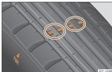
Fig. 224 Sculptures du pneu : indicateurs d'usure.
