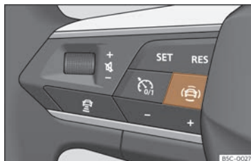
Fig. 63 Partie gauche du volant multifonction : touche pour les systèmes d'assistance à la conduite (en fonction des versions).
