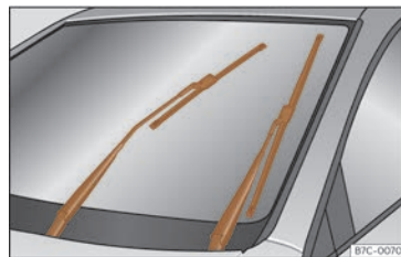
Fig. 41 Essuie-glace en position d'entretien.
