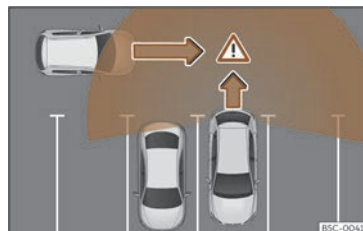
Fig. 174 Représentation schématique de l'assistant de sortie de stationnement : zone surveillée autour du véhicule sortant de stationnement.
