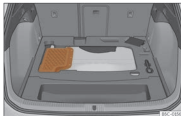
Fig. 221 Véhicules hybrides (PHEV) : emplacement de la batterie dans le coffre à bagages
