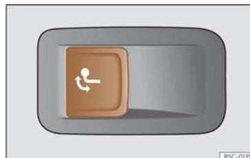
Fig. 192 Sur le côté gauche du coffre à bagages : touche de déverrouillage du crochet d'attelage.
