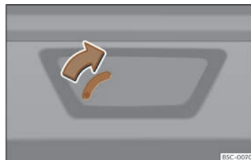
Fig. 88 Détail du coffre à bagages : déverrouillage d'urgence.
