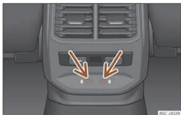
Fig. 142 Partie arrière de la console centrale : connecteurs USB avec fonction de prise de courant.
