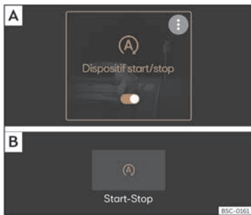
Fig. 145 Sur l'écran du système d'infodivertissement : système Start-Stop activé. A Vue dans le menu principal. B Vue avec le système d'infodivertissement éteint.
