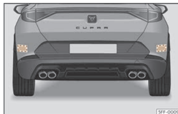
Fig. 153 Vue arrière du véhicule : zones des capteurs radars.
