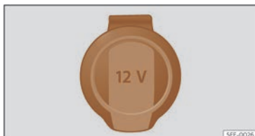
Fig. 129 Prise de courant de 12 volts : ① à l'intérieur de l'accoudoir avant.
