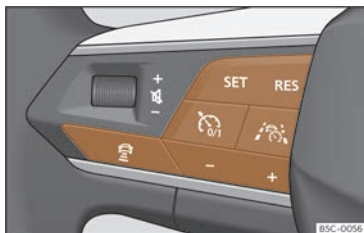
Fig. 169 Partie gauche du volant multifonction : touches de commande de Travel Assist.
