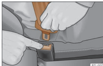
Fig. 10 Relâcher la languette du boîtier de verrouillage la fermeture de la ceinture.
