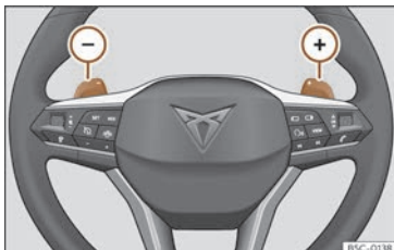
Fig. 148 Volant : palettes pour boîte automatique.
