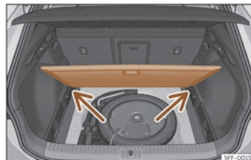
Fig. 118 Plancher de coffre à bagages modulable : position inclinée.
