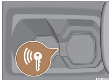
Fig. 144 Sur la console centrale : démarrage d'urgence.
