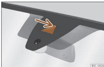
Fig. 152 Sur le pare-brise : fenêtre de l'assistant de maintien de voie.
