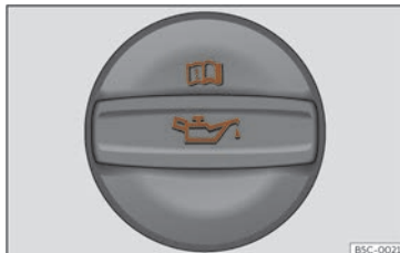
Fig. 215 Dans le compartiment-moteur : bouchon de l'orifice de remplissage d'huile moteur.
