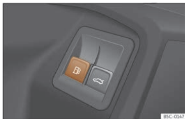
Fig. 205 Porte du conducteur : Déverrouillage de la trappe du réservoir.
