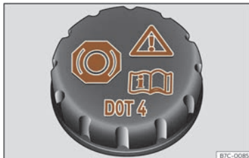
Fig. 219 Compartiment-moteur : bouchon du réservoir du liquide de frein.
