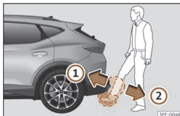
Fig. 86 Hayon du coffre à bagages à ouverture contrôlée par capteur (Easy Open).
