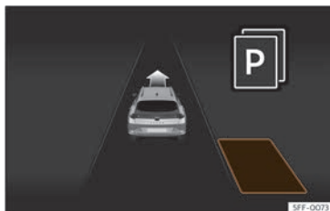
Fig. 180 Sur l'écran du combiné d'instruments : affichage du système de stationnement assisté avec affichage réduit.
