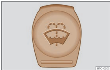
Fig. 220 Dans le compartiment moteur : bouchon bleu du réservoir de liquide lave-glace.
