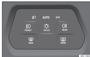
Fig. 92 Combiné d'instruments : commande des feux.
