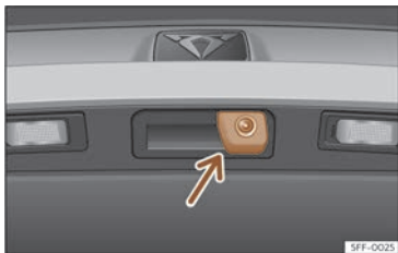
Fig. 155 Sur la poignée du hayon : emplacement de la caméra de l'assistant de marche arrière.
