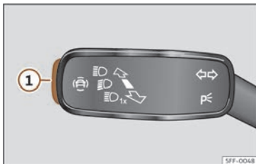
Fig. 125 Dans le levier des clignotants et de feu de route : touche pour les systèmes d'aide à la conduite (selon les versions).
