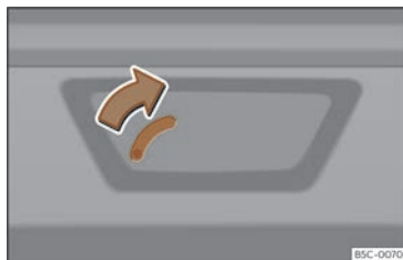
Fig. 84 Détail du coffre à bagages : déverrouillage d'urgence.
