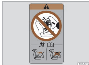
Fig. 39 Autocollant de l'airbag : sur le cadre arrière de la porte du passager avant.
