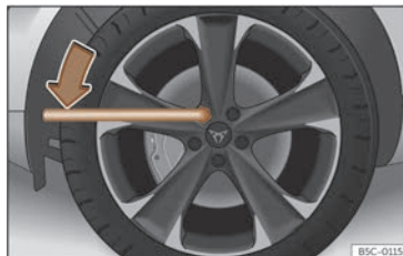
Fig. 236 Changement de roue : desserrer les boulons de la roue.
