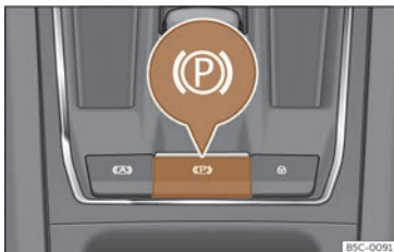
Fig. 154 Dans la partie inférieure de la console centrale : touche du frein de stationnement électronique.
