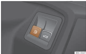
Fig. 202 Porte du conducteur : Déverrouillage de la trappe du réservoir.
