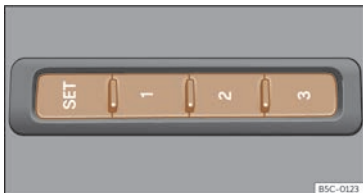
Fig. 100 Sur le côté extérieur du siège conducteur : touches de mémoire.
