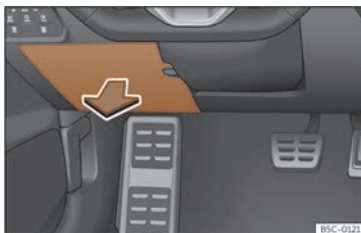
Fig. 213 Sous le combiné d'instruments côté conducteur : couvercle de la boîte à fusibles.
