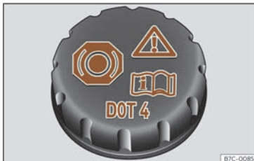
Fig. 221 Compartiment avant : bouchon du réservoir du liquide de frein.
