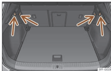
Fig. 192 Dans le coffre à bagages : crochets pour sacs.
