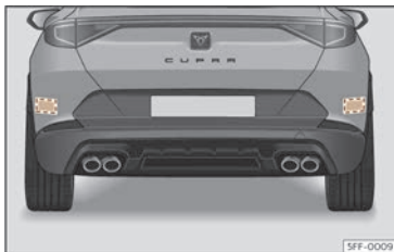
Fig. 130 Vue arrière du véhicule : zones des capteurs radar.
