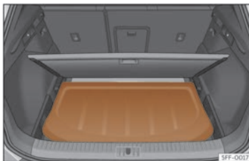
Fig. 186 Dans le coffre à bagages : pose de la plage arrière.
