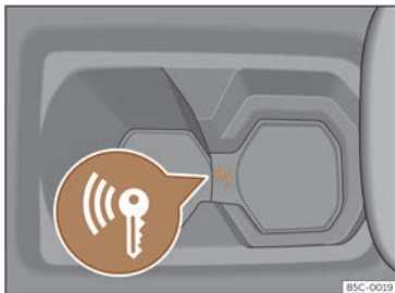
Fig. 118 Dans la console centrale : démarrage d'urgence.
