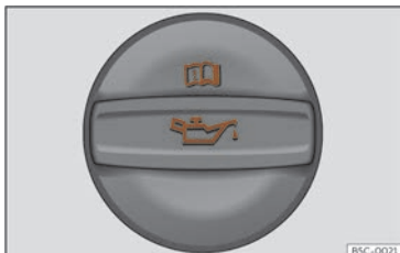
Fig. 226 Dans le compartiment-moteur : couvercle de l'orifice de remplissage d'huile moteur.
