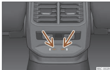
Fig. 176 Partie arrière de la console centrale : connecteurs USB avec fonction de prise de courant.
