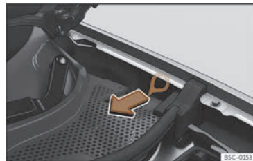
Fig. 63 Entre l'aileron gauche et la charnière du capot du moteur : Poignée de déverrouillage manuel d'urgence du connecteur de charge.
