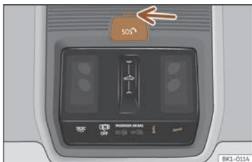
Fig. 51 Sur la console de pavillon : commandes pour les services vocaux.
