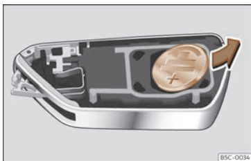
Fig. 71 Clé du véhicule : retirer la pile.
