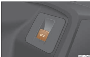
Fig. 81 Sur la porte du conducteur : touche d'ouverture et de fermeture du hayon arrière.
