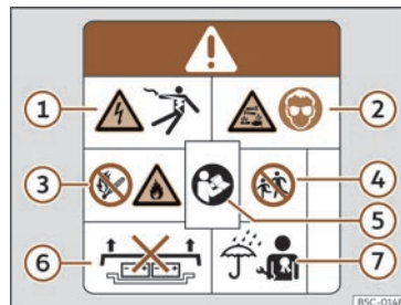
Fig. 56 Étiquette d'avertissement sur la batterie à haute tension.
