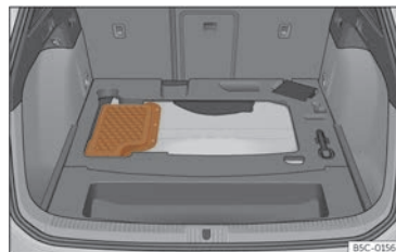
Fig. 227 Véhicules hybrides (PHEV) : emplacement de la batterie dans le coffre à bagages
