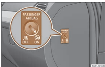
Fig. 28 Commande à clé permettant d'activer et de désactiver l'airbag passager avant.
