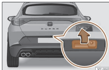
Fig. 79 Hayon arrière : ouverture de l'extérieur.
