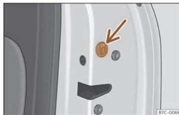
Fig. 77 Verrouillage d'urgence de la porte.
