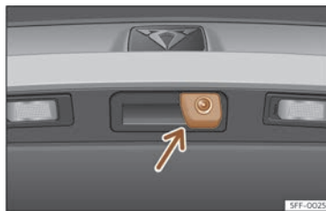
Fig. 132 Sur la poignée du hayon : emplacement de la caméra de l'assistant de marche arrière.
