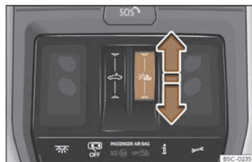
Fig. 88 Sur le revêtement intérieur du toit : commander le store pare-soleil.
