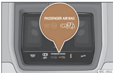
Fig. 29 Dans la console du toit : témoin de contrôle de la désactivation de l'airbag du passager avant.
