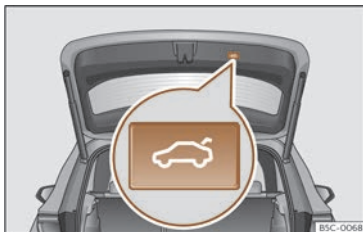
Fig. 80 Hayon arrière : touche de fermeture du hayon.
