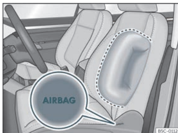
Fig. 21 Airbag latéral dans le siège du conducteur.
