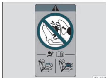
Fig. 26 Autocollant de l'airbag : sur le cadre arrière de la porte du passager avant
