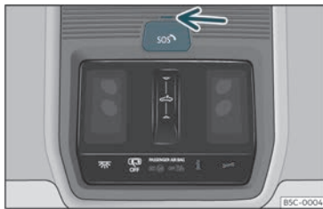
Fig. 32 Sur la console de pavillon : commande pour les services vocaux
