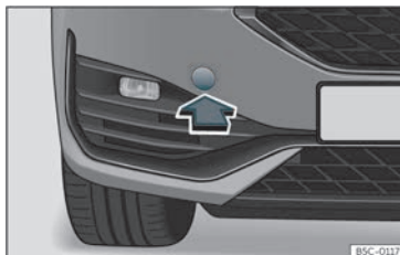
Fig. 43 Du côté droit du pare-chocs avant : retirer le cache.
