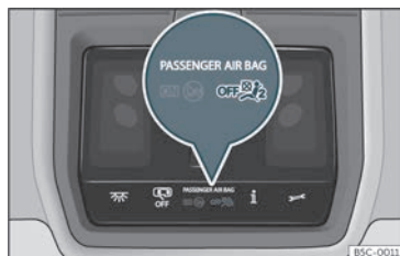
Fig. 16 Sur la console de pavillon : témoin de désactivation de l'airbag du passager avant.
