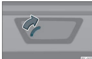
Fig. 85 Détail du coffre à bagages : déverrouillage d'urgence.
