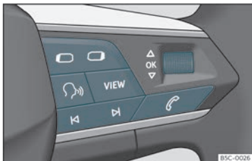
Fig. 60 Partie droite du volant multifonction : touches permettant d'utiliser les menus et les messages d'information du combiné d'instruments.
