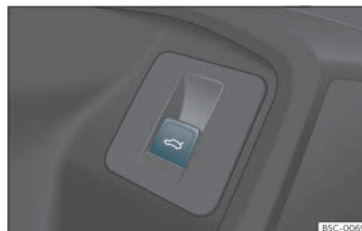
Fig. 83 Sur la porte du conducteur : touche d'ouverture et de fermeture du hayon arrière.
