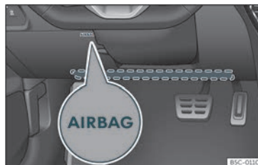
Fig. 17 Côté conducteur : emplacement de l'airbag de genoux.
