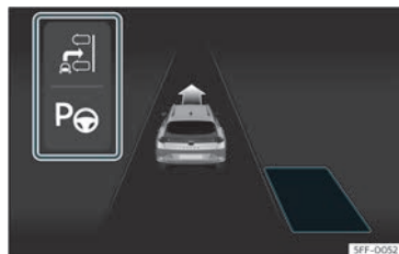
Fig. 178 Sur l'écran du combiné d'instruments : affichage du système de stationnement assisté avec affichage réduit.
