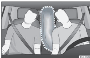
Fig. 20 Airbag central complètement gonflé (zone de déploiement).
