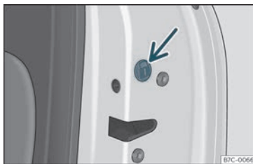
Fig. 79 Verrouillage d'urgence de la porte.
