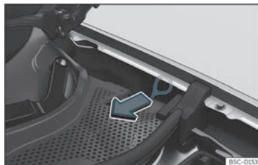
Fig. 194 Entre l'aileron gauche et la charnière du capot du moteur : Poignée de déverrouillage manuel d'urgence du connecteur de charge.
