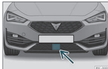
Fig. 148 Au niveau du pare-chocs avant : capteur radar.
