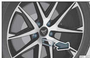
Fig. 35 Roue : boulons de roue avec capuchons.
