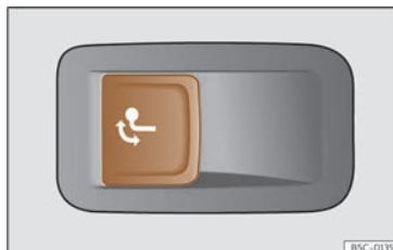
Fig. 195 Sur le côté gauche du coffre à bagages : touche pour déverrouiller le crochet d'attelage.
