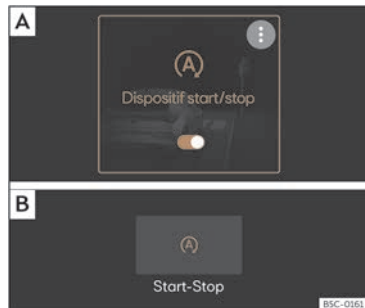
Fig. 113 Sur l'écran du système d'infodivertissement : système Start-Stop connecté. A ) Vue dans le menu principal. B ) Vue avec le système d'infodivertissement éteint.
