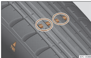
Fig. 227 Sculpture du pneu : indicateurs d'usure.
