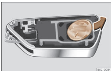
Fig. 67 Clé du véhicule : retirer la pile.
