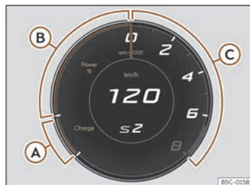
Fig. 7 Combiné d'instruments numérique : Powermeter (vue Cupra)
