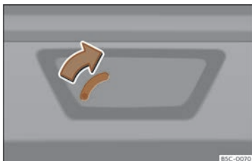
Fig. 80 Détail du coffre à bagages : déverrouillage d'urgence (Leon Sportstourer).
