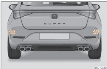
Fig. 124 Vue arrière du véhicule : zones des capteurs radar.
