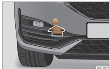
Fig. 206 Du côté droit du pare-chocs avant : retirer le cache.
