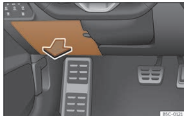
Fig. 210 Sous le combiné d'instruments côté conducteur : couvercle de la boîte à fusibles.
