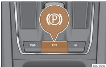
Fig. 145 Dans la partie inférieure de la console centrale : touche du frein de stationnement électronique.
