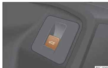
Fig. 77 Sur la porte du conducteur : touche d'ouverture et de fermeture du hayon arrière.
