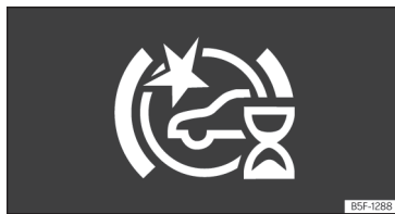
Fig. 135 Sur l'écran du combiné d'instruments : indication de calibrage initial automatique du système.
