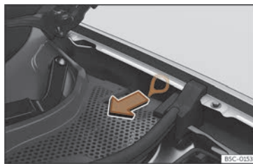
Fig. 59 Entre l'aileron gauche et la charnière du capot du moteur : Poignée de déverrouillage manuel d'urgence du connecteur de charge.
