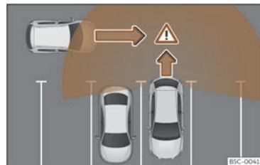
Fig. 155 Représentation schématique de l'assistant de sortie de stationnement : zone surveillée autour du véhicule qui sort du stationnement.
