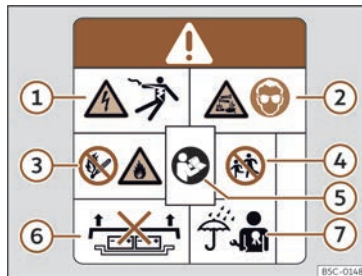
Fig. 53 Étiquette d'avertissement sur la batterie à haute tension.
