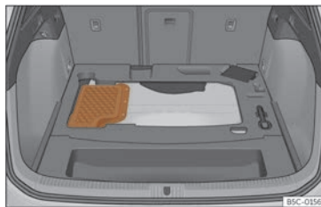
Fig. 224 Véhicules hybrides (PHEV) : emplacement de la batterie dans le coffre à bagages
