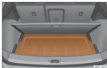
Fig. 174 Dans le coffre à bagages : pose de la plage arrière.
