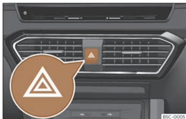
Fig. 49 Combiné d'instruments : interrupteur des feux de détresse.
