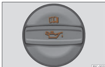
Fig. 223 Dans le compartiment-moteur : couvercle de l'orifice de remplissage d'huile moteur.
