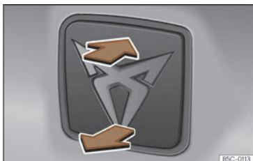
Fig. 75 Hayon arrière : ouverture de l'extérieur.
