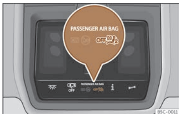
Fig. 30 Dans la console du toit : témoin de contrôle de la désactivation de l'airbag du passager avant.
