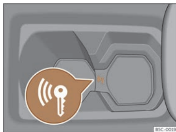
Fig. 112 Dans la console centrale : démarrage d'urgence.
