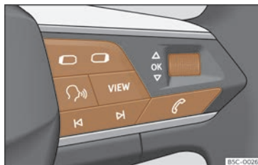
Fig. 11 Côté droit du volant multifonction : touches permettant d'utiliser les menus et les messages d'information du combiné d'instruments (selon les versions).
