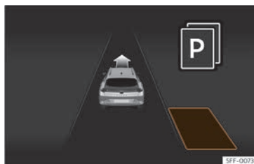
Fig. 149 Sur l'écran du combiné d'instruments : affichage du système de stationnement assisté avec affichage réduit.
