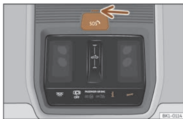
Fig. 50 Sur la console de pavillon : commandes pour les services vocaux.
