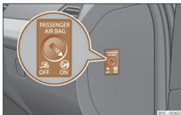
Fig. 29 Commande à clé permettant d'activer et de désactiver l'airbag passager avant.
