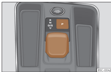
Fig. 115 Sur la console centrale : levier de sélection.
