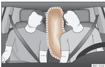
Fig. 32 Airbag central complètement gonflé (zona de déploiement).
