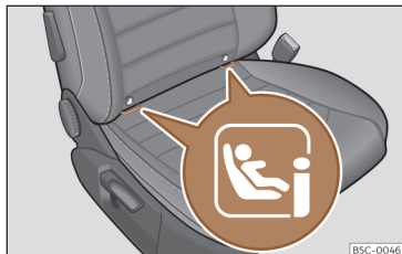
Fig. 42 Sièges passager avant : emplacement des anneaux de fixation i-Size.
