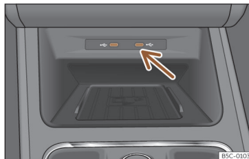
Fig. 163 Console centrale : entrée USB.
