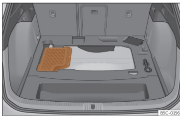
Fig. 225 Véhicules hybrides (PHEV) : emplacement de la batterie dans le coffre à bagages
