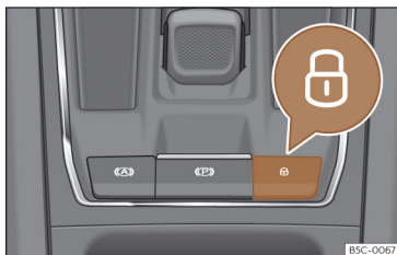
Fig. 71 Sur la console centrale : commutateur de verrouillage centralisé
