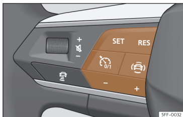
Fig. 127 Sur le volant multifonction : boutons permettant d'actionner le régulateur de vitesse.
