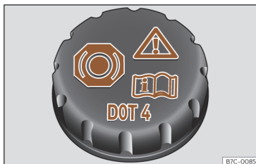
Fig. 219 Compartiment avant : bouchon du réservoir du liquide de frein.
