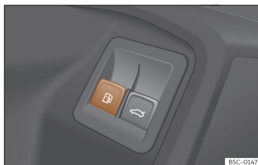
Fig. 200 Porte du conducteur : Déverrouillage de la trappe du réservoir.
