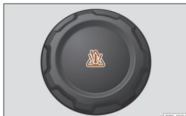
Fig. 218 Compartiment avant : bouchon du vase d'expansion du liquide de refroidissement.
