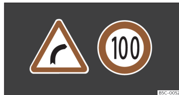
Fig. 9 Sur l'écran du combiné d'instruments : exemples de signaux reconnus.
