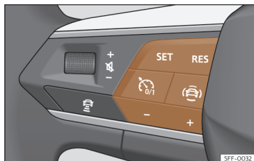
Fig. 128 Sur le volant multifonction : boutons permettant d'actionner le limiteur de vitesse.
