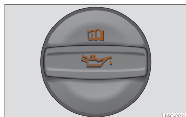
Fig. 224 Dans le compartiment-moteur : couvercle de l'orifice de remplissage d'huile moteur.
