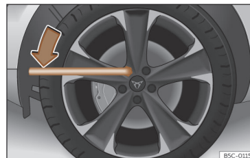
Fig. 235 Changement de roue : desserrer les boulons de la roue.
