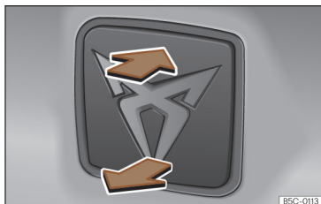
Fig. 75 Hayon arrière : ouverture de l'extérieur.
