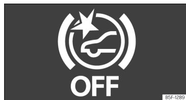
Fig. 136 Sur l'écran du combiné d'instruments : indication du Front Assist désactivé.
