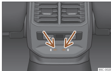
Fig. 164 Partie arrière de la console centrale : connecteurs USB avec fonction de prise de courant.
