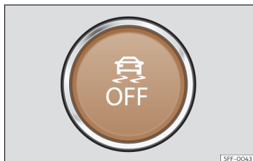
Fig. 118 Dans la partie inférieure de la console centrale : touche d'activation/désactivation de l'ESC.
