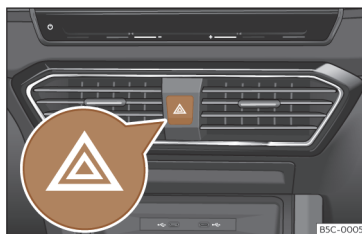
Fig. 49 Combiné d'instruments : interrupteur des feux de détresse.
