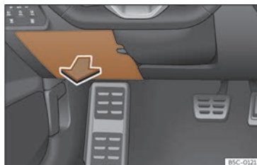
Fig. 219 Sous le combiné d'instruments côté conducteur : couvercle de la boîte à fusibles.
