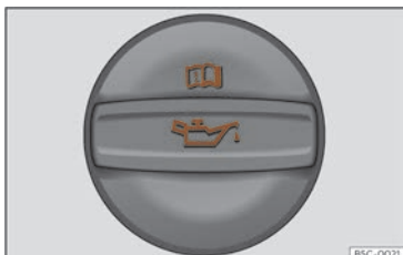
Fig. 232 Dans le compartiment-moteur : couvercle de l'orifice de remplissage d'huile moteur.
