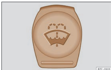
Fig. 228 Dans le compartiment avant : bouchon bleu du réservoir de liquide lave-glace.
