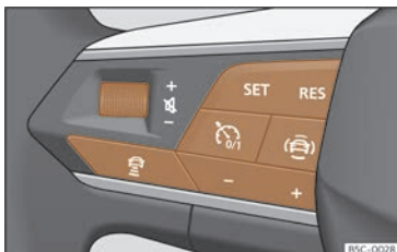
Fig. 136 Sur le volant multifonction : bouton de commande de l'ACC.
