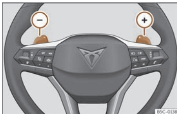
Fig. 121 Volant : leviers pour boîte automatique.
