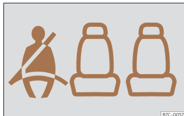
Fig. 19 Combiné d'instruments : indication de l'état des ceintures de sécurité des sièges arrière.
