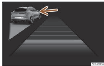
Fig. 137 Sur l'écran du combiné d'instruments : ACC activé, véhicule circulant à gauche détecté.
