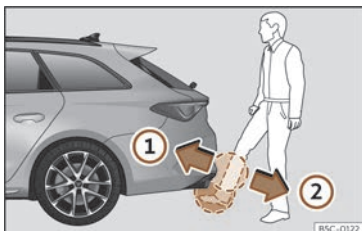
Fig. 82 Hayon du coffre à bagages à ouverture contrôlée par capteur (Easy Open).
