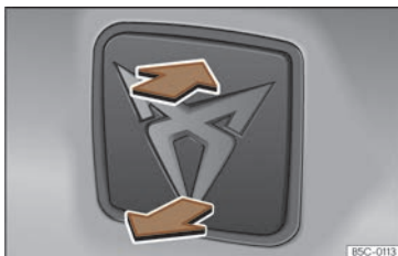
Fig. 79 Hayon arrière : ouverture de l'extérieur.
