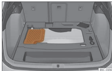
Fig. 233 Véhicules hybrides (PHEV) : emplacement de la batterie dans le coffre à bagages
