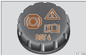
Fig. 227 Compartiment avant : bouchon du réservoir du liquide de frein.
