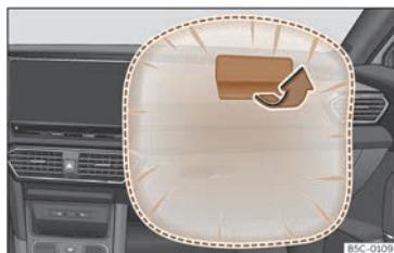
Fig. 27 Airbag du passager avant sur le combiné d'instruments.
