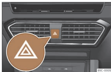
Fig. 50 Combiné d'instruments : commande des feux de détresse.
