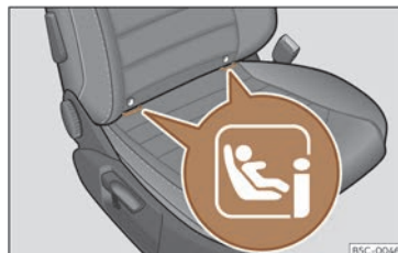
Fig. 41 Siège passager avant : emplacement des anneaux de fixation i-Size.
