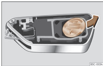
Fig. 71 Clé du véhicule : retirer la pile.
