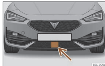
Fig. 126 Dans le pare-chocs avant : capteur radar.
