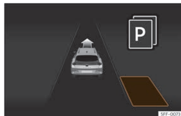
Fig. 157 Sur l'écran du combiné d'instruments : affichage du système de stationnement assisté avec affichage réduit.
