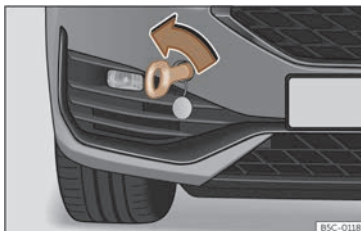
Fig. 216 Partie droite du pare-chocs avant : œillet de remorquage vissé.
