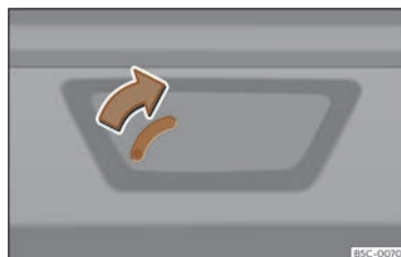
Fig. 84 Détail du coffre à bagages : déverrouillage d'urgence (Leon Sportstourer).
