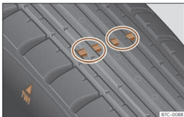
Fig. 237 Sculpture du pneu : indicateurs d'usure.
