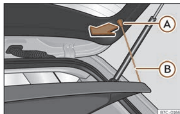
Fig. 179 Dans le coffre à bagages : démonter et remonter la plage arrière.
