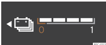
Fig. 5 Combiné d'instruments numérique : indicateur du niveau de batterie.
