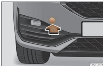
Fig. 215 Du côté droit du pare-chocs avant : retirer le cache.
