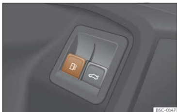
Fig. 208 Porte du conducteur : Déverrouillage de la trappe du réservoir.
