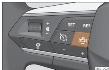
Fig. 125 Côté gauche du volant multifonction : touche pour les systèmes d'aide à la conduite (selon les versions).
