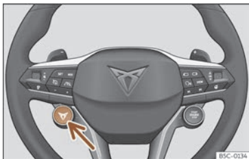
Fig. 122 Volant multifonction : bouton servant à changer le profil de conduite.
