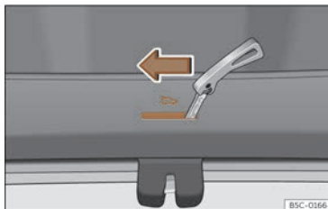
Fig. 83 Détail du coffre à bagages : déverrouillage d'urgence.
