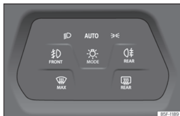
Fig. 104 Tableau de bord : commande des feux.
