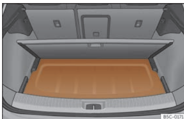
Fig. 182 Dans le coffre à bagages : pose de la plage arrière.
