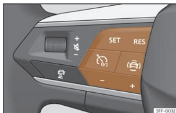
Fig. 133 Sur le volant multifonction : boutons permettant d'actionner le limiteur de vitesse.
