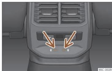
Fig. 172 Partie arrière de la console centrale : connecteurs USB avec fonction de prise de courant.
