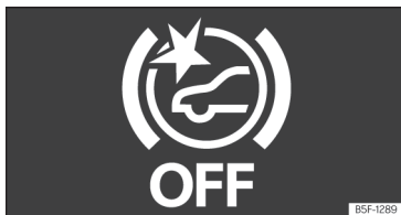
Fig. 144 Sur l'écran du combiné d'instruments : indication du Front Assist désactivé.
