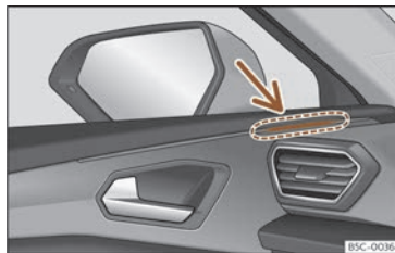
Fig. 149 Voyant de contrôle de l'assistant de changement de voie.
