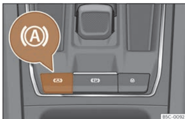
Fig. 154 Dans la partie inférieure de la console centrale : touche de fonction Auto Hold.
