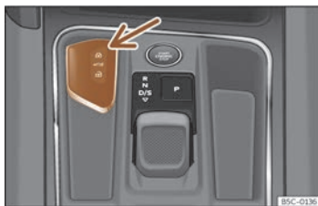
Fig. 68 Console centrale : logement de la clé du véhicule.
