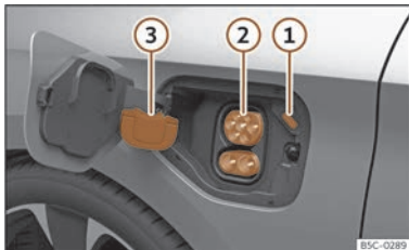
Fig. 62 Derrière la trappe de la prise de charge de la batterie, à l'arrière droit : prise de charge.
