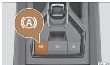
Fig. 157 Dans la partie inférieure de la console centrale : touche de fonction Auto Hold.
