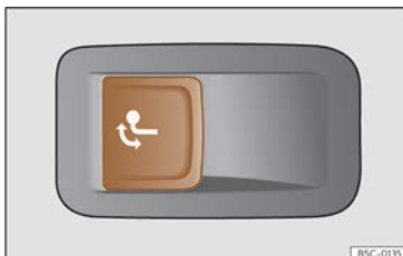
Fig. 209 Sur le côté gauche du coffre à bagages : touche pour déverrouiller le crochet d'attelage.
