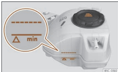
Fig. 238 Dans le compartiment avant : vase d'expansion du liquide de refroidissement.
