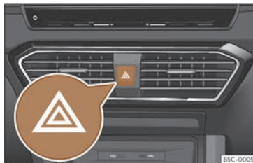
Fig. 50 Combiné d'instruments : interrupteur des feux de détresse.
