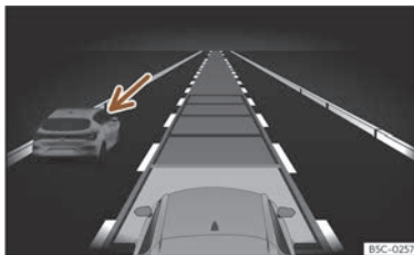
Fig. 142 Sur l'écran du tableau de bord : ACC activé, véhicule circulant à gauche détecté.
