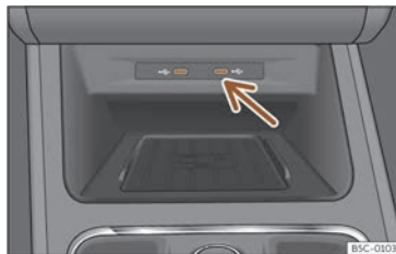
Fig. 175 Console centrale : entrée USB.
