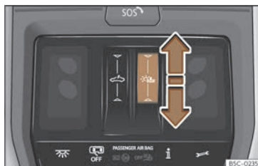
Fig. 91 Sur le revêtement intérieur du toit : commander le store pare-soleil.
