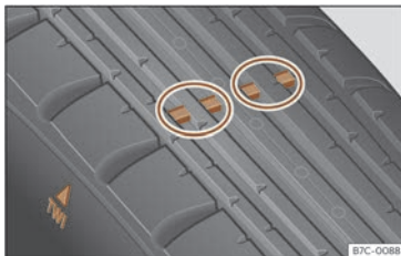
Fig. 251 Sculpture du pneu : indicateurs d'usure.
