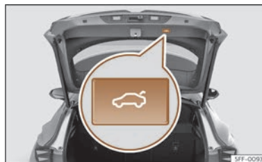
Fig. 84 Hayon arrière : touche de fermeture du hayon.
