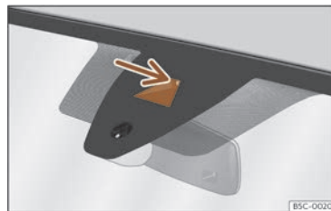
Fig. 133 Sur le pare-brise : aire de champ visuel de l'assistant de maintien de voie.
