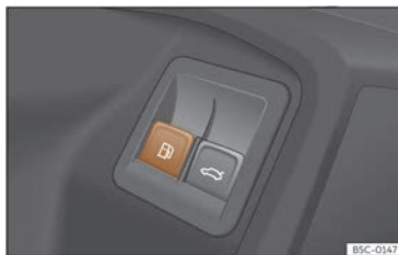
Fig. 215 Porte du conducteur : Déverrouillage de la trappe du réservoir.
