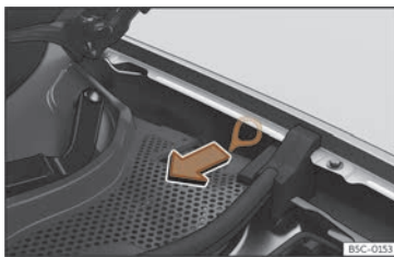
Fig. 65 Entre l'aileron gauche et la charnière du capot du moteur : Poignée de déverrouillage manuel d'urgence du connecteur de charge.
