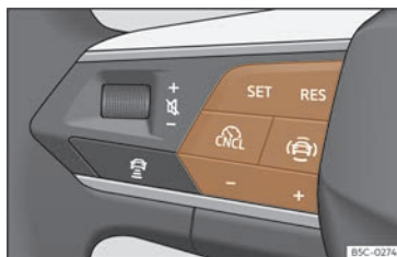
Fig. 138 Sur le volant multifonction : boutons permettant d'actionner le limiteur de vitesse.
