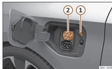
Fig. 60 Derrière le cache de charge de la batterie sur la partie avant gauche : Prise de charge.
