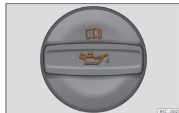
Fig. 246 Dans le compartiment-moteur : couvercle de l'orifice de remplissage d'huile moteur.
