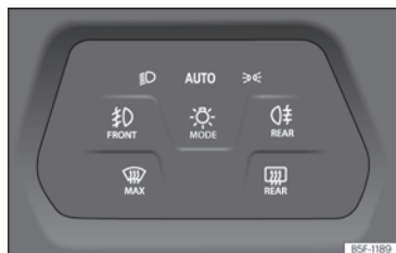
Fig. 107 Combiné d'instruments : commande des feux.
