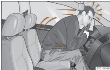
Fig. 20 Le conducteur n'ayant pas bouclé sa ceinture sera projeté en avant.
