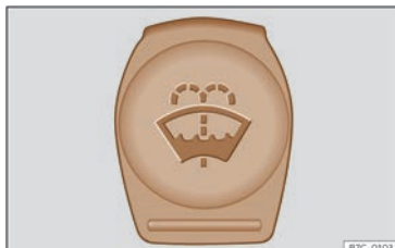
Fig. 241 Dans le compartiment avant : bouchon bleu du réservoir de liquide lave-glace.
