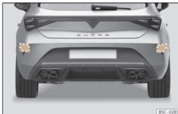
Fig. 134 Vue arrière du véhicule : zones des capteurs radar.
