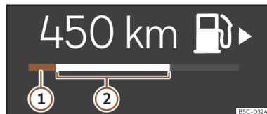
Fig. 3 Indicateur de niveau de carburant détecté dans différentes positions en fonction de la vue.
