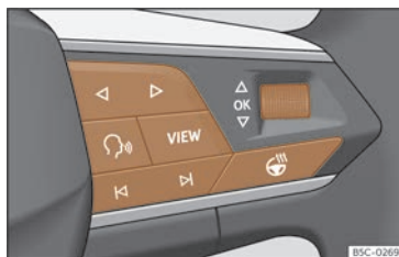
Fig. 10 Côté droit du volant multifonction : touches permettant d'utiliser les menus et les messages d'information du combiné d'instruments (selon les versions).
