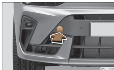
Fig. 226 Du côté droit du pare-chocs avant : retirer le cache.
