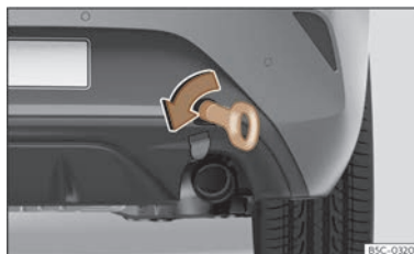
Fig. 231 Leon. Du côté droit du pare-chocs arrière : œillet de remorquage vissé.
