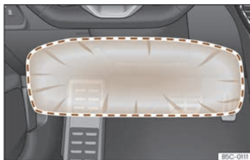
Fig. 36 Du côté conducteur : rayon d'action de l'airbag de genoux.
