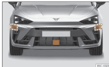
Fig. 131 Dans le pare-chocs avant : capteurs radar avant et latéraux.
