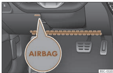
Fig. 35 Du côté conducteur : emplacement de l'airbag de genoux.
