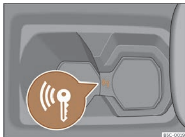
Fig. 122 Dans la console centrale : démarrage d'urgence.
