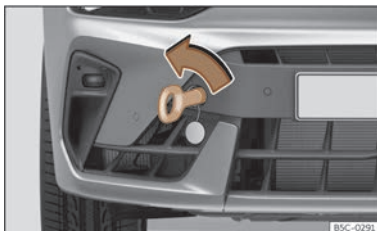
Fig. 227 Partie droite du pare-chocs avant : œillet de remorquage vissé.
