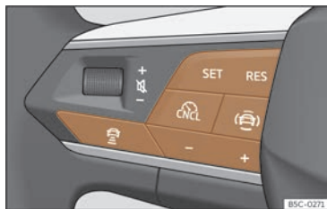
Fig. 141 Sur le volant multifonction : bouton de commande de l'ACC.
