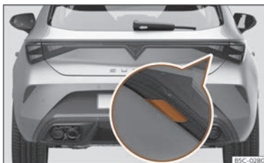
Fig. 82 Hayon arrière : ouverture de l'extérieur.
