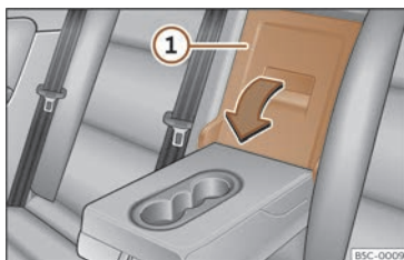
Fig. 204 Dans le dossier de la banquette arrière : ouverture de la trappe de chargement.
