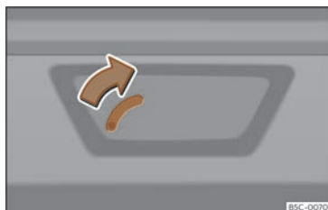
Fig. 87 Détail du coffre à bagages : déverrouillage d'urgence (Leon Sportstourer).
