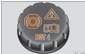
Fig. 240 Compartiment avant : bouchon du réservoir du liquide de frein.
