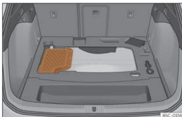
Fig. 247 Véhicules hybrides (PHEV) : emplacement de la batterie dans le coffre à bagages.
