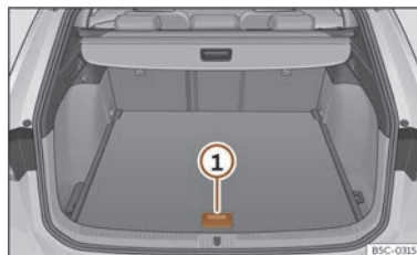
Fig. 192 Plancher modulable du coffre à bagages : position haute.
