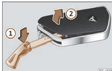
Fig. 73 Clé du véhicule : ouvrir le cache du logement de la pile.
