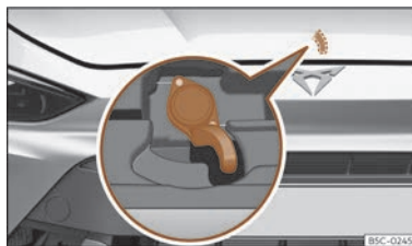
Fig. 236 Levier sous le capot.
