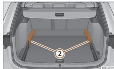
Fig. 193 Plancher modulable du coffre à bagages : position basse.
