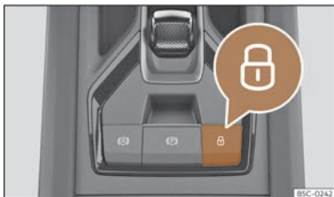
Fig. 78 Sur la console centrale : bouton de verrouillage centralisé
