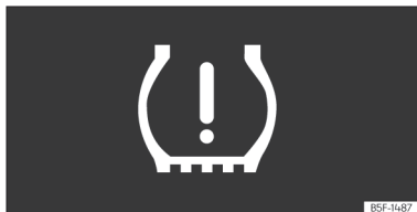
Fig. 260 Combiné d'instruments : avertissement de perte de pression des pneus.
