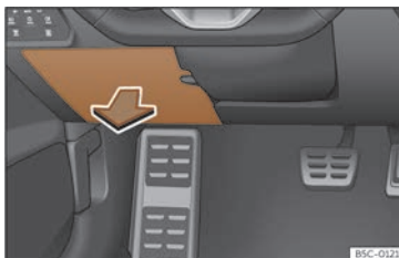
Fig. 232 Sous le combiné d'instruments côté conducteur : couvercle de la boîte à fusibles.
