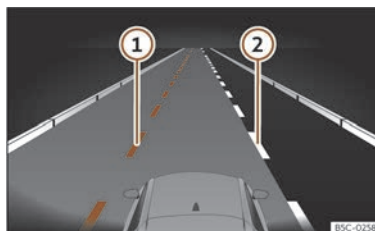
Fig. 148 Sur l'écran du combiné d'instruments : indications de l'assistant de maintien de voie.
