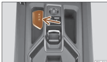
Fig. 71 Console centrale (avec boîte automatique) : logement de la clé du véhicule.
