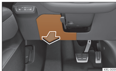
Fig. 190 Sous le combiné d'instruments côté conducteur : couvercle de la boîte à fusibles.
