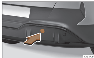
Fig. 188 Du côté droit du pare-chocs arrière : retirer le cache.
