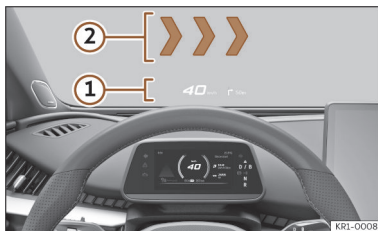
Fig. 5 Dans le champ de vision du conducteur : HUD de proximité ① et HUD RA ②.
