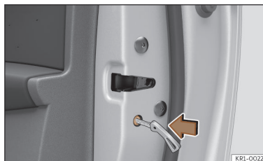
Fig. 75 Verrouillage d'urgence de la porte.
