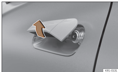
Fig. 72 Ouverture mécanique de la porte.
