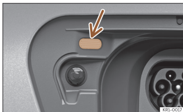
Fig. 59 Sous la trappe de la prise de charge de la batterie : indicateur de la mise en charge.
