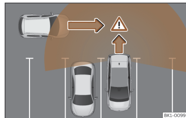
Fig. 151 Représentation schématique de l'assistant de sortie de stationnement : zone surveillée autour du véhicule qui sort du stationnement.
