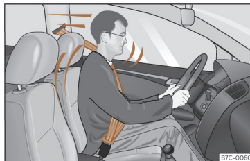
Fig. 17 Les conducteurs qui ont correctement bouclé leur ceinture de sécurité ne seront pas projetés en cas de freinage soudain.
