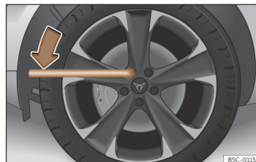
Fig. 205 Changement de roue : desserrer les boulons de la roue.
