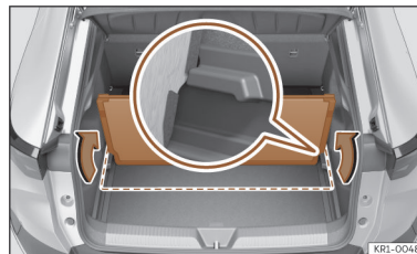
Fig. 169 Dans le coffre à bagages : fixer le deuxième plancher du coffre à bagages.
