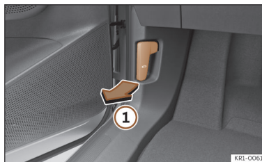
Fig. 194 Levier de déverrouillage sur le plancher, côté conducteur.
