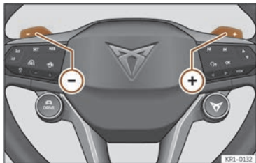
Fig. 110 Volant multifonction : leviers pour la récupération d'énergie.
