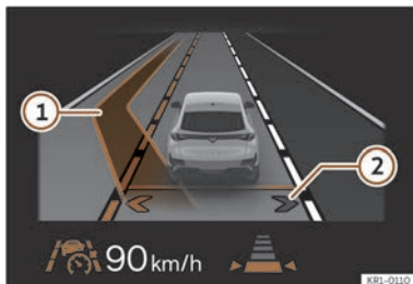
Fig. 132 Sur l'écran du combiné d'instruments : affichage du changement de voie assisté (représentation graphique).
