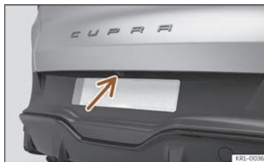
Fig. 117 Sur le pare-chocs arrière : emplacement de la caméra de l'assistant de marche arrière.
