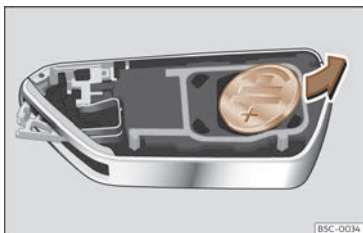
Fig. 67 Clé du véhicule : retirer la pile.
