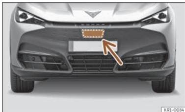
Fig. 112 Dans le pare-chocs avant : capteur radar.
