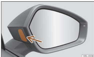
Fig. 134 Témoin de contrôle de l'assistant de changement de voie.
