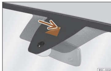
Fig. 114 Sur le pare-brise : aire de champ visuel de l'assistant de maintien de voie.
