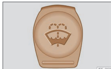
Fig. 200 Dans le compartiment avant : bouchon bleu du réservoir de liquide lave-glace.
