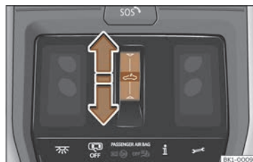
Fig. 101 Sur le revêtement intérieur du toit : bouton de fonction du store pare-soleil.
