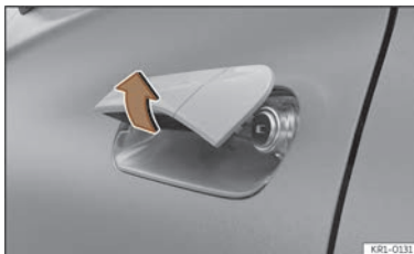
Fig. 72 Ouverture mécanique de la porte.
