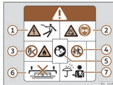
Fig. 52 Étiquette d'avertissement sur la batterie à haute tension.
