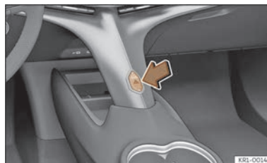
Fig. 45 Console centrale : commande des feux de détresse.
