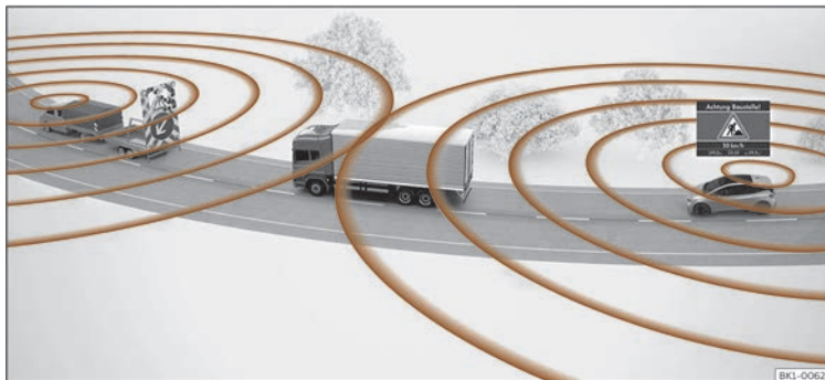
Fig. 157 Représentation graphique : alerte de dangers dus à des travaux de jours ou mobiles.
