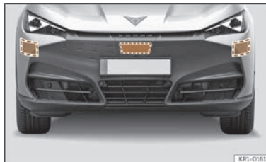
Fig. 116 Dans le pare-chocs avant : capteurs radar avant et latéraux.
