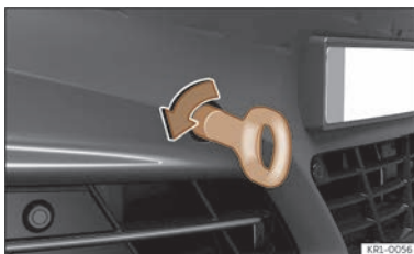
Fig. 197 Partie droite du pare-chocs avant : œillet de remorquage vissé.
