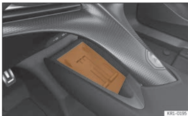
Fig. 168 Sur la console centrale : logement de connexion du téléphone mobile.
