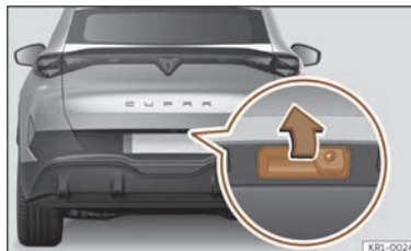
Fig. 79 Hayon arrière : ouverture de l'extérieur.
