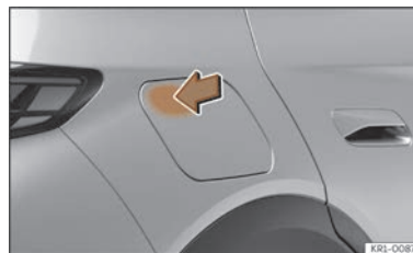
Fig. 57 Ouverture de la trappe de la prise de charge.
