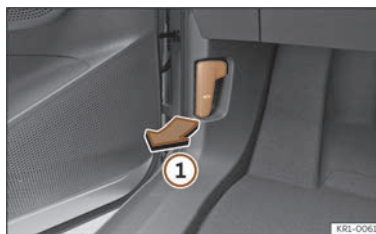
Fig. 204 Levier de déverrouillage sur le plancher, côté conducteur.
