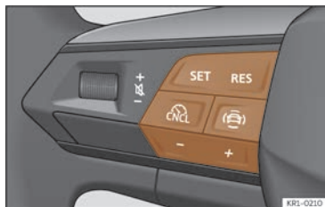
Fig. 122 Sur le volant multifonction : boutons permettant d'actionner le régulateur de vitesse.
