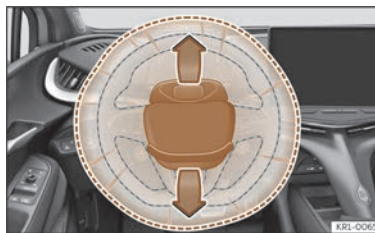
Fig. 27 Airbag du conducteur dans le volant.
