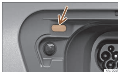
Fig. 61 Sous la trappe de la prise de charge de la batterie : indicateur de l'opération de charge.
