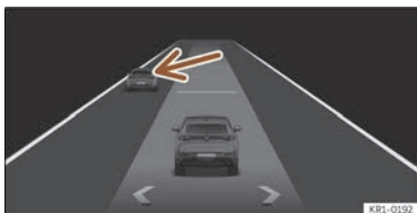
Fig. 127 Sur l'écran du tableau de bord : ACC activé, véhicule circulant à gauche détecté.
