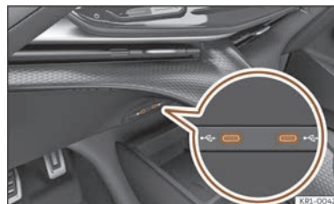
Fig. 162 Dans la console centrale : entrée USB.
