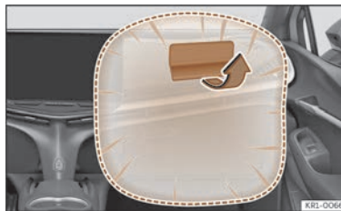
Fig. 28 Airbag du passager avant sur le combiné d'instruments.
