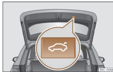
Fig. 81 Hayon arrière : touche de fermeture du hayon.
