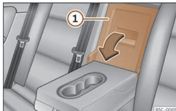
Fig. 179 Dans le dossier de la banquette arrière : ouverture de la trappe de chargement.
