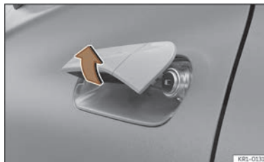
Fig. 74 Ouverture mécanique de la porte.
