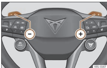
Fig. 111 Volant multifonction : leviers pour la récupération d'énergie.
