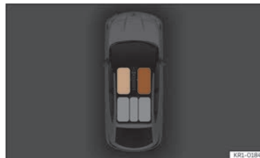
Fig. 19 Tableau de bord : indication de l'état des ceintures de sécurité.
