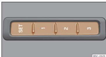
Fig. 93 Sur le côté extérieur du siège conducteur : touches de mémoire.
