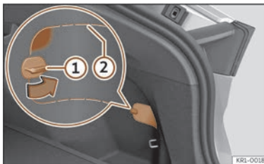
Fig. 63 Sur la partie inférieure droite de la garniture du coffre : cache avec lignes de coupe.
