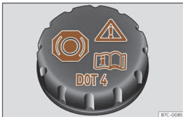
Fig. 208 Compartiment avant : bouchon du réservoir du liquide de frein.
