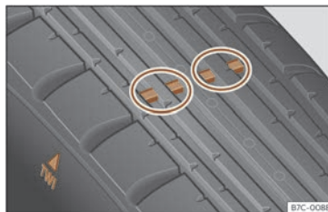
Fig. 211 Sculpture du pneu : indicateurs d'usure.
