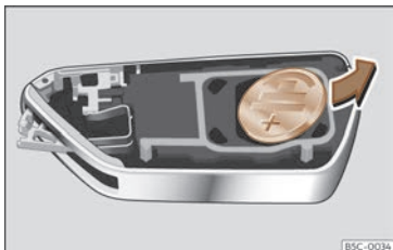
Fig. 69 Clé du véhicule : retirer la pile.
