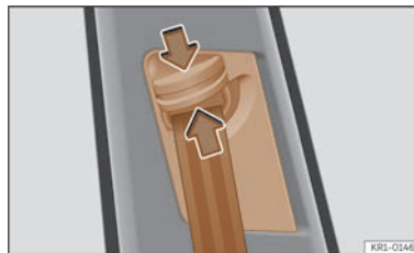
Fig. 26 À côté des sièges avant : dispositif de réglage de la hauteur de la ceinture.
