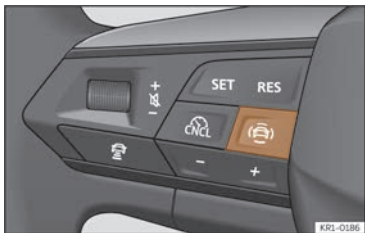
Fig. 115 Côté gauche du volant multifonction : touche pour les systèmes d'aide à la conduite (selon les versions).
