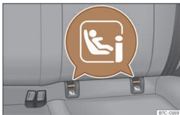
Fig. 39 Siège arrière : emplacement des anneaux de fixation ISOFIX ou i-Size.
