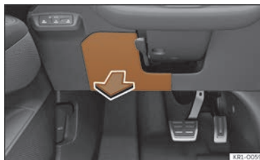
Fig. 200 Sous le combiné d'instruments côté conducteur : couvercle de la boîte à fusibles.
