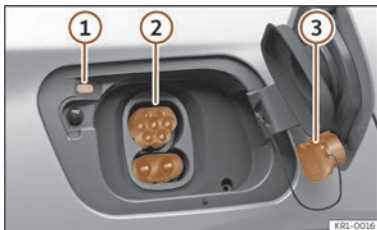
Fig. 60 Derrière la trappe de la prise de charge de la batterie, à l'arrière droit : prise de charge.
