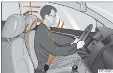
Fig. 18 Les conducteurs qui ont correctement bouclé leur ceinture de sécurité ne seront pas projetés en cas de freinage soudain.
