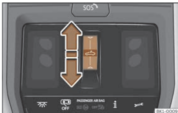
Fig. 104 Sur le revêtement intérieur du toit : bouton de fonction du store pare-soleil.
