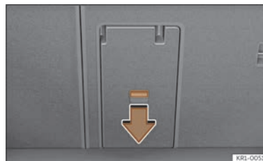
Fig. 180 Dans le coffre à bagages : ouverture de la trappe de chargement.
