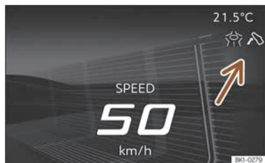
Fig. 124 Indications du système de conduite ECO (représentation schématique).
