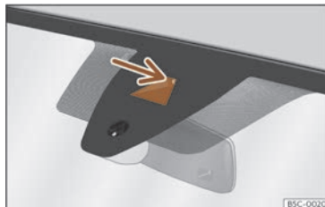
Fig. 118 Sur le pare-brise : aire de champ visuel de l'assistant de maintien de voie.
