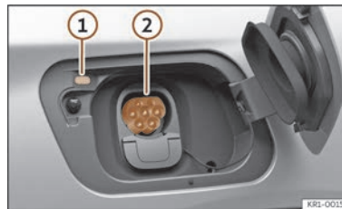
Fig. 58 Derrière le cache de chargement de la batterie sur la partie arrière droite : Prise de charge.
