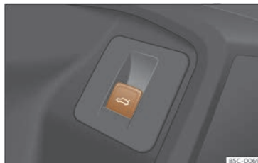
Fig. 80 Sur la porte du conducteur : touche d'ouverture et de fermeture du hayon arrière.
