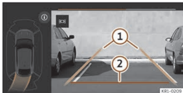
Fig. 153 Sur l'écran du système d'infodivertissement : stationner avec l'assistant de marche arrière.
