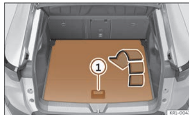
Fig. 175 Dans le coffre à bagages : ouvrez le deuxième plancher du coffre à bagages.
