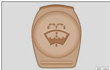
Fig. 209 Dans le compartiment avant : bouchon bleu du réservoir de liquide lave-glace.
