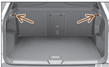
Fig. 178 Dans le coffre à bagages : crochets pour sacs.
