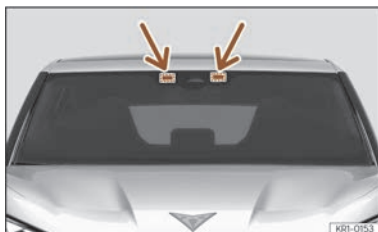
Fig. 110 Zones pour l'emplacement d'accessoires électroniques
