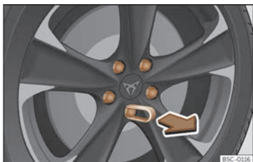
Fig. 213 Roue : boulons de la roue avec capuchons.
