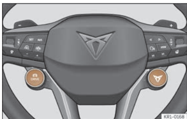
Fig. 114 Volant multifonction : Boutons DRIVE et CUPRA pour sélectionner et changer le profil de conduite.
