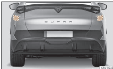
Fig. 119 Vue arrière du véhicule : zones des capteurs radar.
