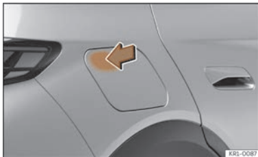
Fig. 59 Ouverture de la trappe de la prise de charge.
