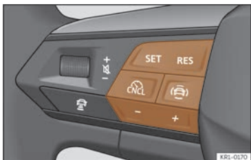
Fig. 123 Sur le volant multifonction : boutons permettant d'actionner le limiteur de vitesse.
