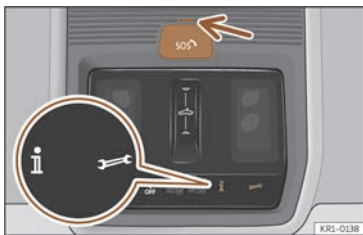
Fig. 49 Sur la console de pavillon : commandes pour les services vocaux.
