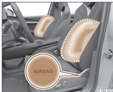
Fig. 33 Airbag latéral sur le siège de conducteur et du passager avant.
