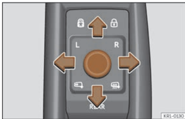
Fig. 102 Détail de la portière du conducteur : commande du rétroviseur extérieur.
