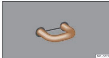
Fig. 177 Dans le coffre à bagages : œillet d'arrimage.
