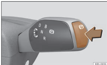
Fig. 142 Sur le sélecteur de vitesses : la touche de frein de stationnement électronique.
