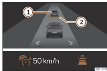
Fig. 125 Sur l'écran du tableau de bord : ACC actif.
