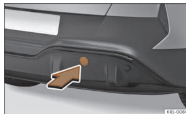
Fig. 198 Du côté droit du pare-chocs arrière : retirer le cache.
