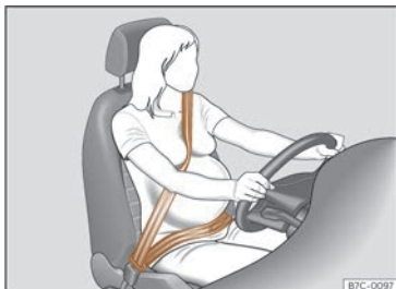
Fig. 25 Ajustement recommandé de la sangle de ceinture de sécurité pour les femmes enceintes.
