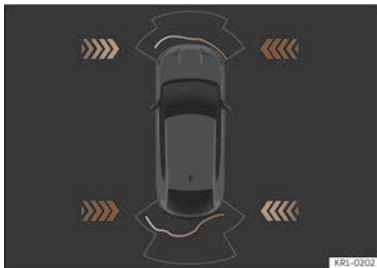
Fig. 132 Sur le système d'infodivertissement : affichage de l'assistant d'intersection.
