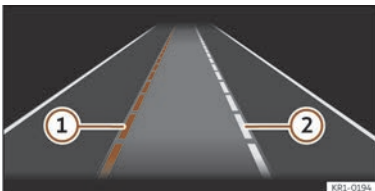
Fig. 133 Sur l'écran du combiné d'instruments : indications de l'assistant de maintien de voie.
