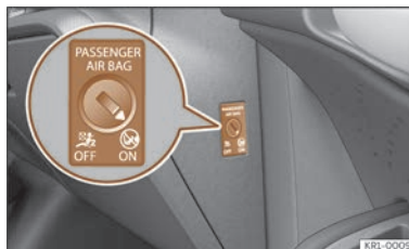
Fig. 29 Commande à clé permettant d'activer et de désactiver l'airbag du passager avant.
