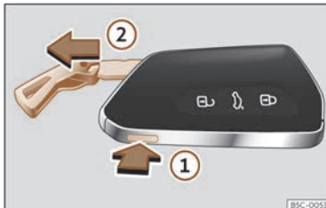
Fig. 67 Clé du véhicule : retirer le panneton.
