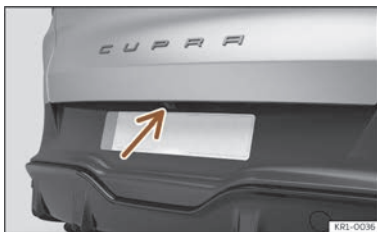
Fig. 121 Sur le pare-chocs arrière : emplacement de la caméra de l'assistant de marche arrière.
