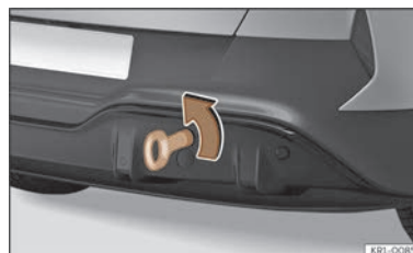
Fig. 199 Du côté droit du pare-chocs arrière : œillet de remorquage vissé.
