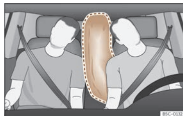
Fig. 32 Airbag central complètement gonflé (zone de déploiement).
