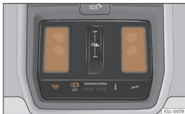
Fig. 98 Détail du revêtement du toit : éclairage avant de l'habitacle.
