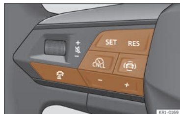
Fig. 126 Sur le volant multifonction : bouton de commande de l'ACC.
