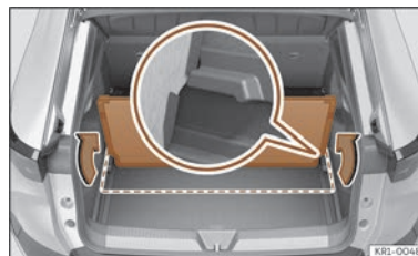
Fig. 176 Dans le coffre à bagages : fixer le deuxième plancher du coffre à bagages.
