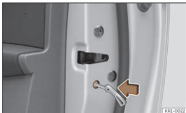
Fig. 77 Verrouillage d'urgence de la porte.
