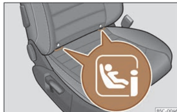
Fig. 40 Siège passager avant : emplacement des anneaux de fixation i-Size.
