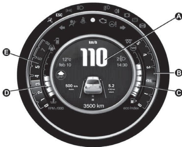
fig. 3 A. Écran en couleurs B. Indicateur numérique « eco Index » C. Indicateur numérique de niveau du carburant D. Indicateur numérique de température du liquide de refroidissement du moteur E. Compte-tours
