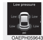
Indicateur de pression basse des pneus à l'écran ACL et indicateur de position
